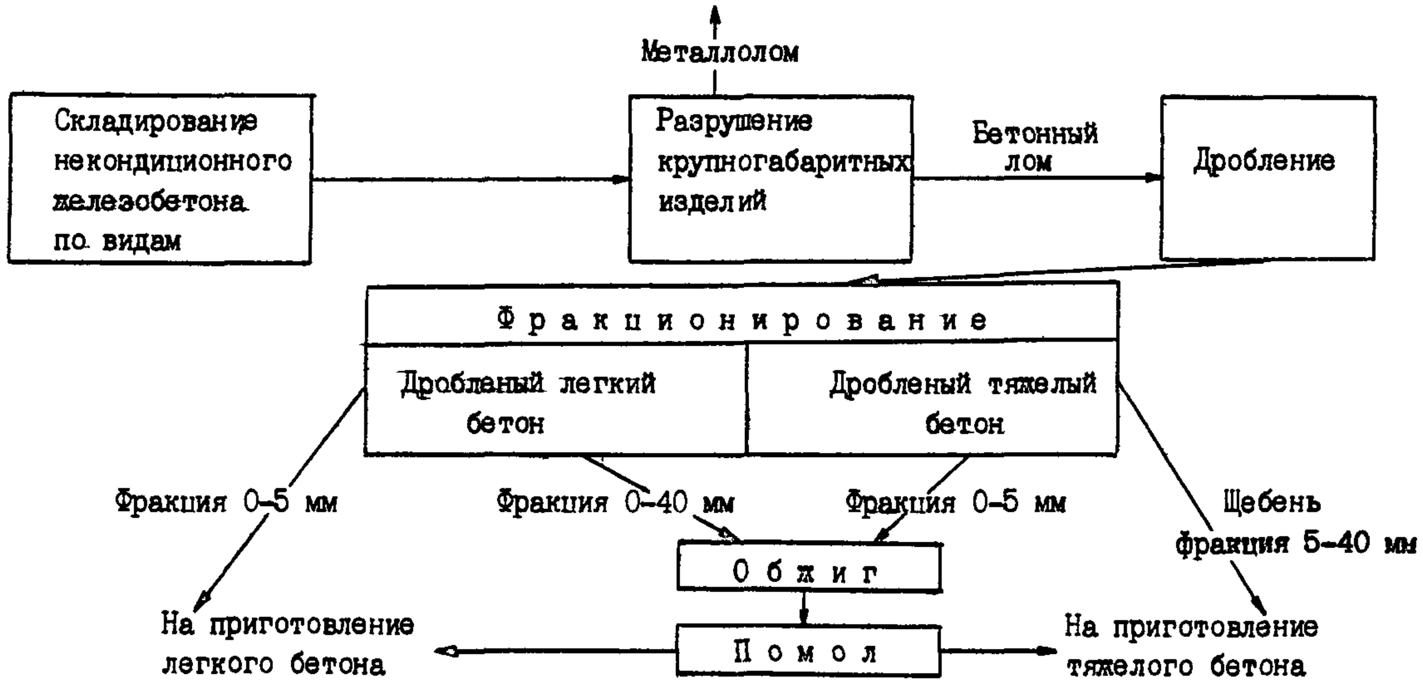
Схема технологической линии по комплексной переработке некондиционного бетона и железобетона с использованием активационных методов
