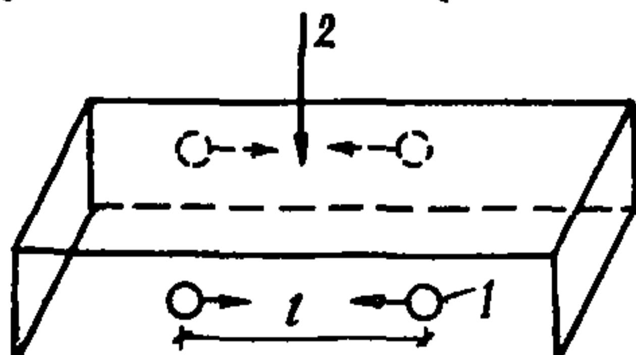
Схема расположения преобразователей при испытании
