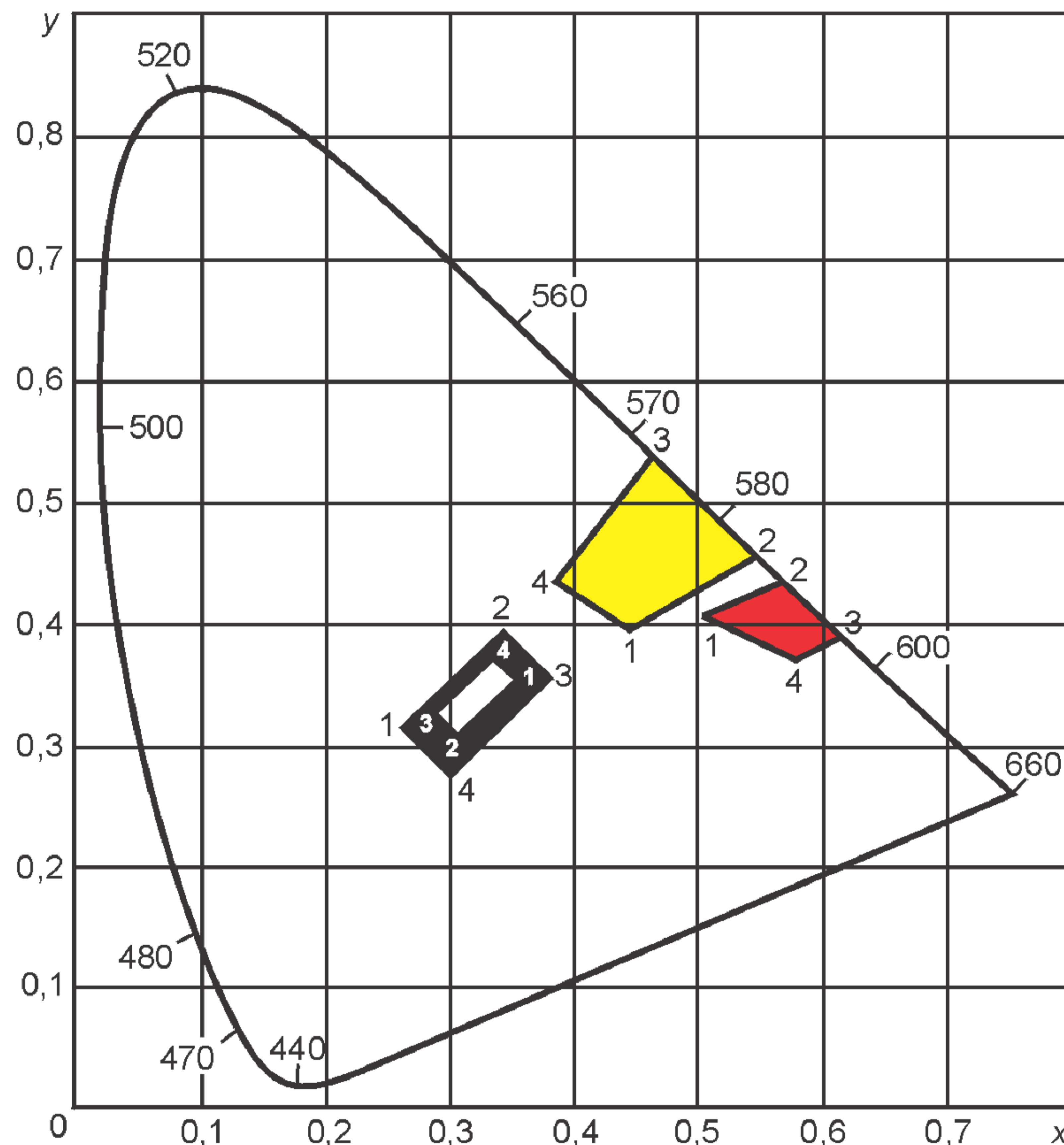
Рисунок В.1 — График цветовых областей для дорожной разметки (МКО, 1931 г. [1])
