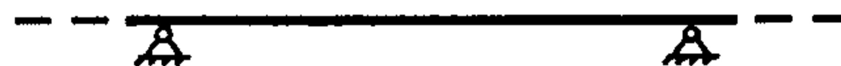
Рисунок 9.1. - Прямолинейный участок, зажатый между двух мертвых или шарнирно-неподвижных опор
