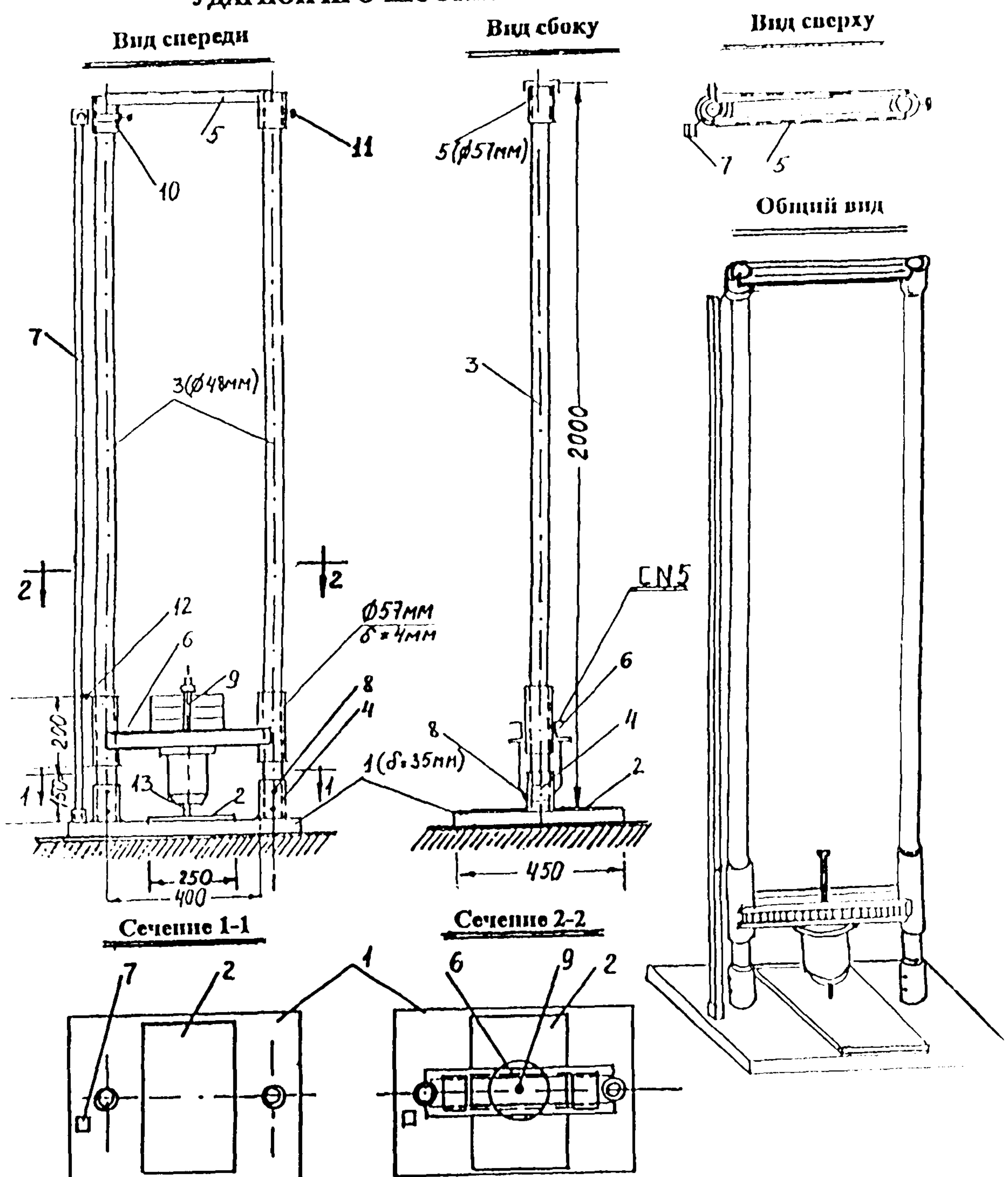
1 – плита основания (600x450), 2 – пластина с изоляционным покрытием (400x250),
