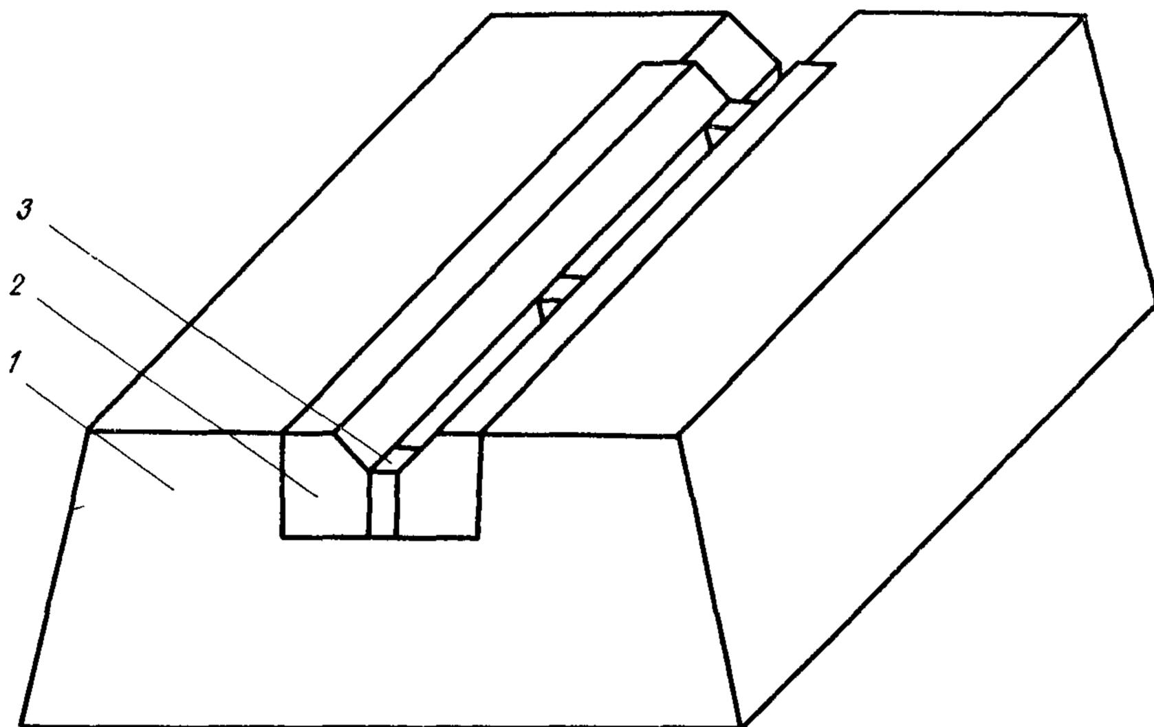
Рис. 2. Электроды машины МСМУ-150 со съемными губками
