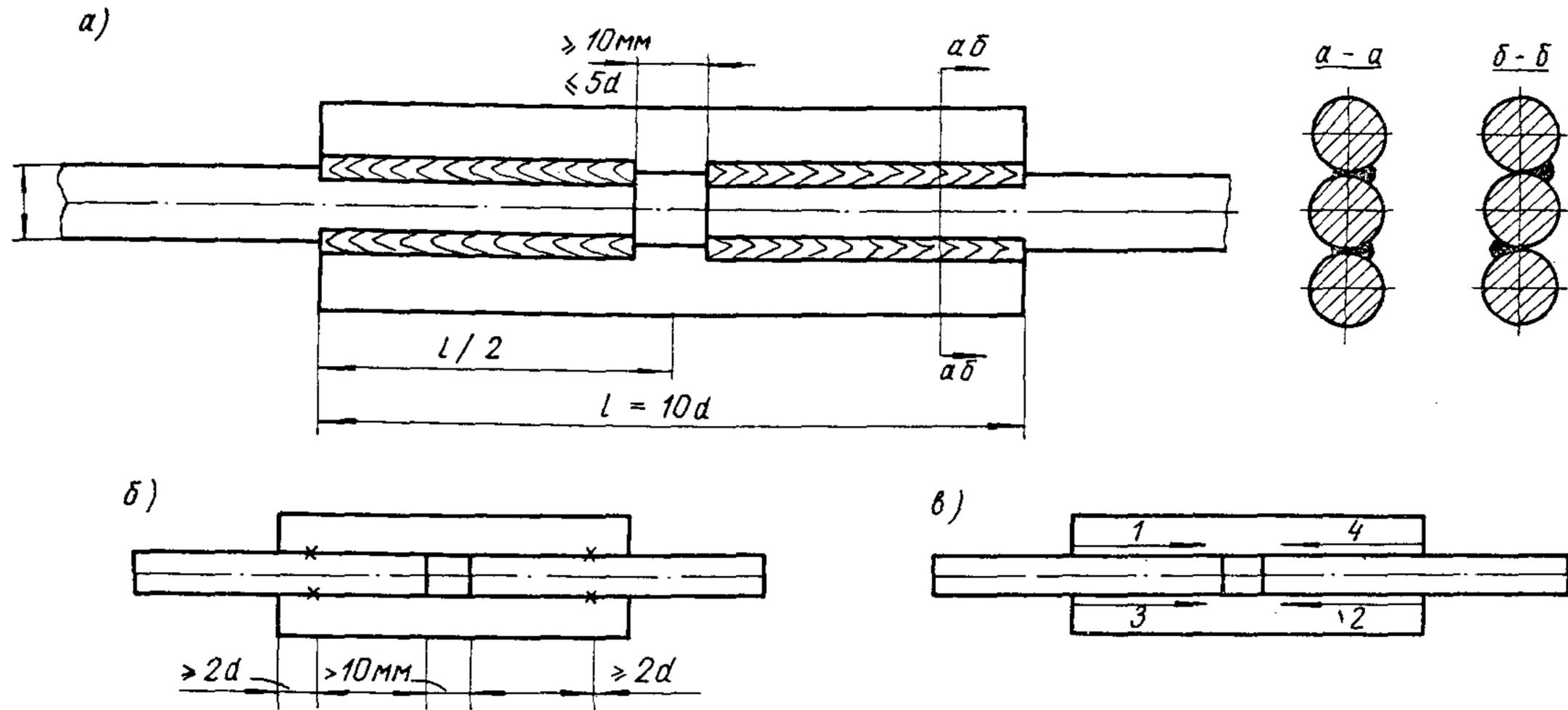
Рис. I. Сварное соединение арматуры Атп, выполняемое дуговой электросваркой
