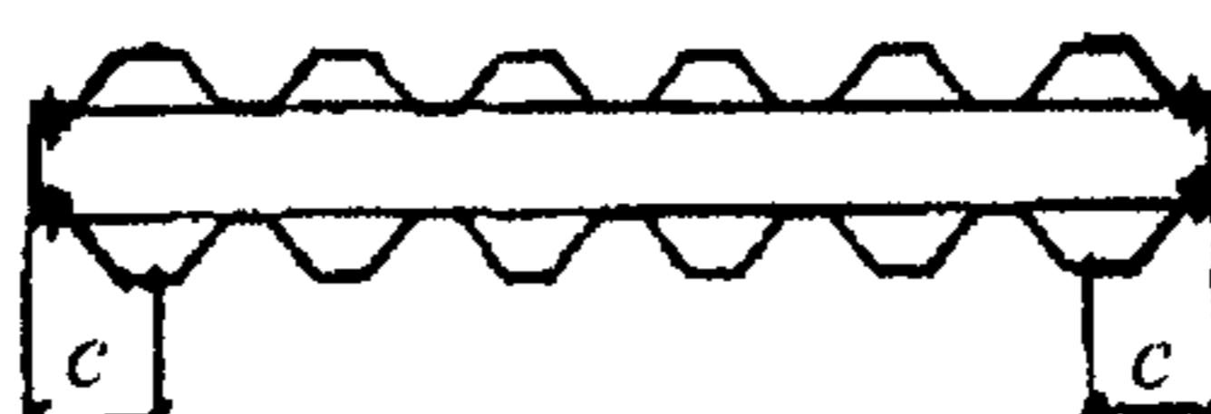
Рисунок 16 – Сечение трехслойной панели
