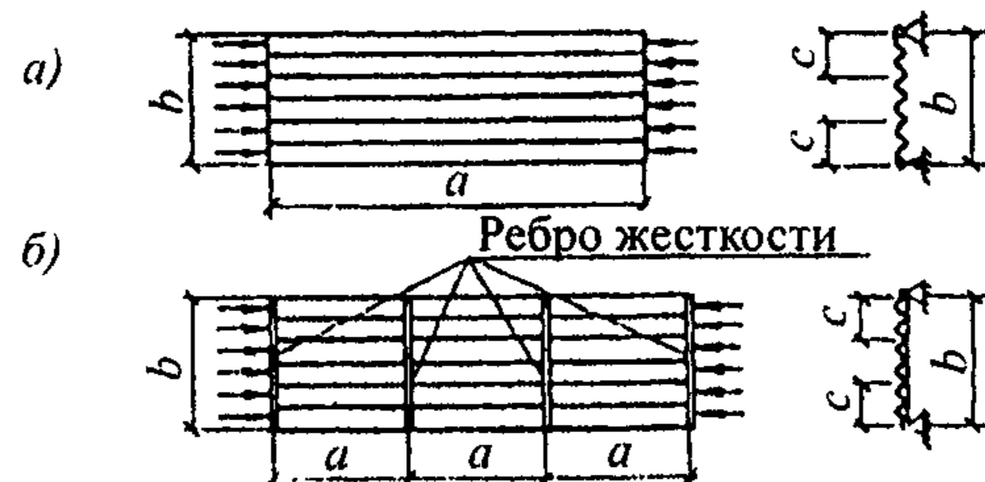
*a* – без поперечных ребер жесткости; *б* – с поперечными ребрами жесткости
