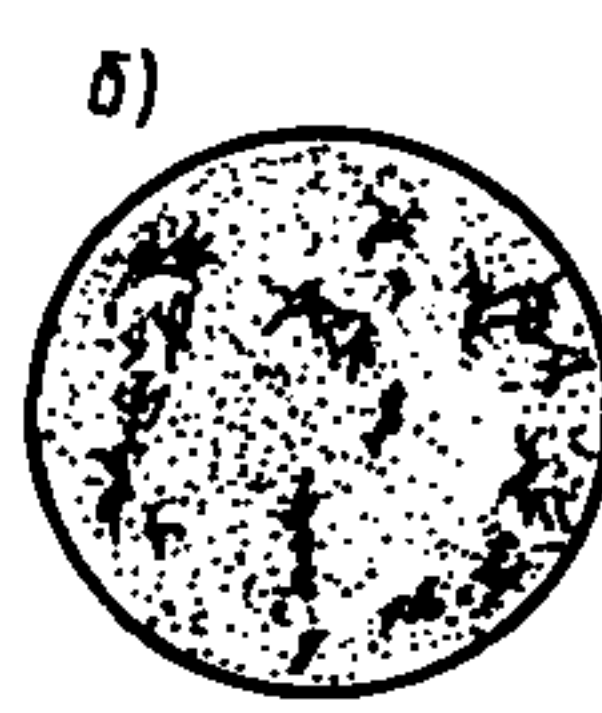
Рис. 20. Тонкоизмельченные образцы при плохом (а) и хорошем (б) смешивании
