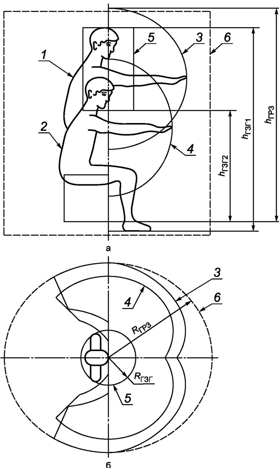
1 — тело оператора в положении «стоя»; 2 — тело оператора в положении «сидя»; 3, 4 — границы зоны досягаемости моторного поля; 5 — ГЗГ; 6 — ГРЗ
