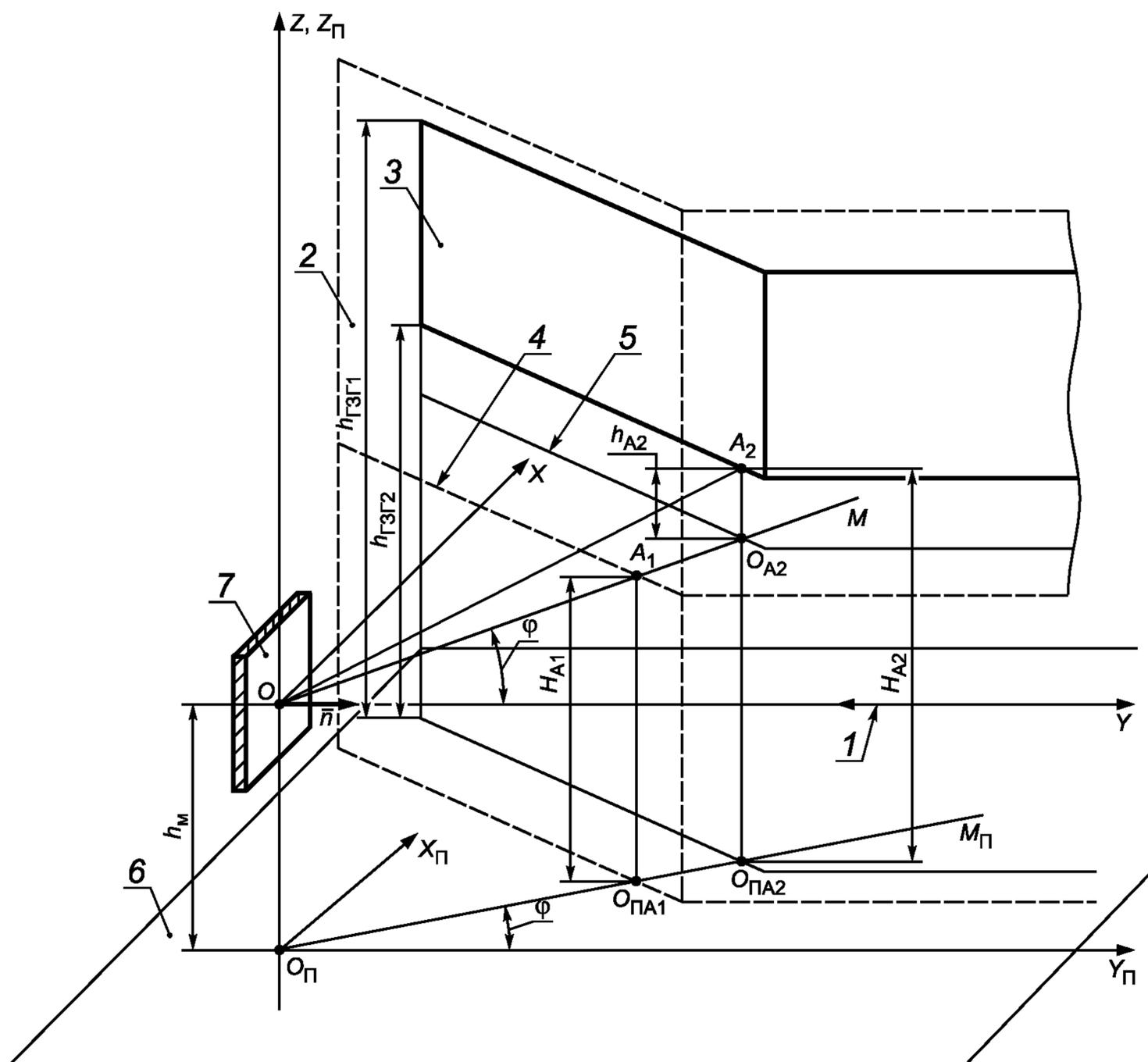
1 — ось горизонтально падающего лазерного пучка; 2 — ГРЗ; 3 — ГЗГ; 4 — линия проекции ГРЗ на плоскость мишени; 5 — линия проекции ГЗГ на плоскость мишени; 6 — плоскость пола; 7 — диффузно отражающая поверхность мишени
