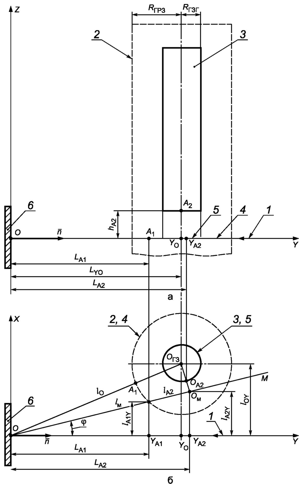
1 — ось горизонтально падающего лазерного пучка; 2 — ГРЗ; 3 — ГЗГ; 4 — контур проекции ГРЗ на плоскость мишени;
