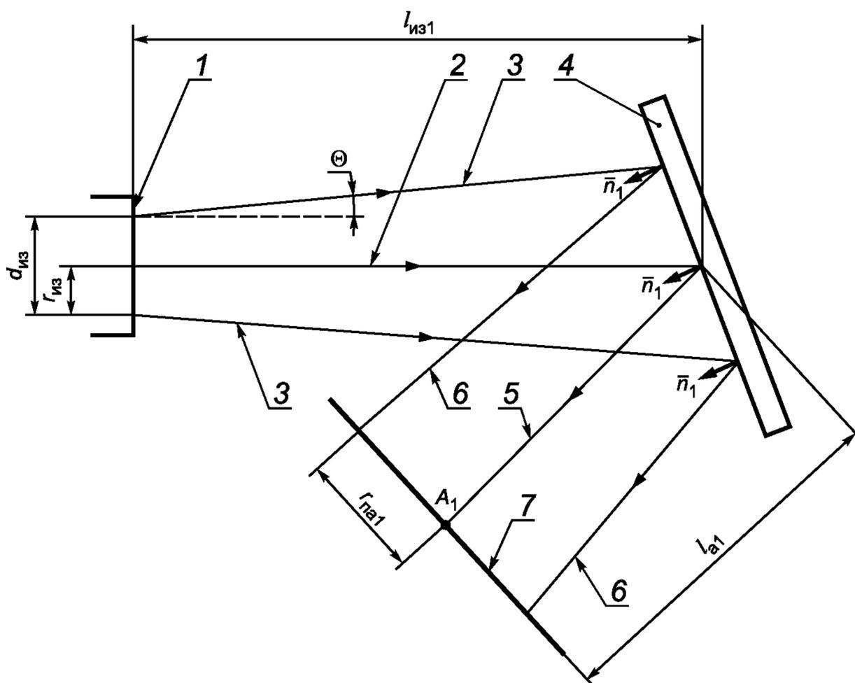
1 — выходное окно излучателя лазерной установки; 2 — ось лазерного пучка; 3 — боковые лучи лазерного пучка; 4 — стеклянная пластина; 5 — ось зеркально отраженного лазерного пучка; 6 — боковые лучи зеркально отраженного лазерного пучка; 7 — плоскость сечения, проходящая через контрольную точку  $A_1$ ;  $\vec{n}_1$  — нормаль к зеркально отражающей поверхности стеклянной пластины
