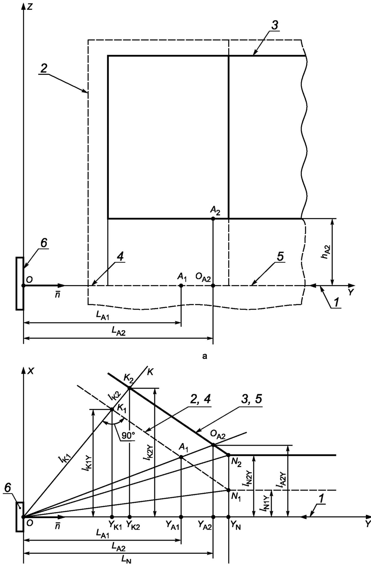
1 — ось горизонтально падающего лазерного пучка; 2 — ГРЗ; 3 — ГЗГ; 4 — линия проекции ГРЗ на плоскость мишени;
