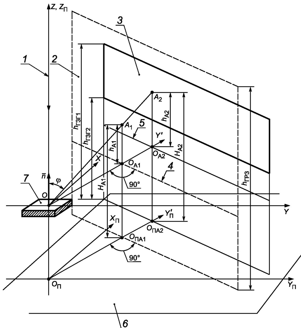
1 — ось вертикально падающего лазерного пучка; 2 — ГРЗ; 3 — ГЗГ; 4 — линия проекции ГРЗ на плоскость мишени; 5 — линия проекции ГЗГ на плоскость мишени; 6 — плоскость пола; 7 — диффузно отражающая поверхность мишени
