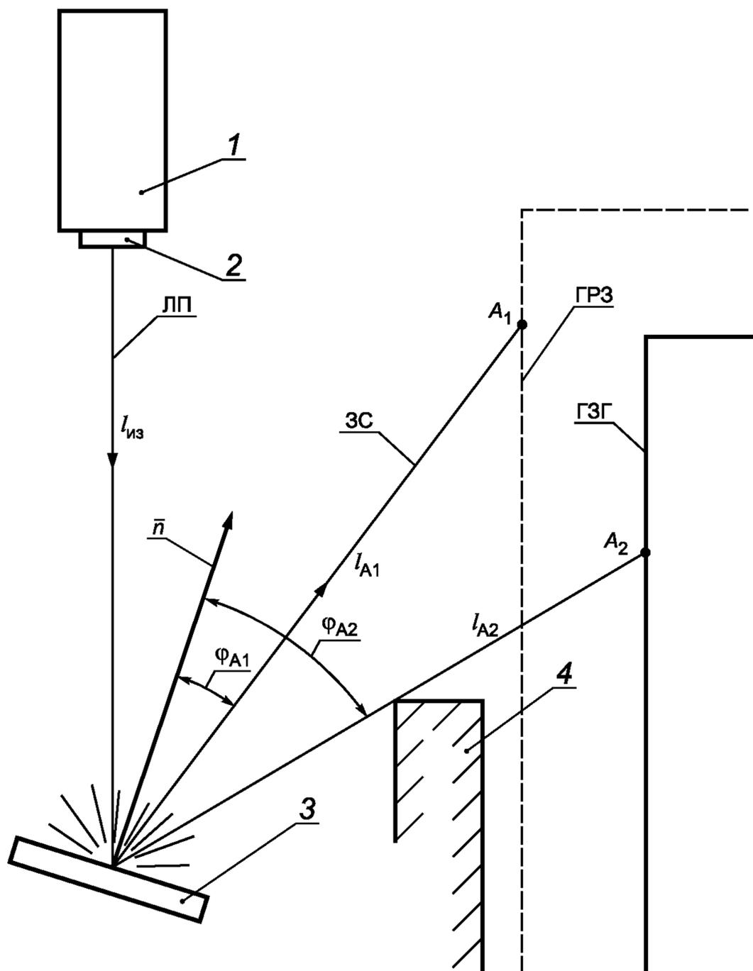
1 — излучатель ЛУ; 2 — выходное окно излучателя; 3 — диффузно отражающая металлическая поверхность; ЛП — ось лазерного пучка; ЗС — ось зеркальной составляющей диффузно отраженного лазерного излучения;  $\vec{n}$  — нормаль к диффузно отражающей поверхности; 4 — непрозрачный экран; ГРЗ — граница рабочей зоны; ГЗГ — граница зоны возможного повреждения глаз оператора;  $A_1$ ,  $A_2$  — точки контроля
