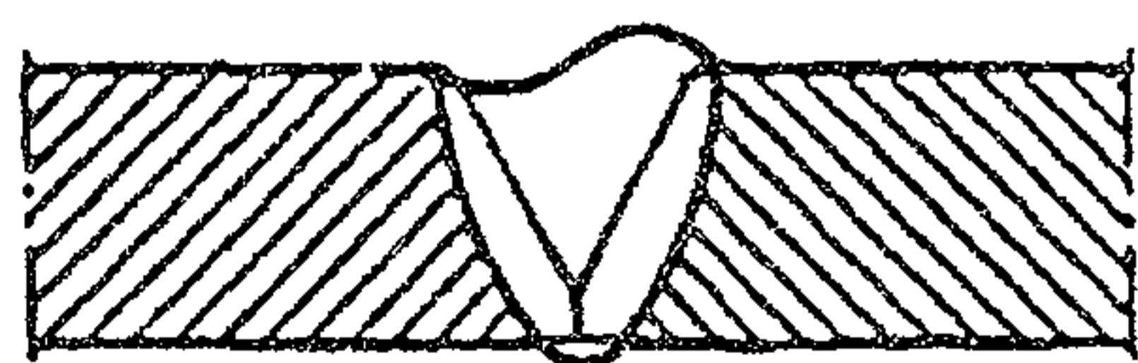
Рисунок П16.47 Не полностью заполненная разделка кромок
