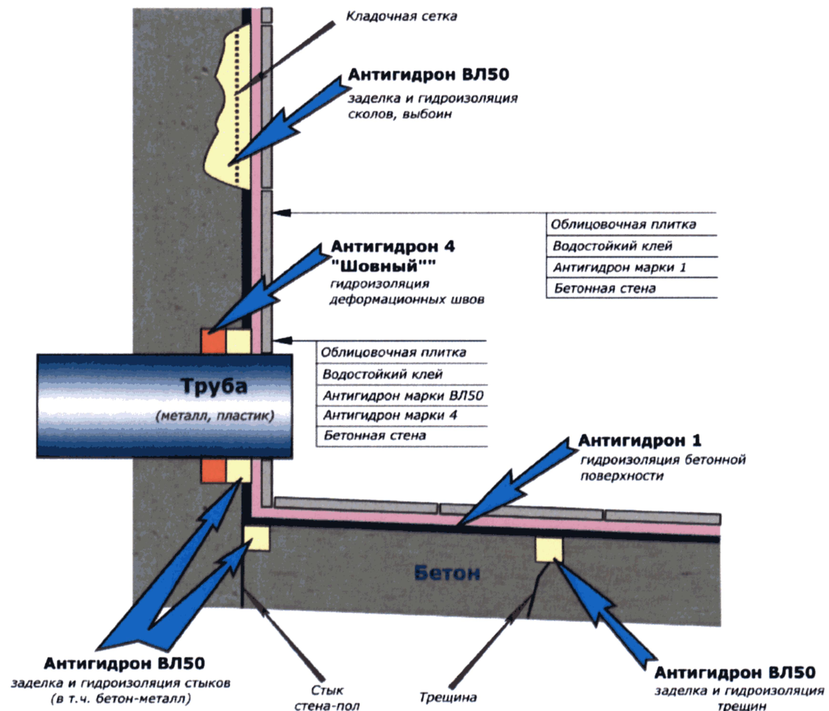
**Технология гидроизоляции резервуаров и конструкций, облицованных плиткой (бассейнов, фонтанов, душевых кабин, ванн градирен, хранилищ агрессивных жидкых продуктов и др.), состоит из следующих этапов:**
