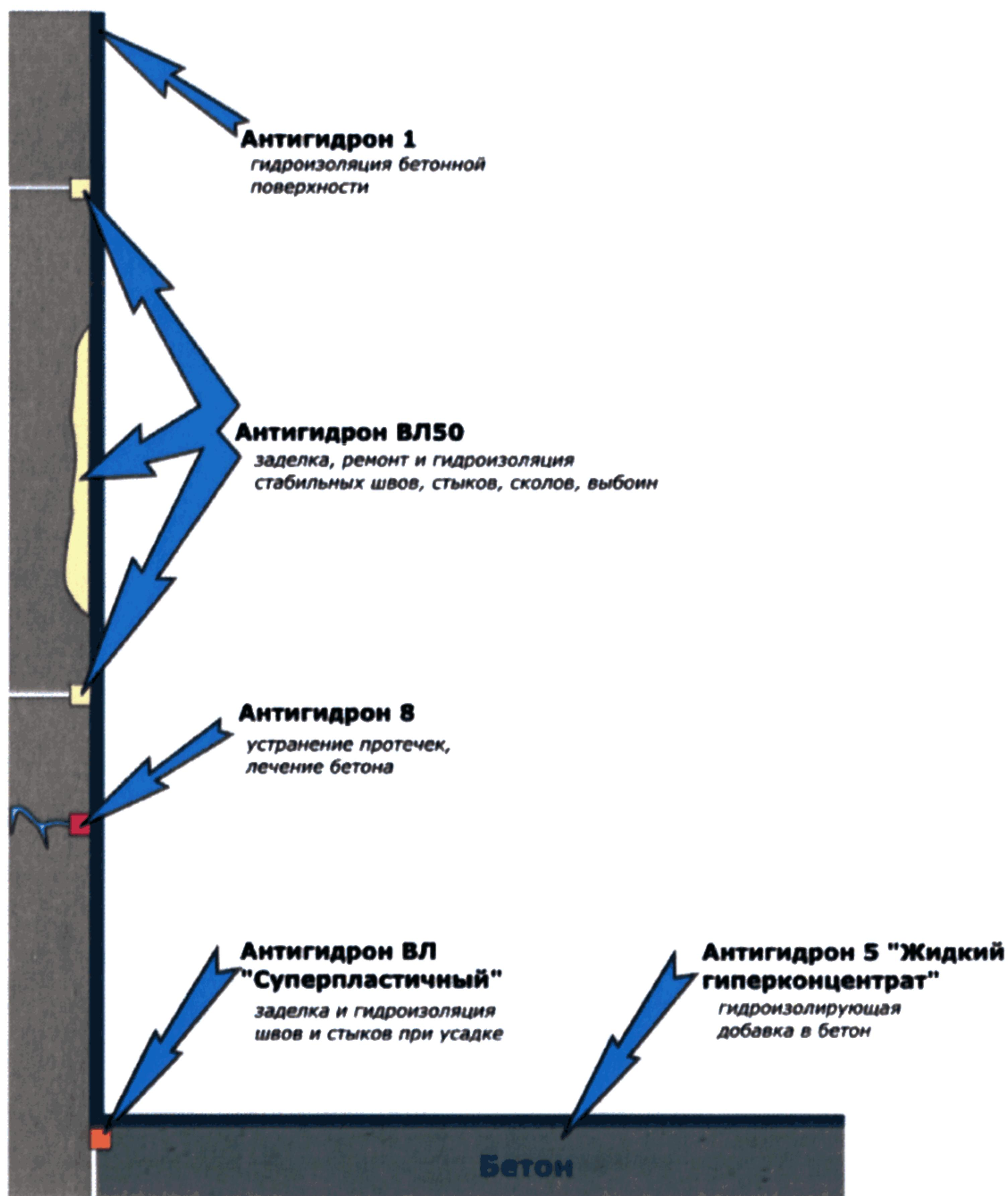
*Технология ремонта и гидроизоляции существующих бетонных, кирпичных, каменных колодцев и выгребных ям, а также бетонных водоводов, каналов, арыков, приямков, водоприемных камер состоит из следующих этапов:*
