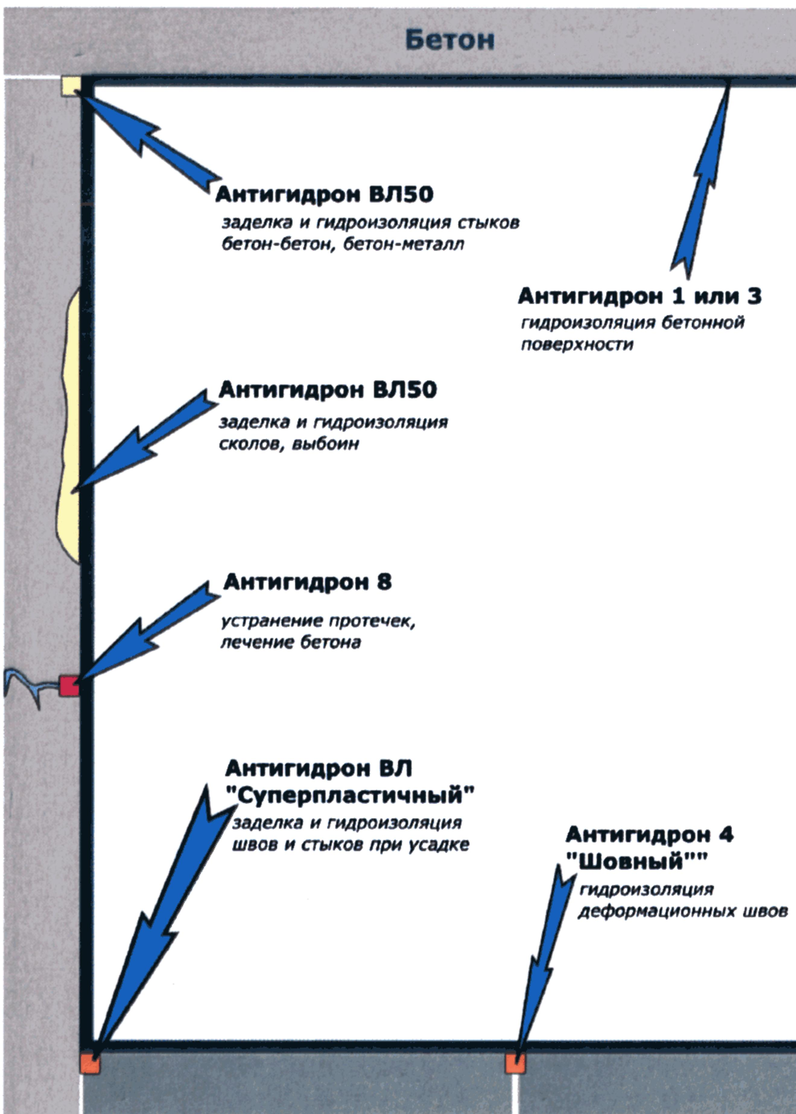
**Технология ремонта, гидроизоляции и защиты заглубленных и подземных сооружений состоит из следующих этапов:**
