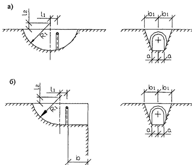
а – замкнутое углубление; б – разомкнутое углубление; размеры, мм, при диаметре стержня петли от 6 до 16 мм:  $R_1 = 125$ ,  $a = 30$ ,  $b_1 = 50$ ,  $l_1 = 25$ ,  $l_2 = 30$ ; при диаметре стержня петли от 18 до 22 мм:  $R_1 = 150$ ,  $a = 40$ ,  $b_1 = 65$ ,  $l_1 = 30$ ,  $l_2 = 30$
