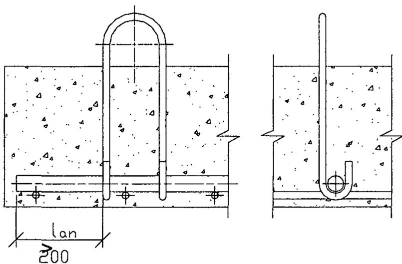
**Рисунок 3 – Схема заведения крюков петли за рабочую арматуру плиты**
