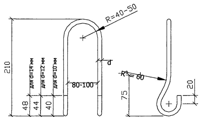
**Рисунок 4 – Конструкция строповочной петли с подгибом ветвей и крюками, заводимыми за рабочую арматуру, для многопустотных плит перекрытий**
