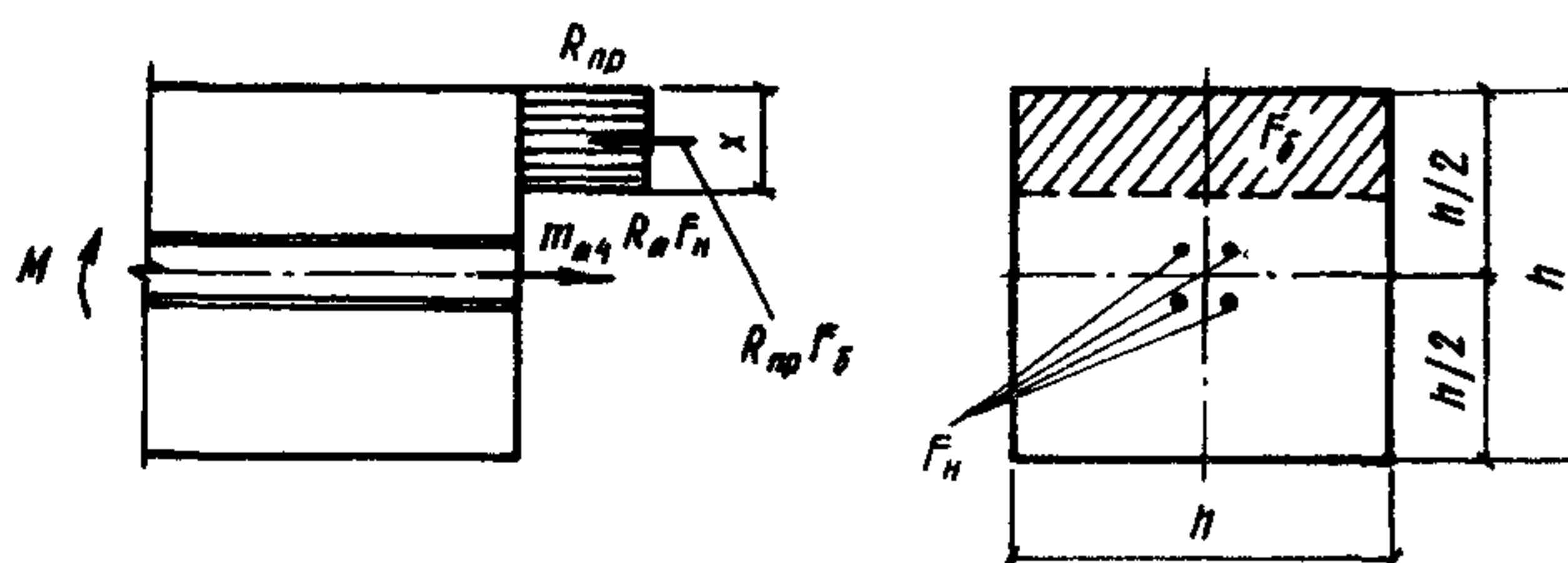
Рис. I. Схема усилий и эпюра напряжений в сечении, нормальном к продольной оси изгибающей железобетонной сваи, при расчете ее по прочности
