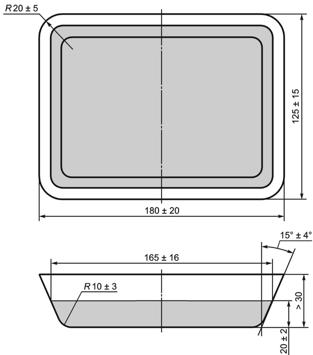
Примечание — Блюдо изготовлено из проницаемого для микроволн материала с тонкими стенками.
