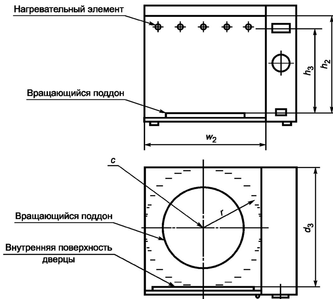
$c$  — центр вращения вращающегося поддона;  $h_2$  — общая высота шкафа;  $h_3$  — полезная высота шкафа;  $w_2$  — полезная ширина шкафа;  $d_3$  — полезная глубина шкафа;  $r$  — расстояние от  $c$  до ближайшей стенки
