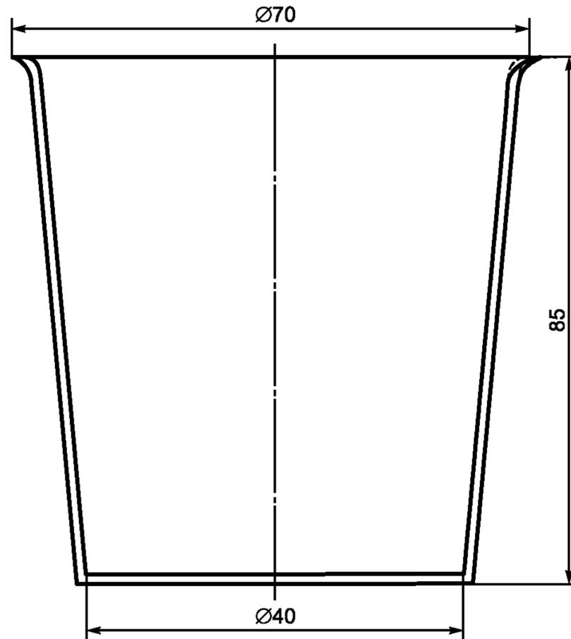
Примечание — Чаша изготовлена из проницаемого для микроволн материала с тонкими стенками и имеет круглое поперечное сечение.
