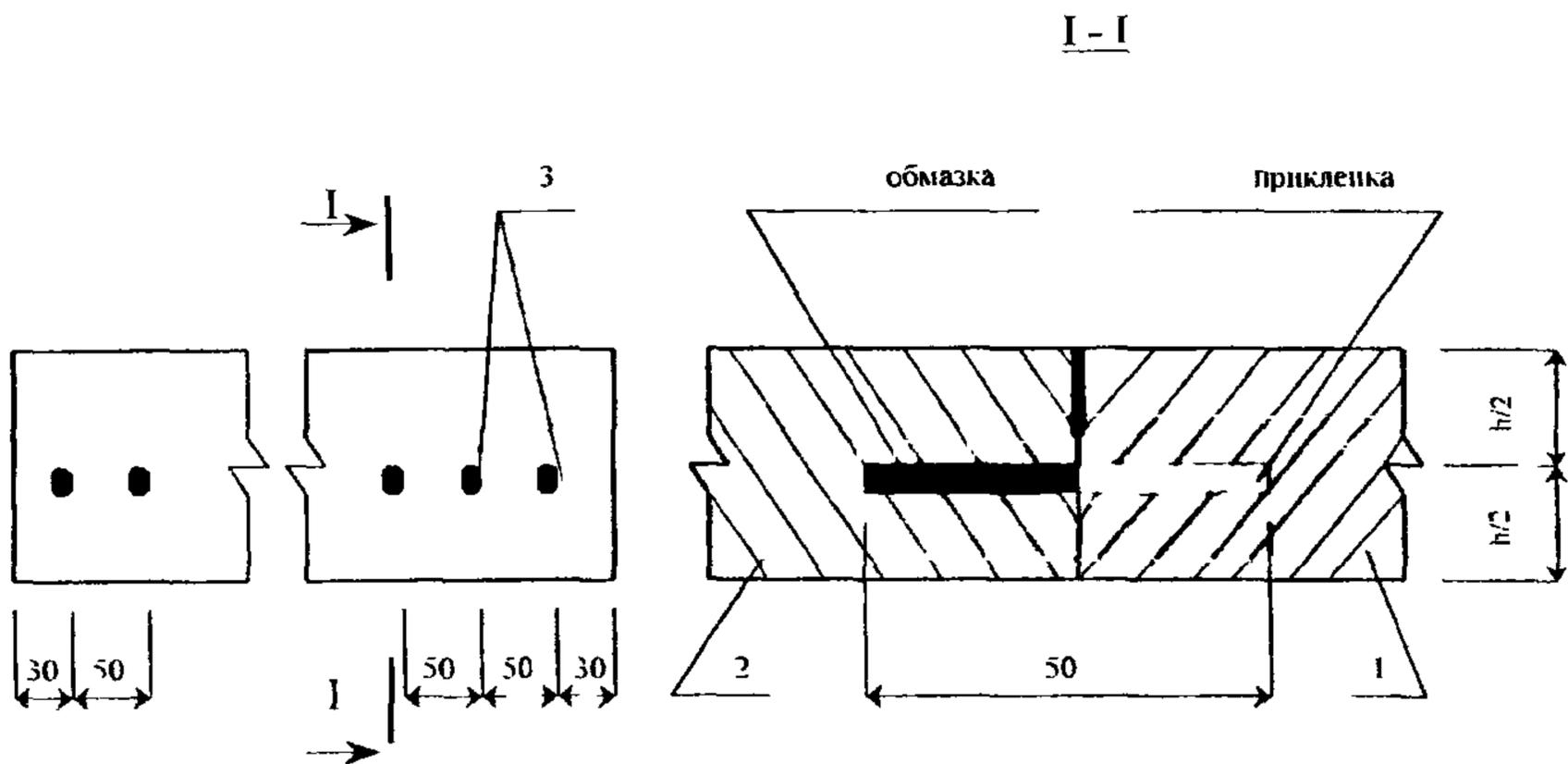
Рисунок 2 – Схема устройства штыревых соединений:
