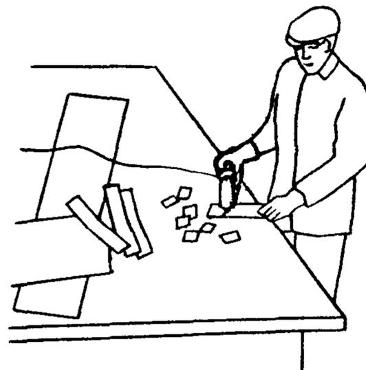
2 ИЗГОТОВЛЕНИЕ ШАЙБ ИЗ РУБЕРОИДА; 0,5 мин; К<sub>2</sub>; пробойник, молоток, подкладка
