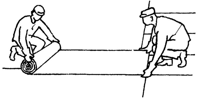
Кровельщики  $K_1$  и  $K_2$ , перемещая влево или вправо концы полотнища, устанавливают с помощью метра необходимую величину нахлестки продольной кромки
