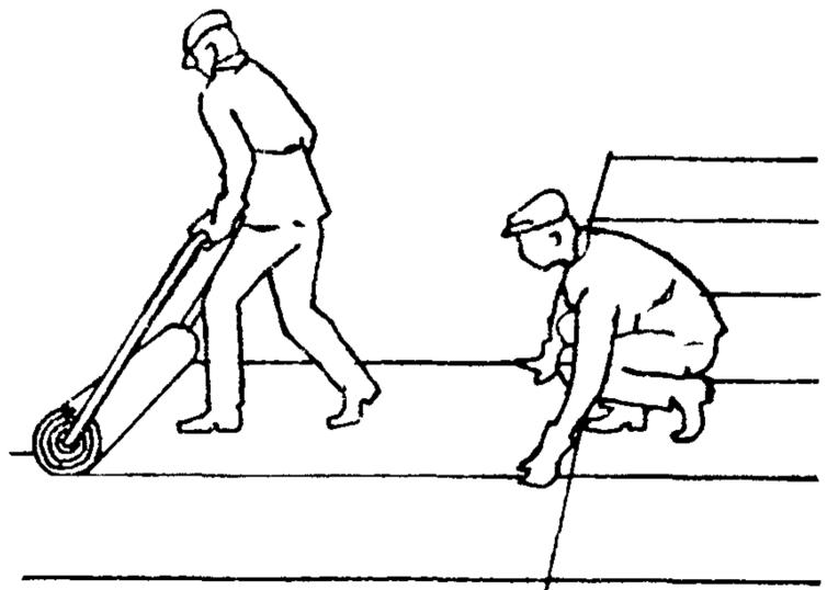
Кровельщик  $K_1$  придерживает руками конец рулона, а кровельщик  $K_2$  раскатывает его до половины длины полотнища
