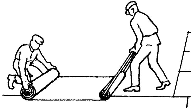
Кровельщик  $K_2$  придерживает рулон в зафиксированном положении, а кровельщик  $K_1$  производит обратное скатывание полотнища
