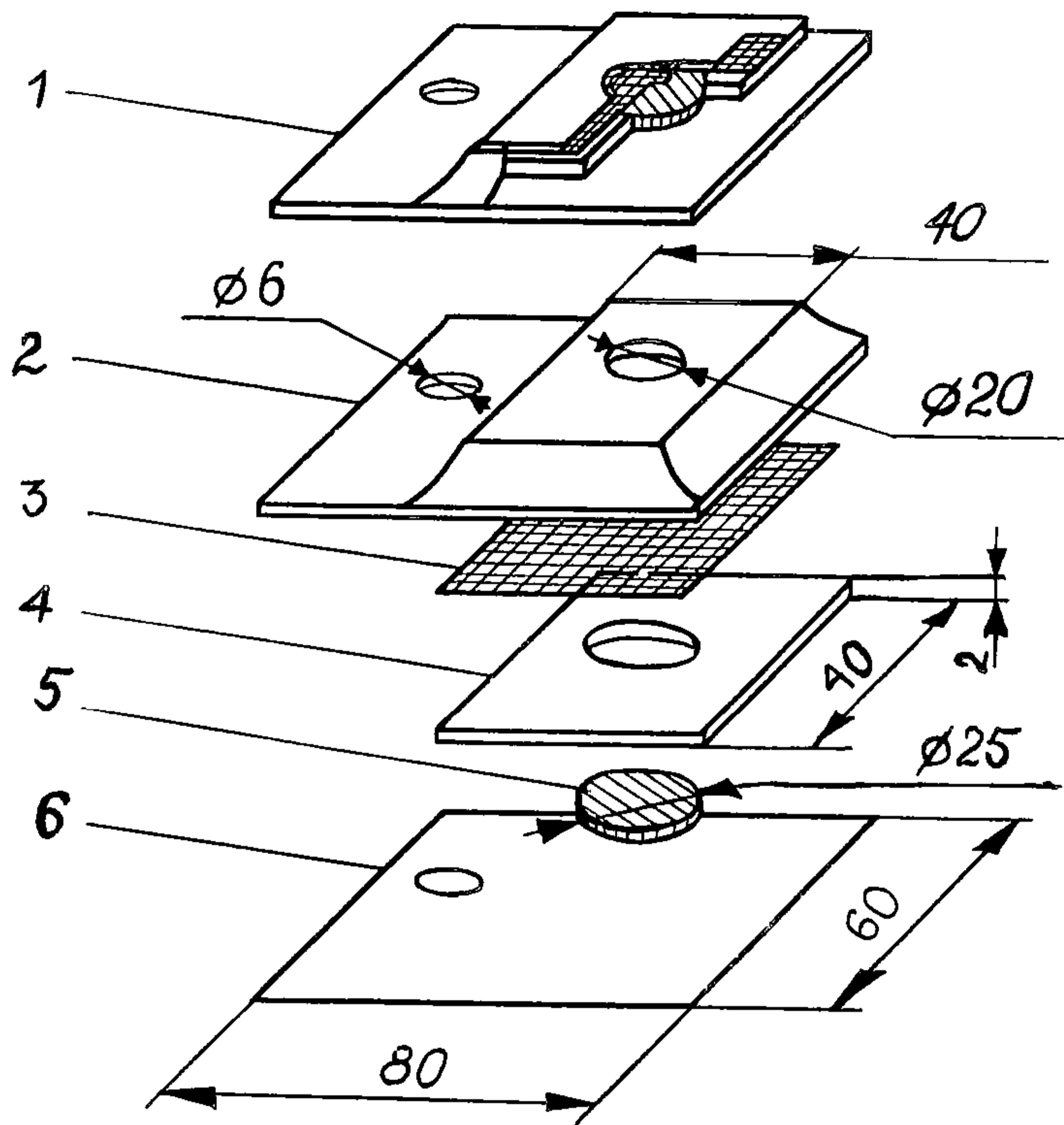
**Рис. 1. Пассивный дозиметр ПД-1**
