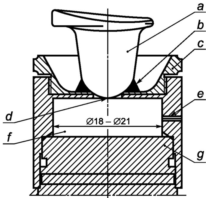
*a* — слуховой аппарат внутриушного типа (ITE); *b* — герметизирующее уплотнение; *c* — держатель эквивалента ушного вкладыша ITE слухового аппарата; *d* — оконечность слухового аппарата должна быть расположена на одном уровне со стенкой полости; *e* — отверстие для выравнивания статического давления; *f* — полость эталонной камеры эффективным объемом  $(2 \pm 0,07)$  см<sup>3</sup>; *g* — микрофон, калиброванный по давлению
