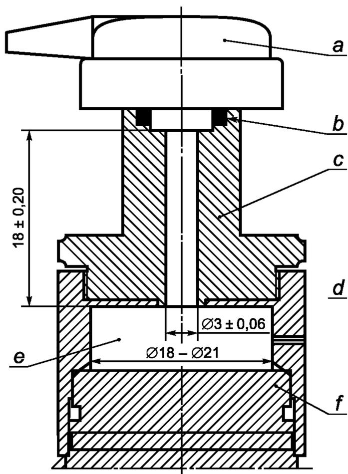
*a* — телефон с ушным вкладышем; *b* — герметизирующее уплотнение; *c* — эквивалент ушного вкладыша телефона; *d* — отверстие для выравнивания статического давления; *e* — полость эталонной камеры эффективным объемом  $(2 \pm 0,07)$  см<sup>3</sup>; *f* — микрофон, калиброванный по давлению
