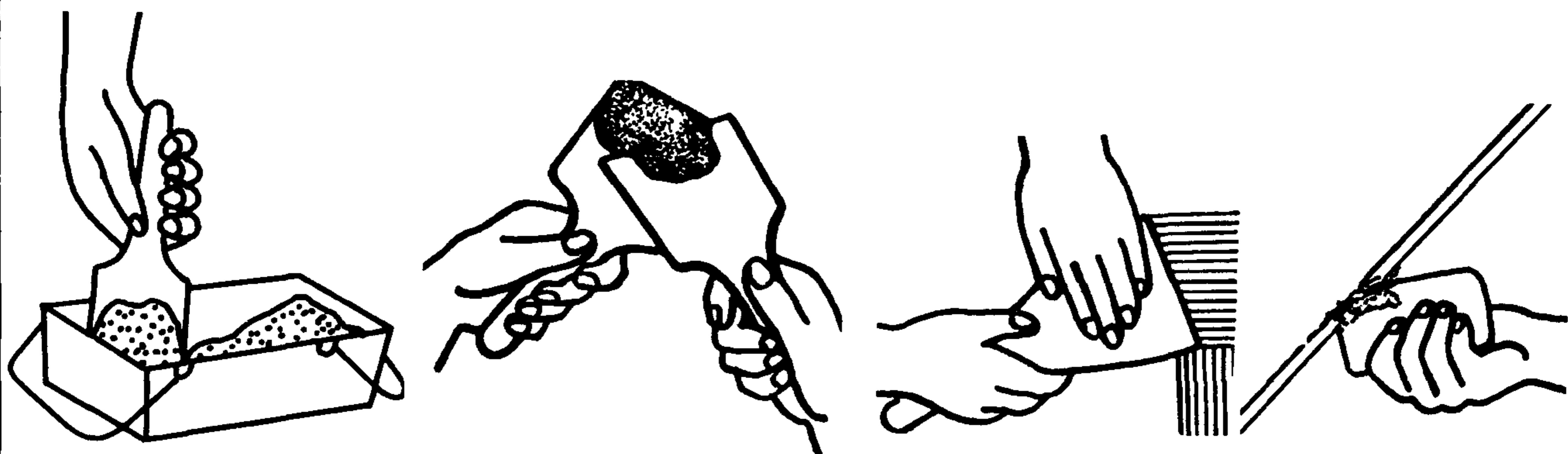
Маляры  $M_1$  и  $M_2$  работают самостоятельно. Маляр устанавливает столик-подмости, ставит на него ящик со шпаклевкой, а затем поднимается на столик и набирает деревянным шпателем из ящика небольшое количество шпаклевки. Далее стальным шпателем он снимает с деревянного нужное количество шпаклевки, заполняет ею раковины, выбоины, трещины и сглаживает шпаклевку. После этого закругленным углом резиновой пластиинки маляр очищает русты от шпаклевки
