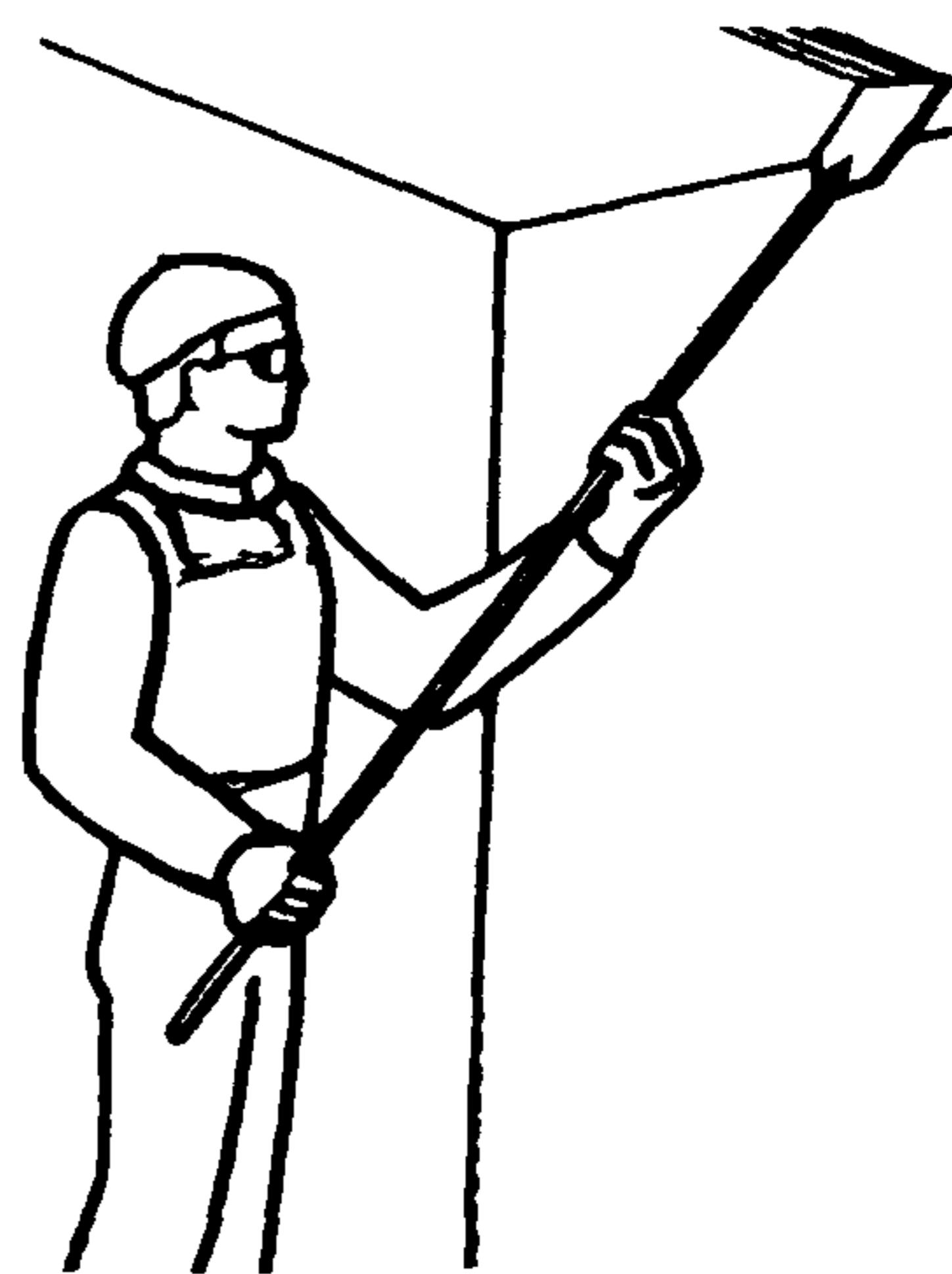
2 ШПАКЛЕВКА ОТДЕЛЬНЫХ МЕСТ; 80 мин;  $M_1$ ,  $M_2$ ; шпатели, ящики, столики-подмости, резиновые пластиинки
