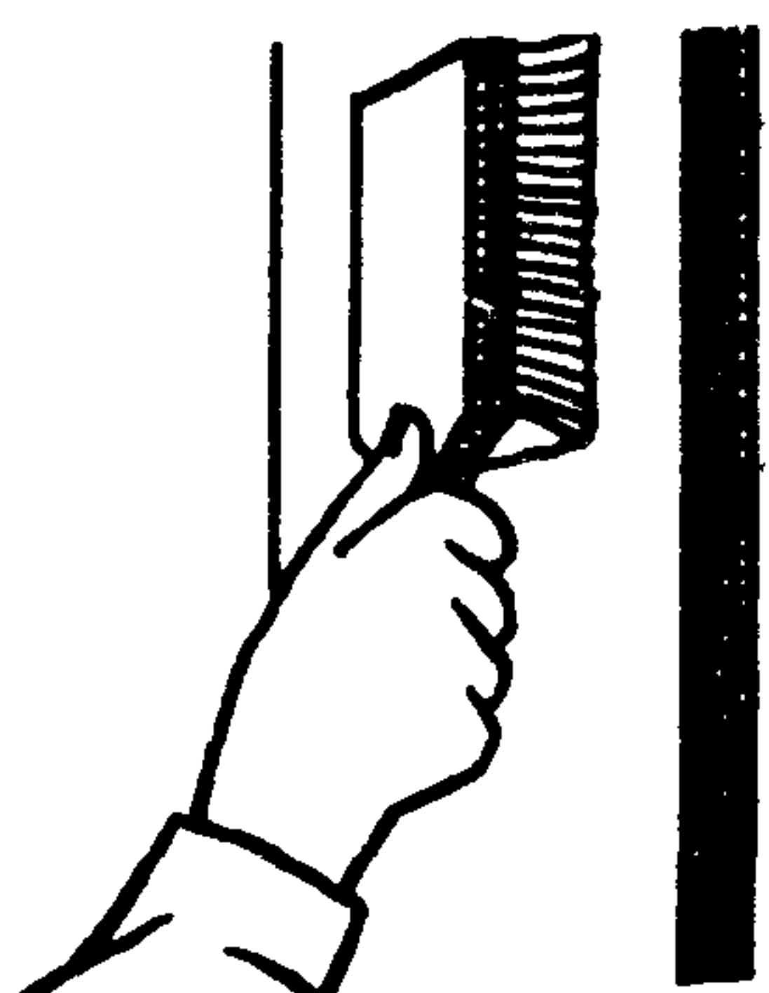
Маляр сухой щеткой-торцовкой наносит легкие удары по свежескращенной поверхности, по одному разу в одно место, так чтобы следы ударов лишь немногого перекрывали ранее отторцованные участки
