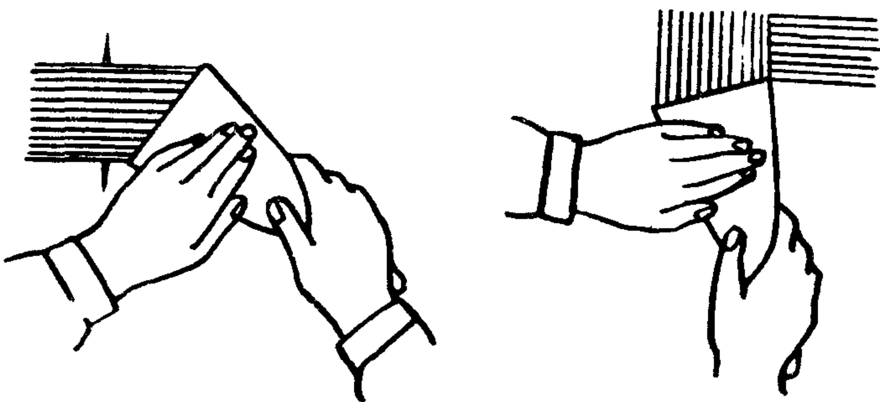
Шлифовку выполняют пемзой или шкуркой до сглаживания поверхности и полного удаления шероховатостей и наплыпов. Маляр производит шлифовку круговыми движениями обоймы или колодки. Профилированные поверхности он шлифует шкуркой без колодки
