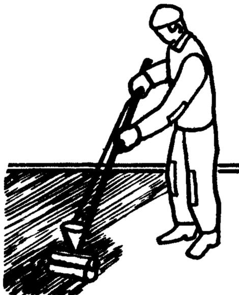
Каждый из маляров берет правой рукой ручку-держатель валика, нажимает на рычаг клапана и передвигает валик вперед и назад, покрывая лаком всю поверхность пола. Подачу лака на валик маляры регулируют при помощи рычага клапана. Второе покрытие пола лаком они выполняют аналогично первому после полного затвердения первого слоя
