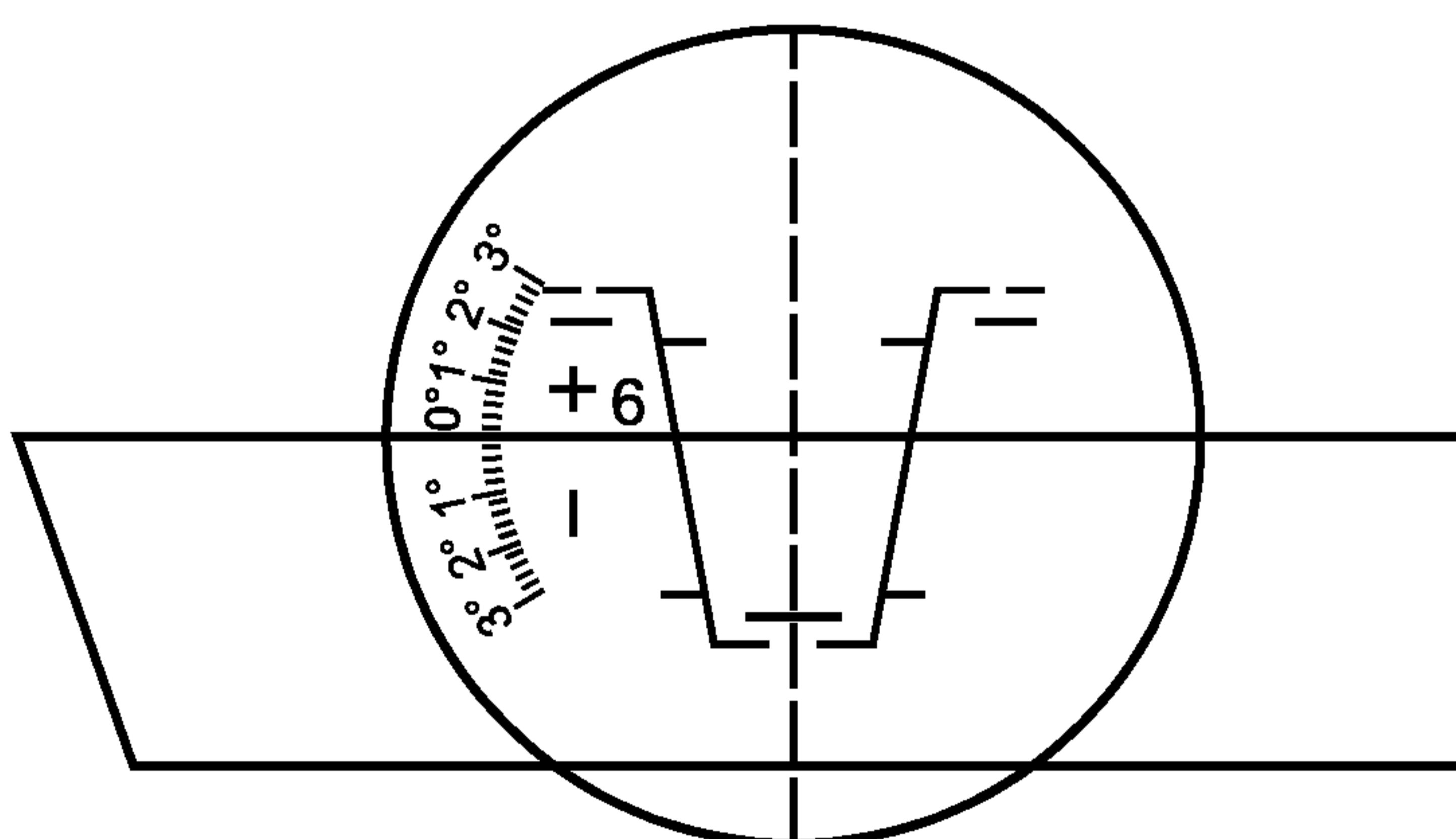
Рисунок 2 — Проверка резьбопрофильной окулярной головки
