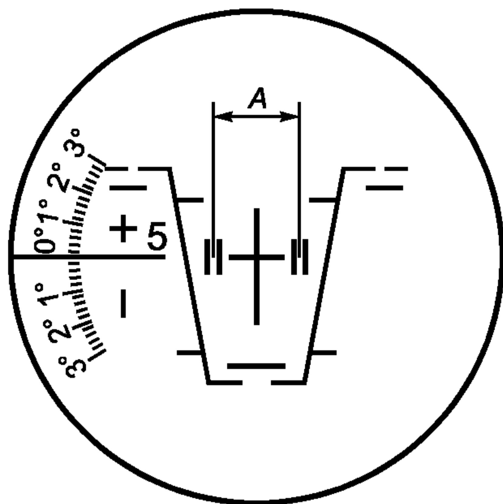
Рисунок 1 — Проверка увеличения микроскопа с объективом 3<sup>х</sup>
