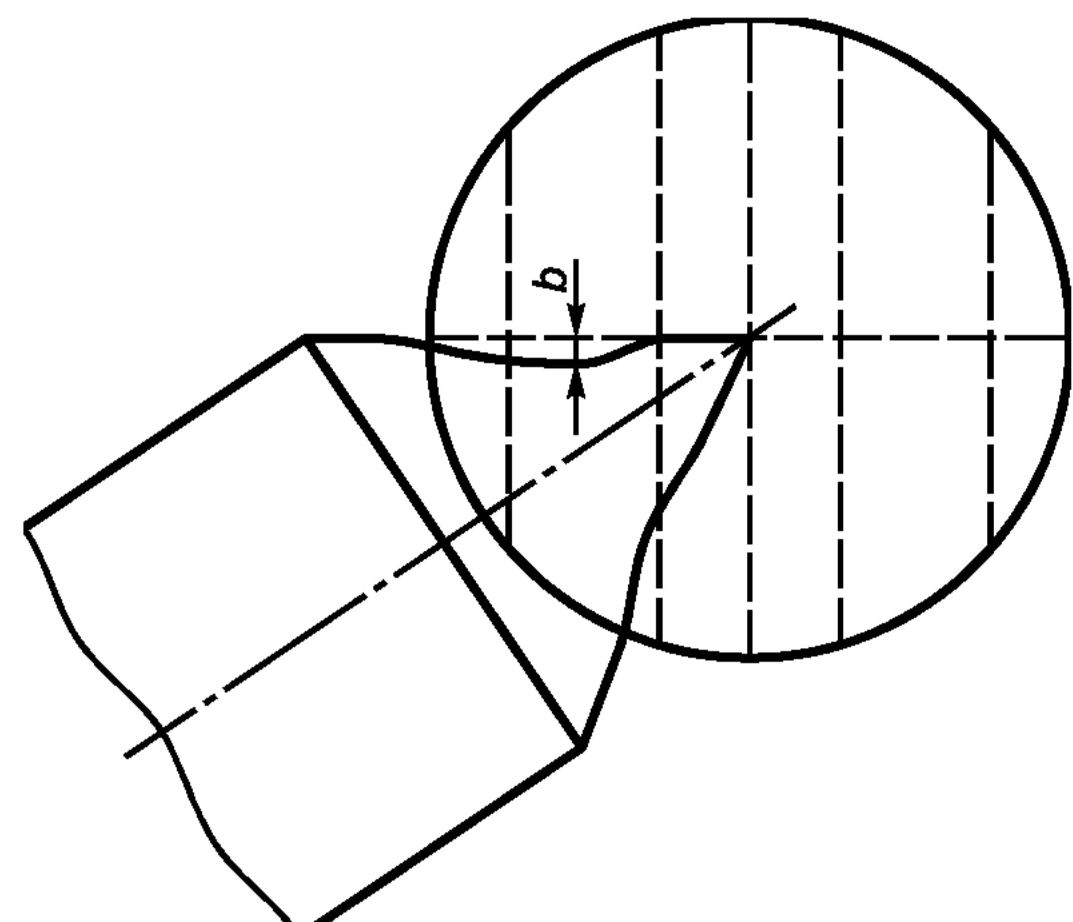
Рисунок 6 — Проверка износа центров
