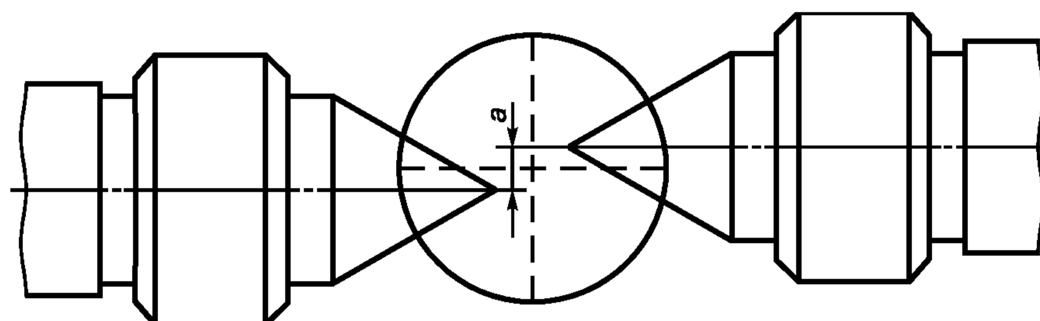
Рисунок 5 — Проверка соосности центров
