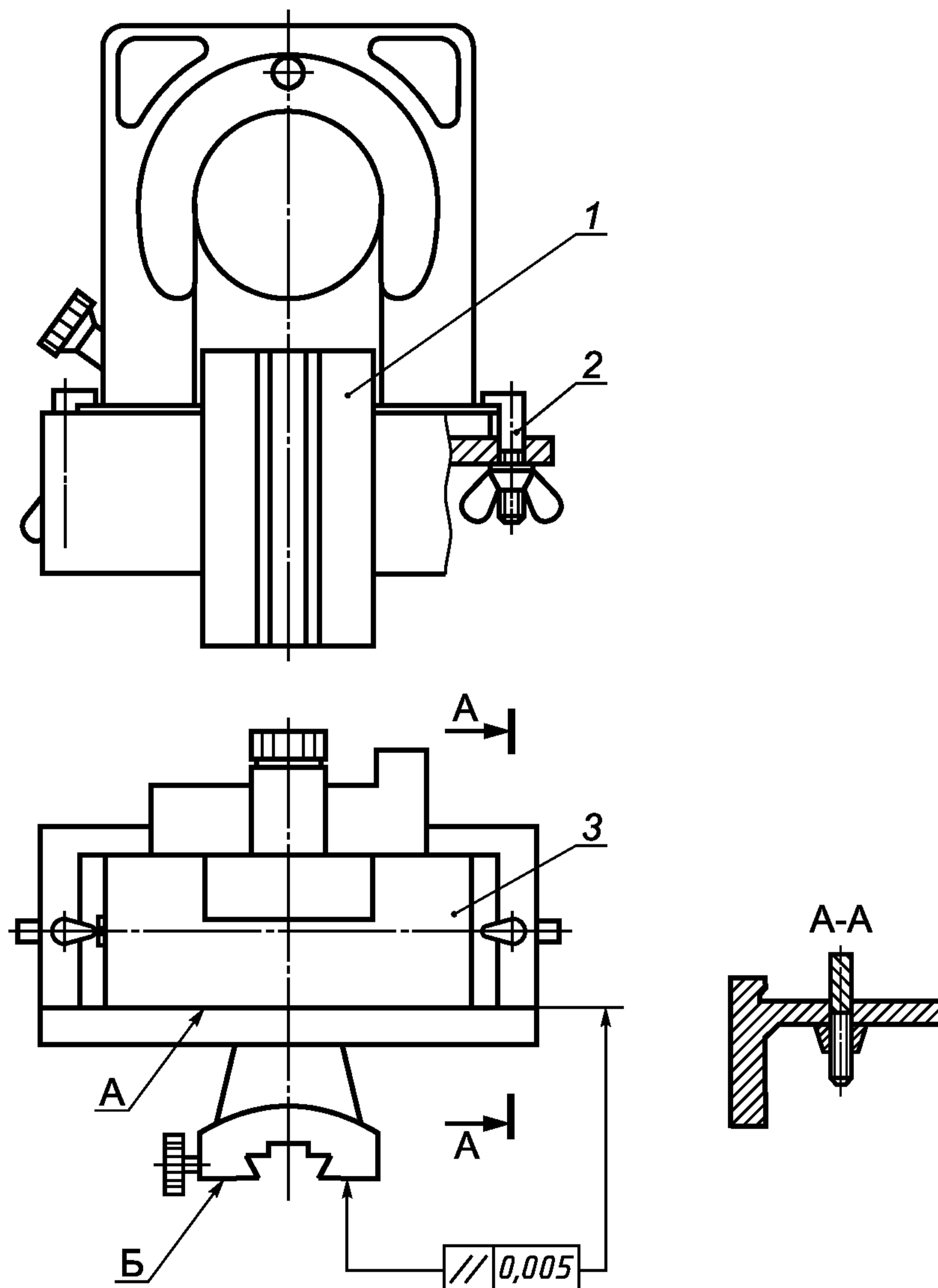
1 — кронштейн; 2 — винт; 3 — квадрант оптический;
