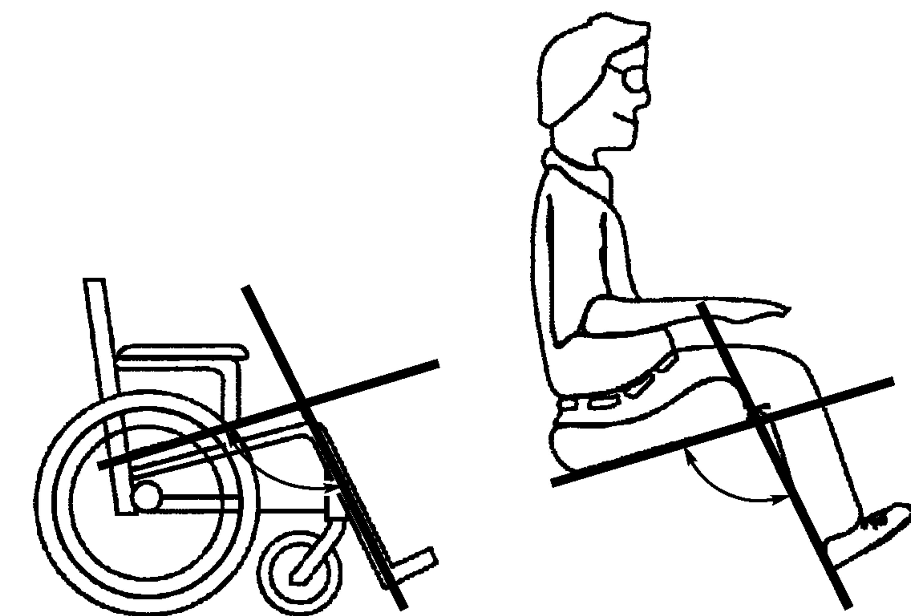
Рисунок 19 — Угол между подножкой и плоскостью сиденья
