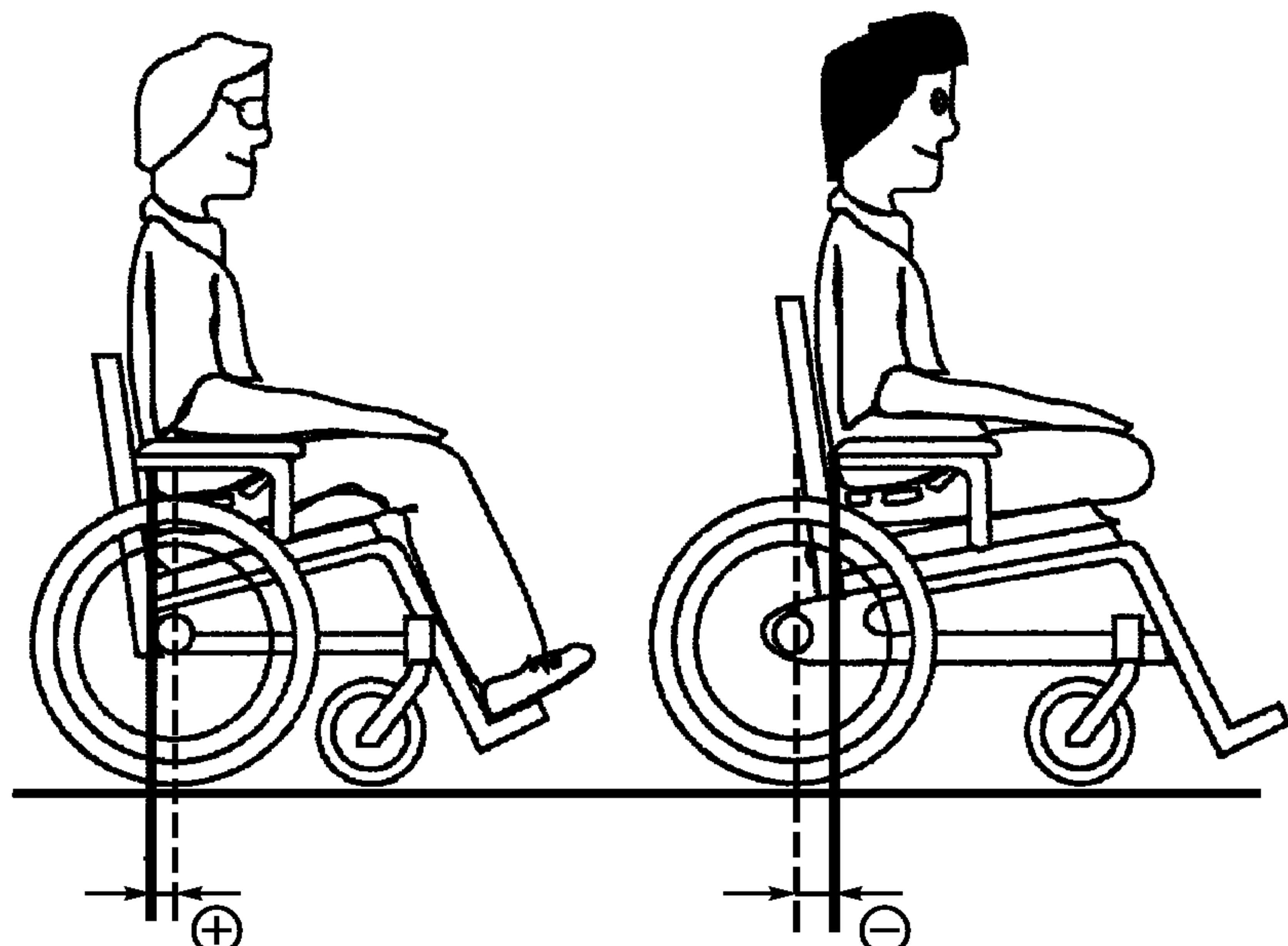
Рисунок 22 — Горизонтальное положение оси
