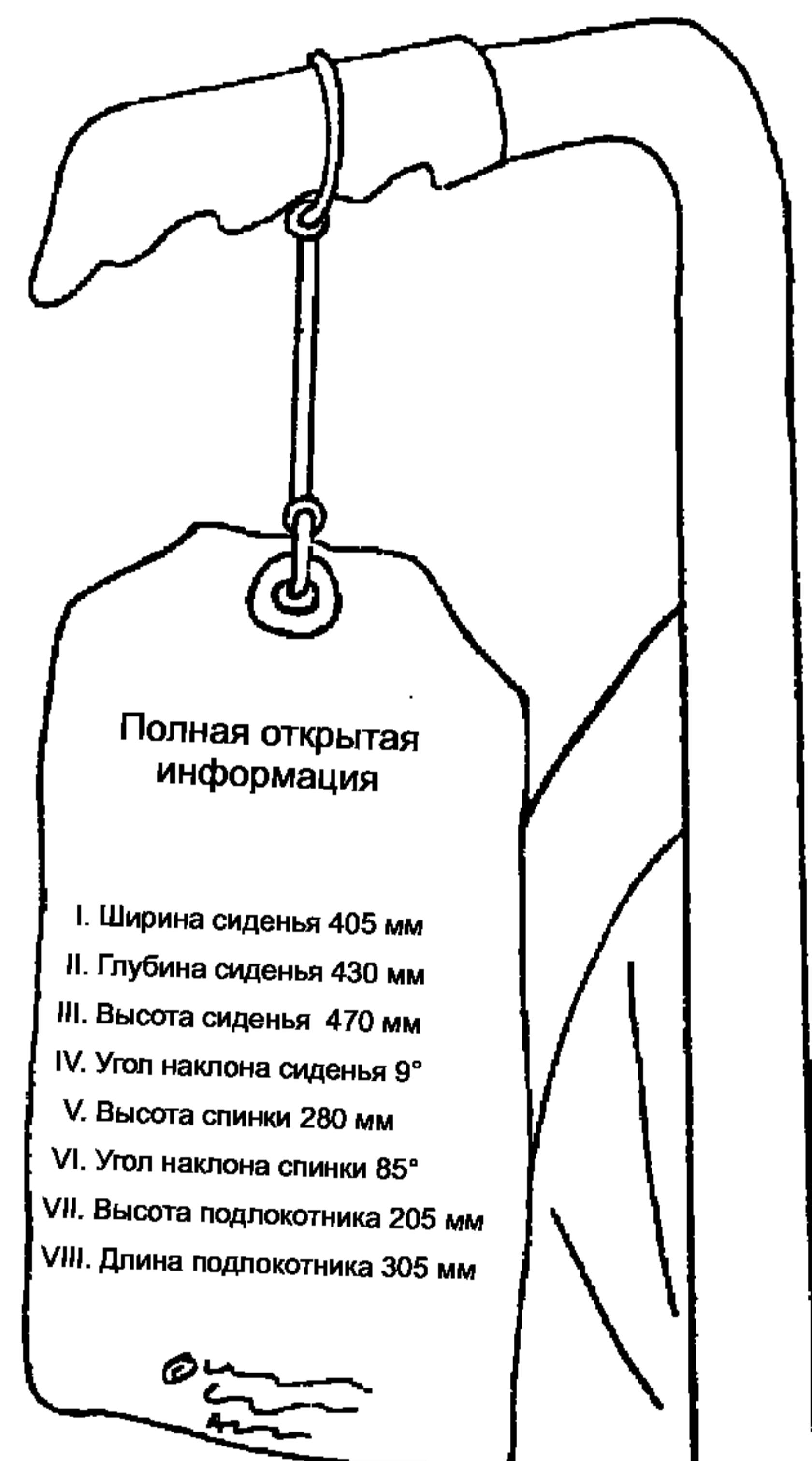
Рисунок 3 — Для того чтобы соответствовать требованиям стандартов ИСО, изготавитель обязан раскрыть определенную информацию о кресле-коляске в своей предпродажной технической документации на изделие
