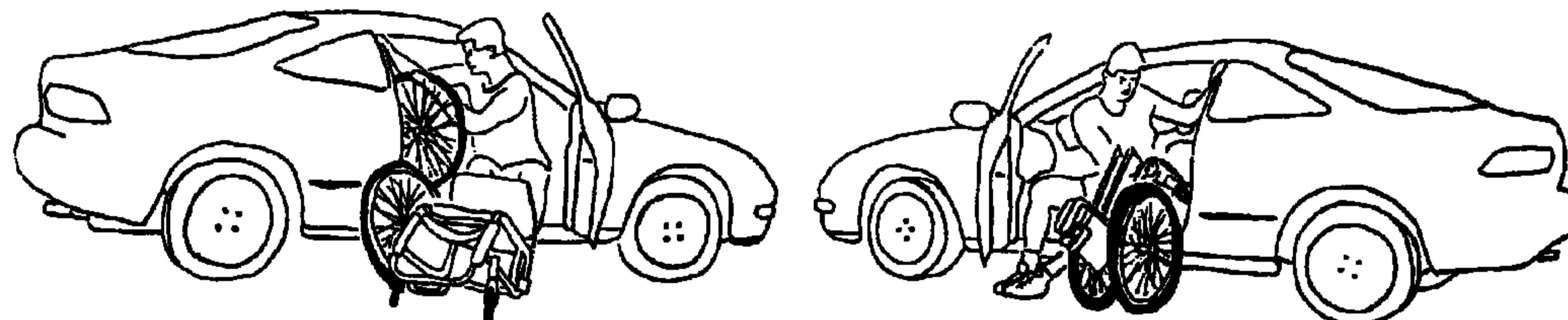
Рисунок 5 — Размещение складного кресла-коляски в автомобиле и извлечение его из автомобиля может быть выполнено быстрее, чем кресла с жесткой рамой. Однако многие пользователи предпочитают использовать кресло-коляску с жесткой рамой на твердой поверхности пола
