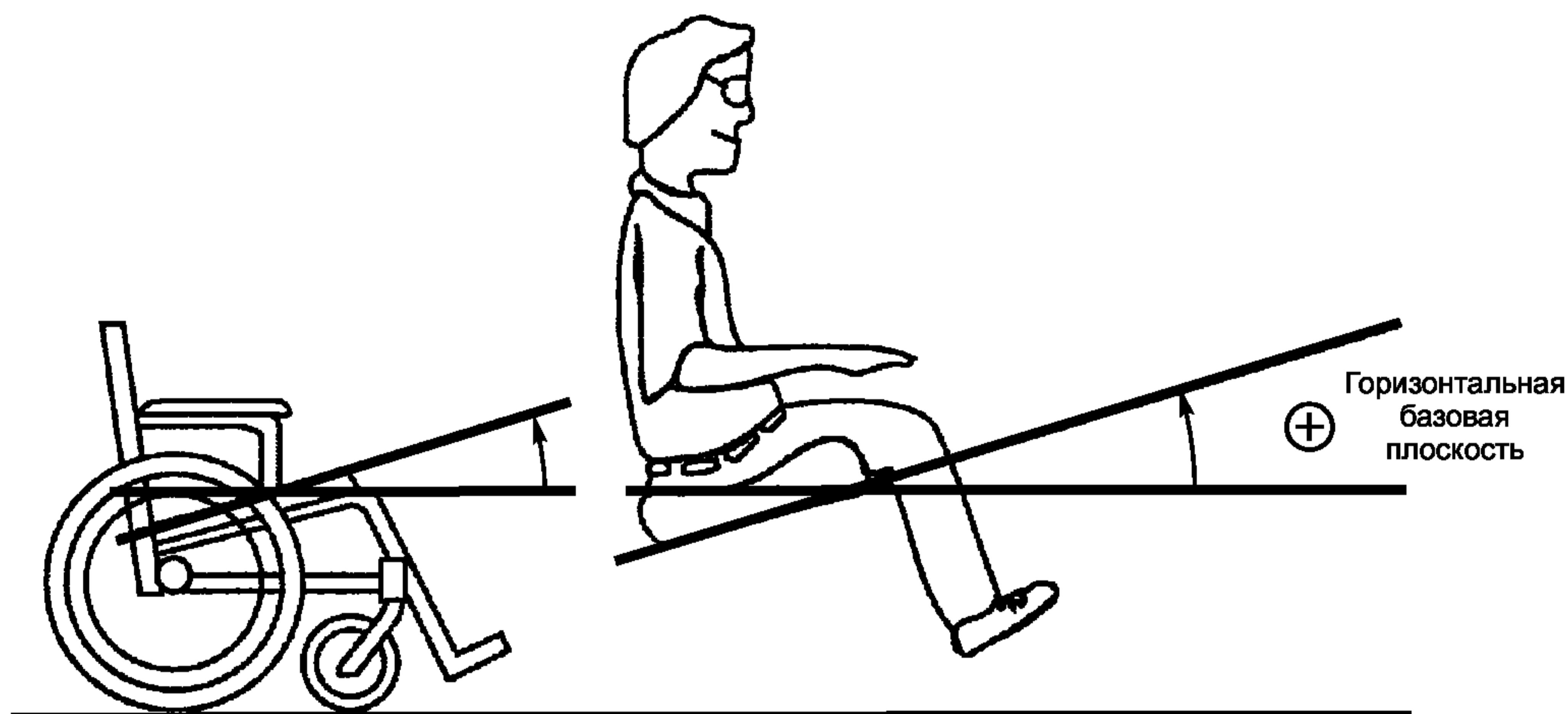
Рисунок 20 — Угол наклона плоскости сиденья
