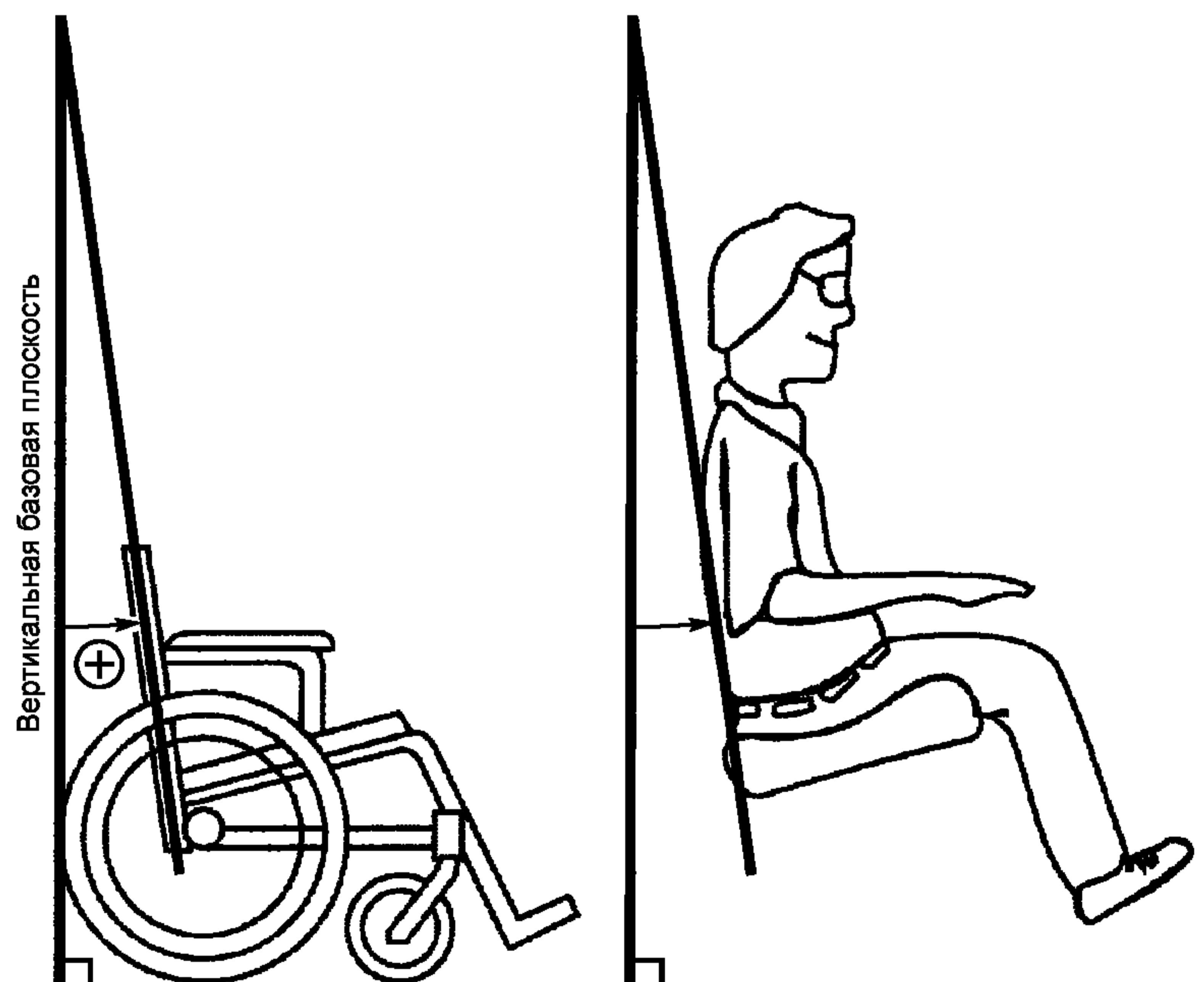
Рисунок 21 — Угол наклона спинки сиденья
