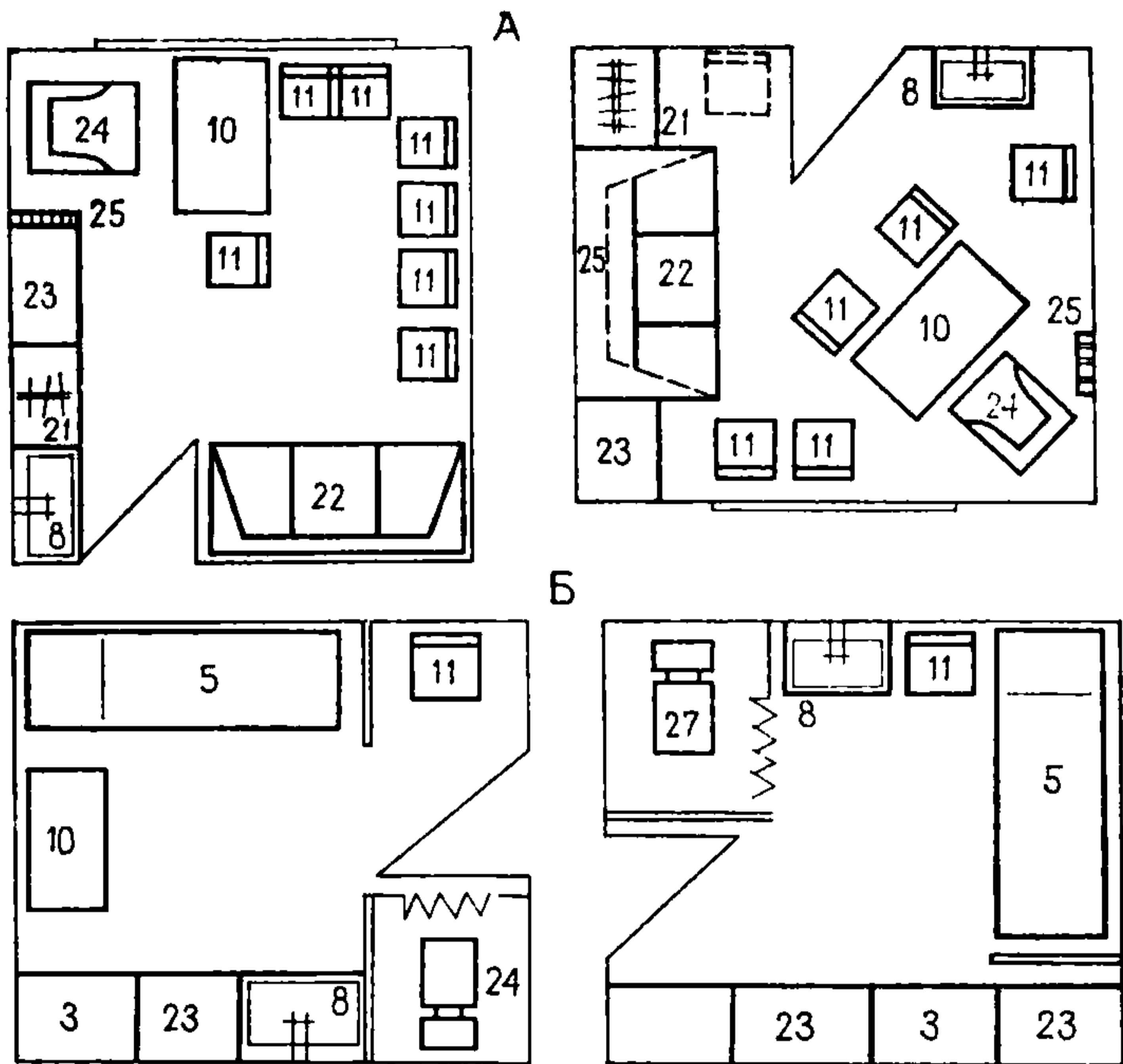
Рис. 22. Варианты планировочной организации А — кабинета заведующего отделением; Б — клизменной (обозначения те же, что на рис. 15).
