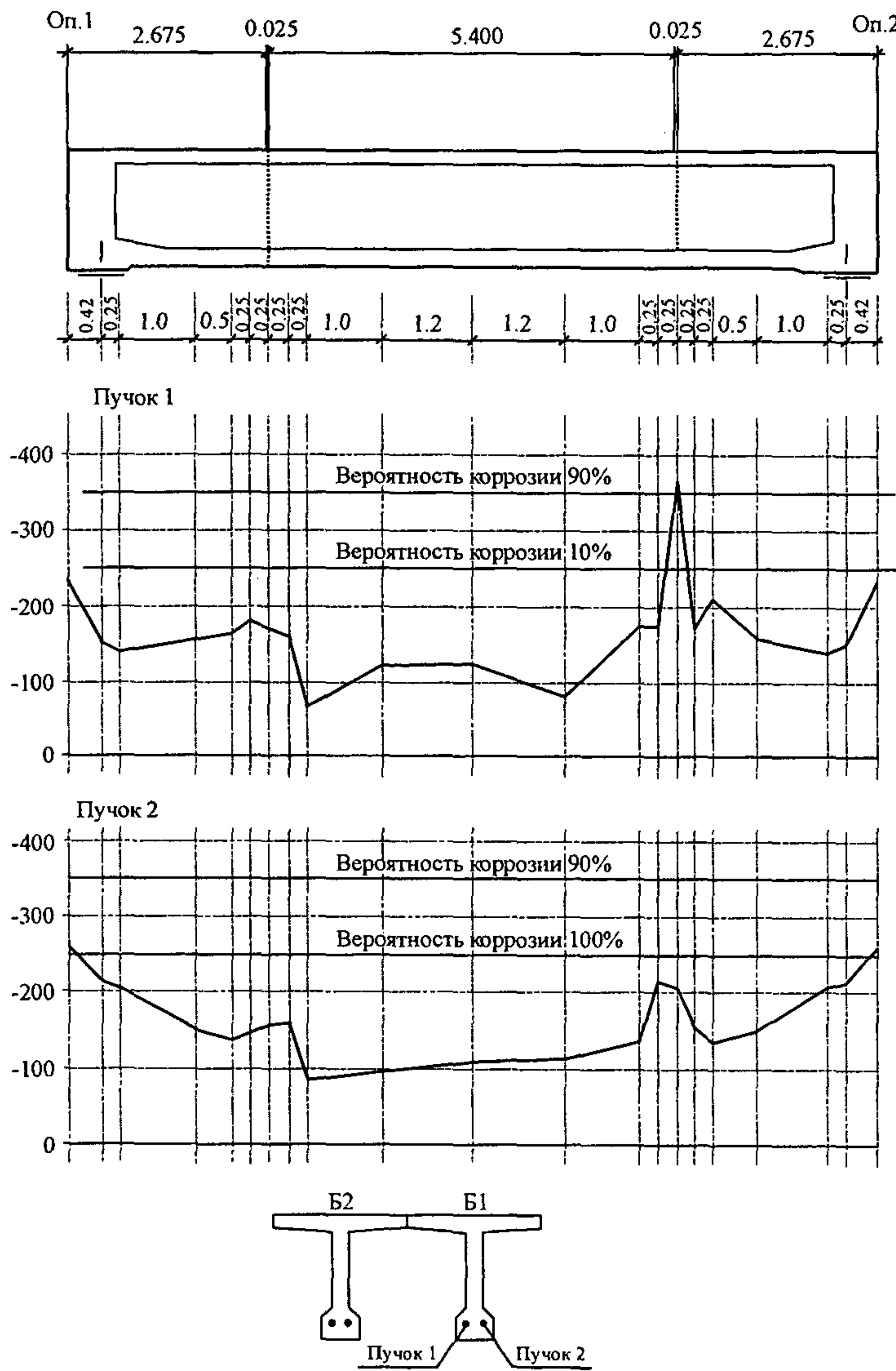
**Рисунок А.4 - Пример изменения потенциалов по длине составной балки. Во втором стыке наблюдается значительный градиент потенциалов, свидетельствующий о высокой вероятности коррозии предварительно напряженной арматуры**
