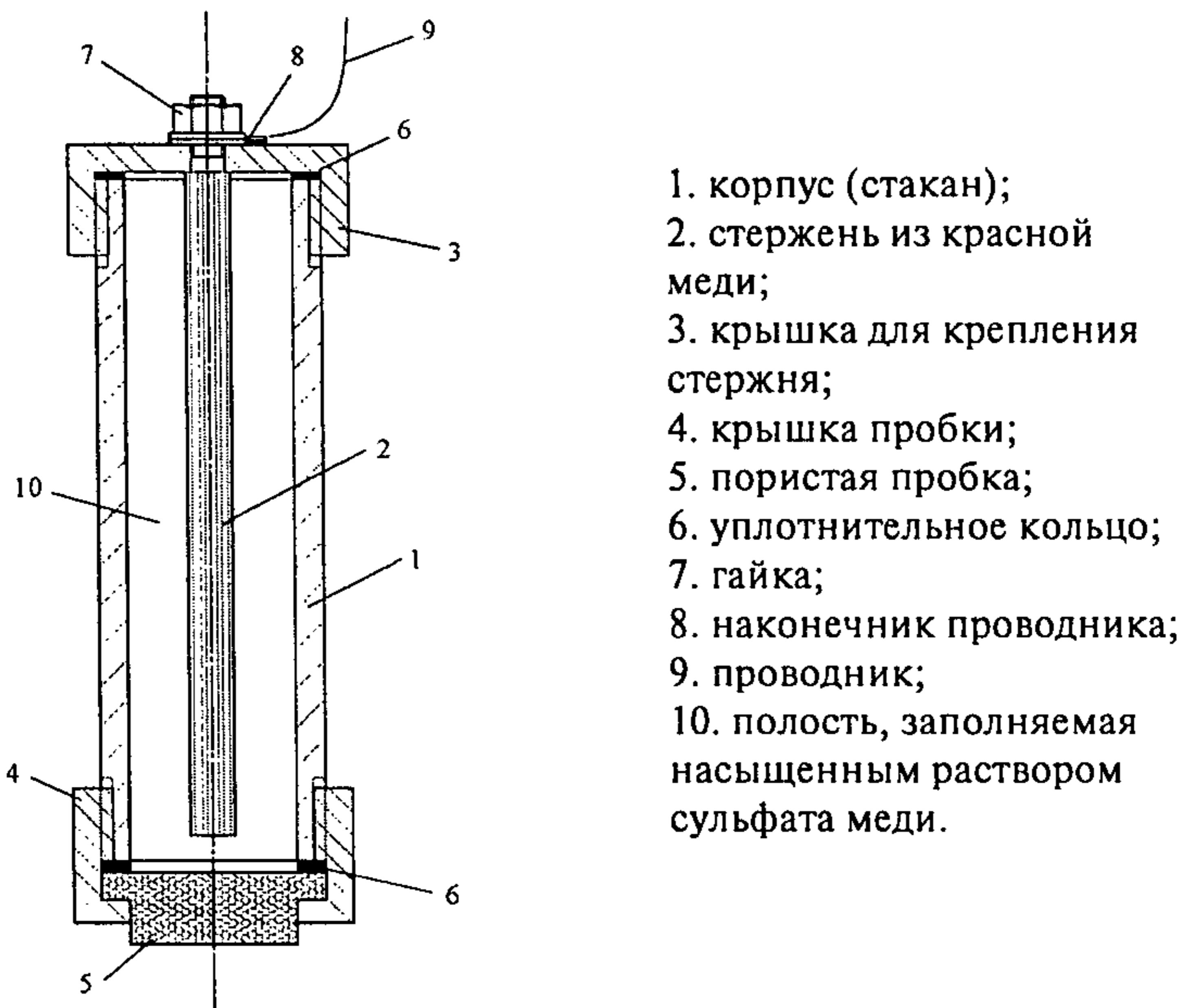
Рисунок 1 – Принципиальная схема конструкции переносного медно-сульфатного электрода сравнения
