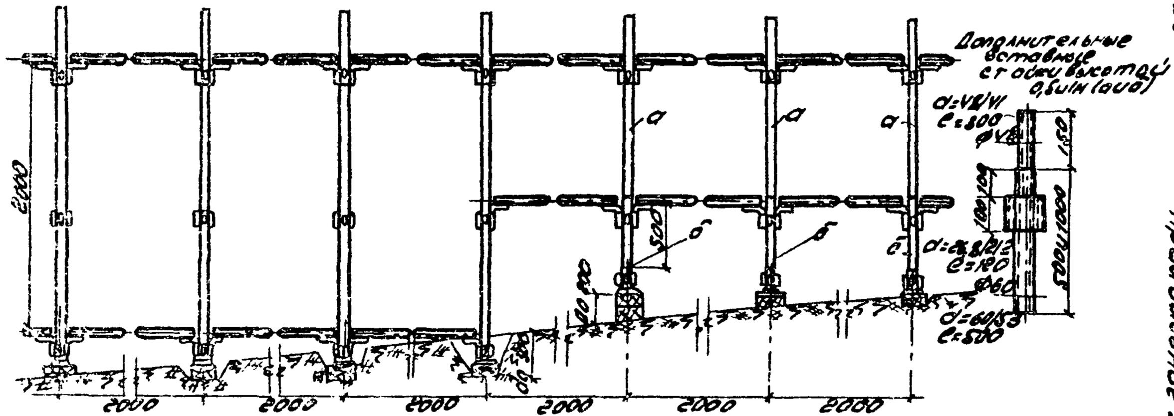
обозначения: а-дополнительная(вставная) стойка высотой 0,5 м; б-та же высотой 0,8 м
