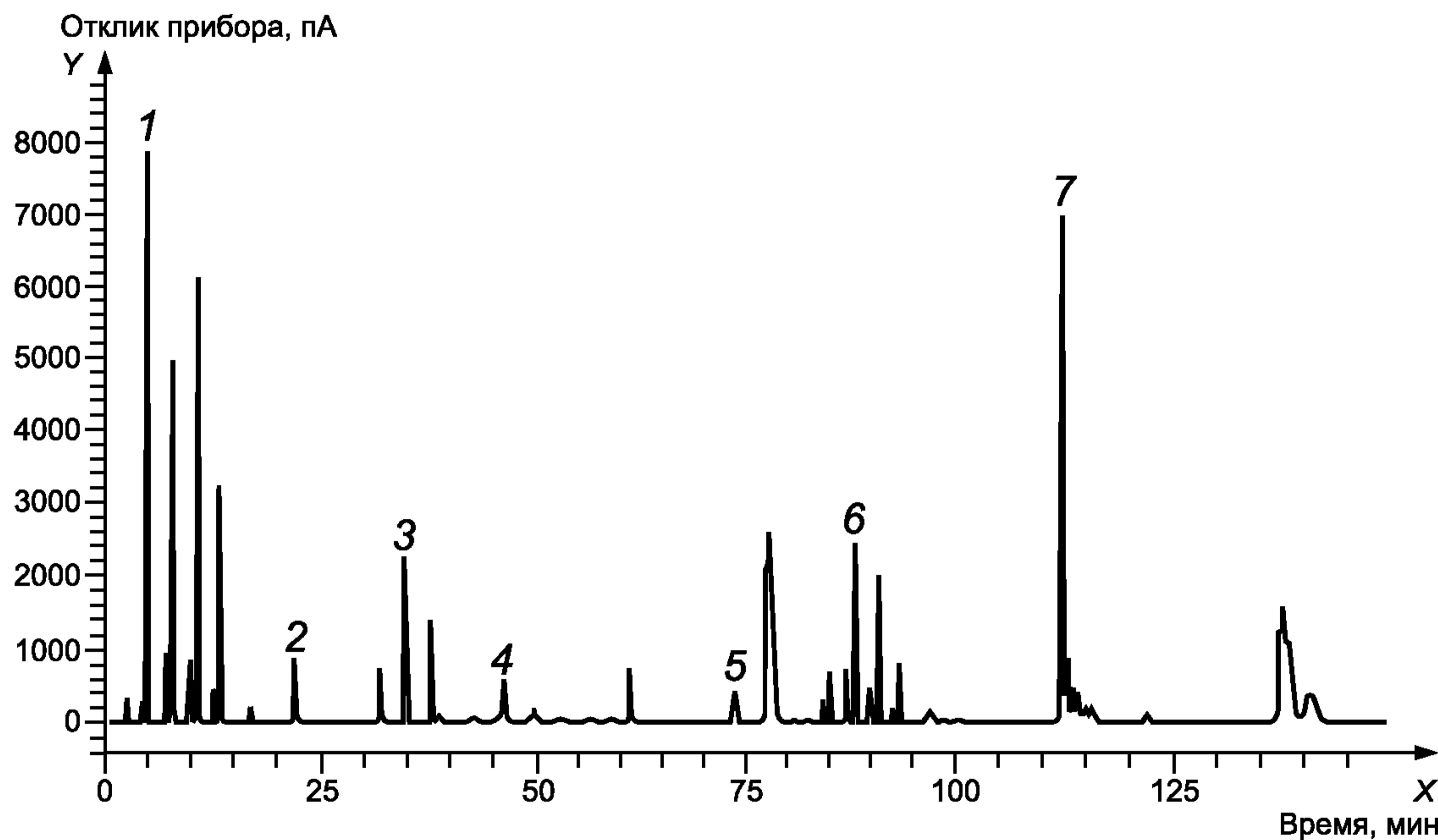
1 — легкие насыщенные углеводороды от  $C_3$  до  $C_8$ ; 2 — МТБЭ; 3 — олефины от  $C_4$  до  $C_6$ ; 4 — тяжелые насыщенные углеводороды от  $C_7$  до  $C_{10}$ ; 5 — бензол; 6 — олефины; 7 — ароматика
