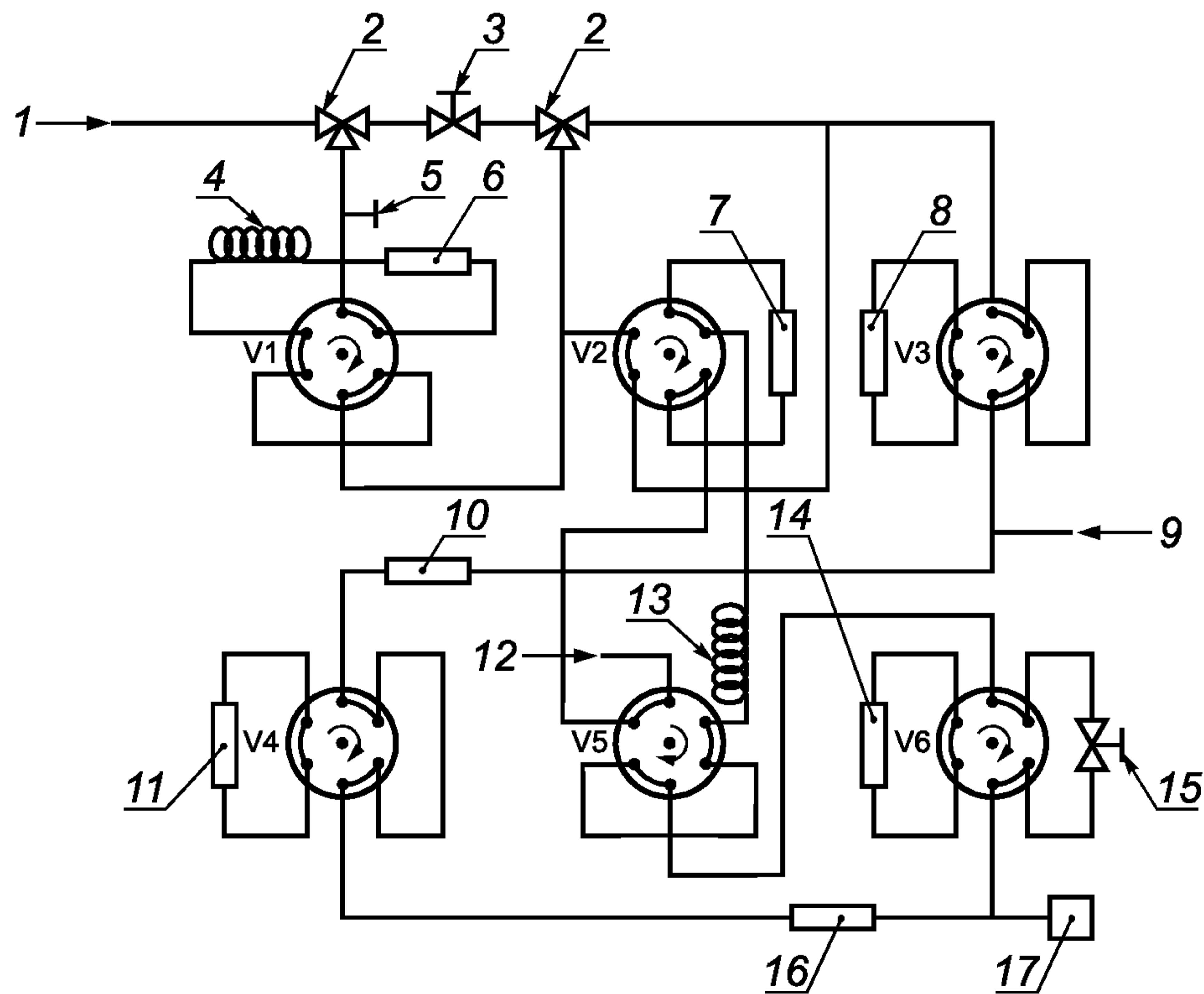
V1—V6 — клапаны переключения колонки/байпасный клапан; 1 — выпуск; 2 — 3-ходовой клапан; 3 — игольчатый клапан;
