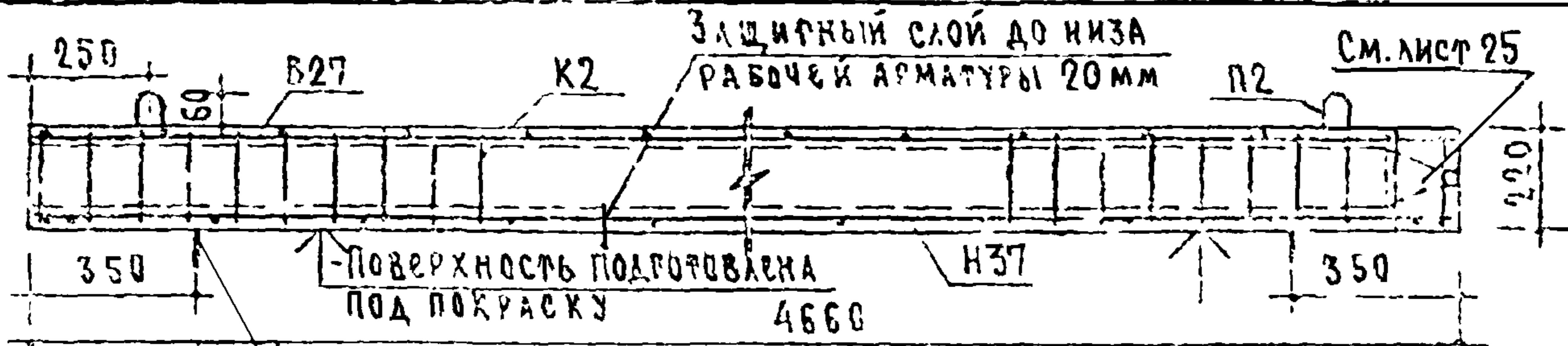
Места опирания при склеивании и транспортировке РАЗРЕЗ 1-1
