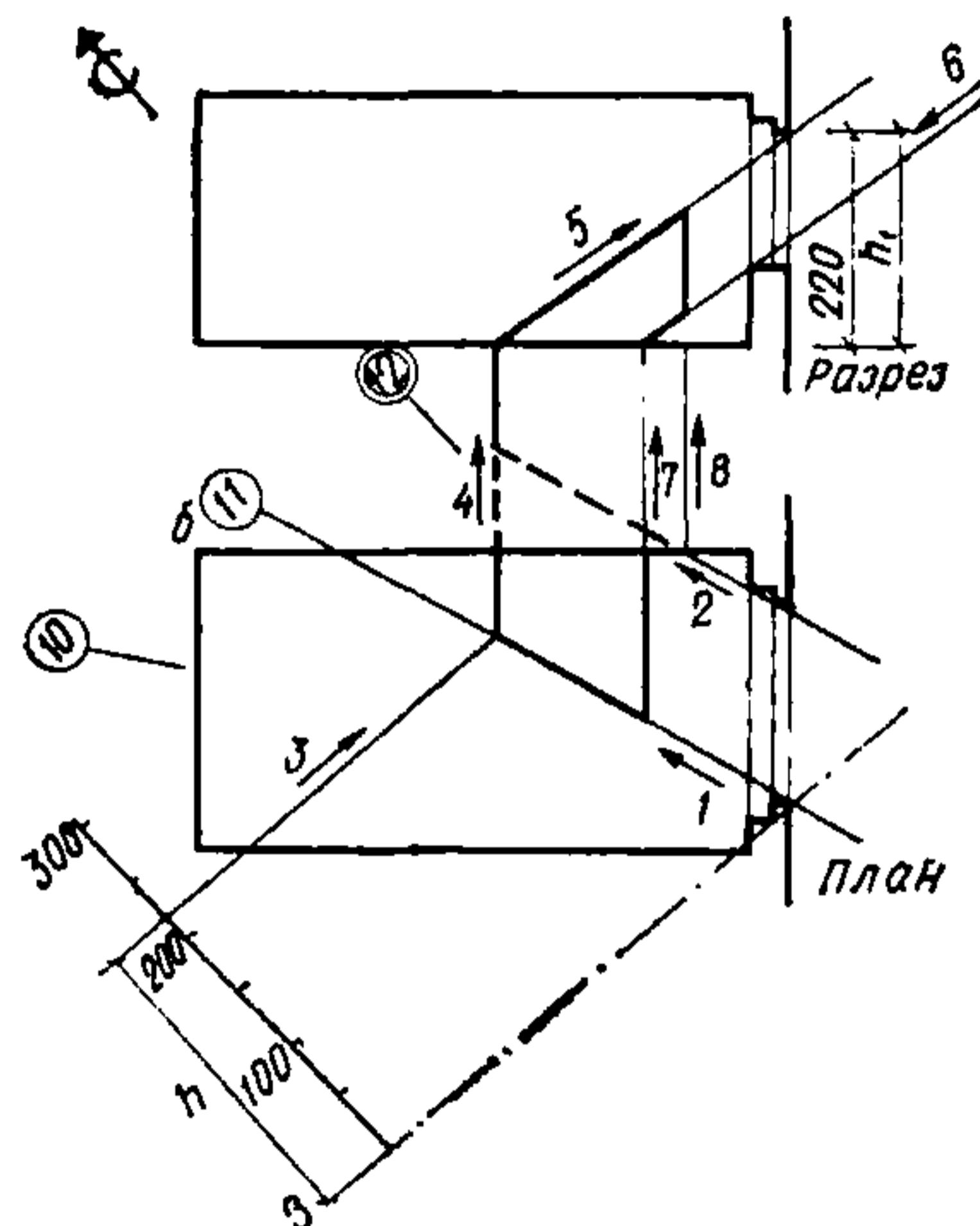
РИС. 5. ОПРЕДЕЛЕНИЕ ЗОН ИНСОЛЯЦИИ ПОВЕРХНОСТЕЙ В ПОМЕЩЕНИИ
