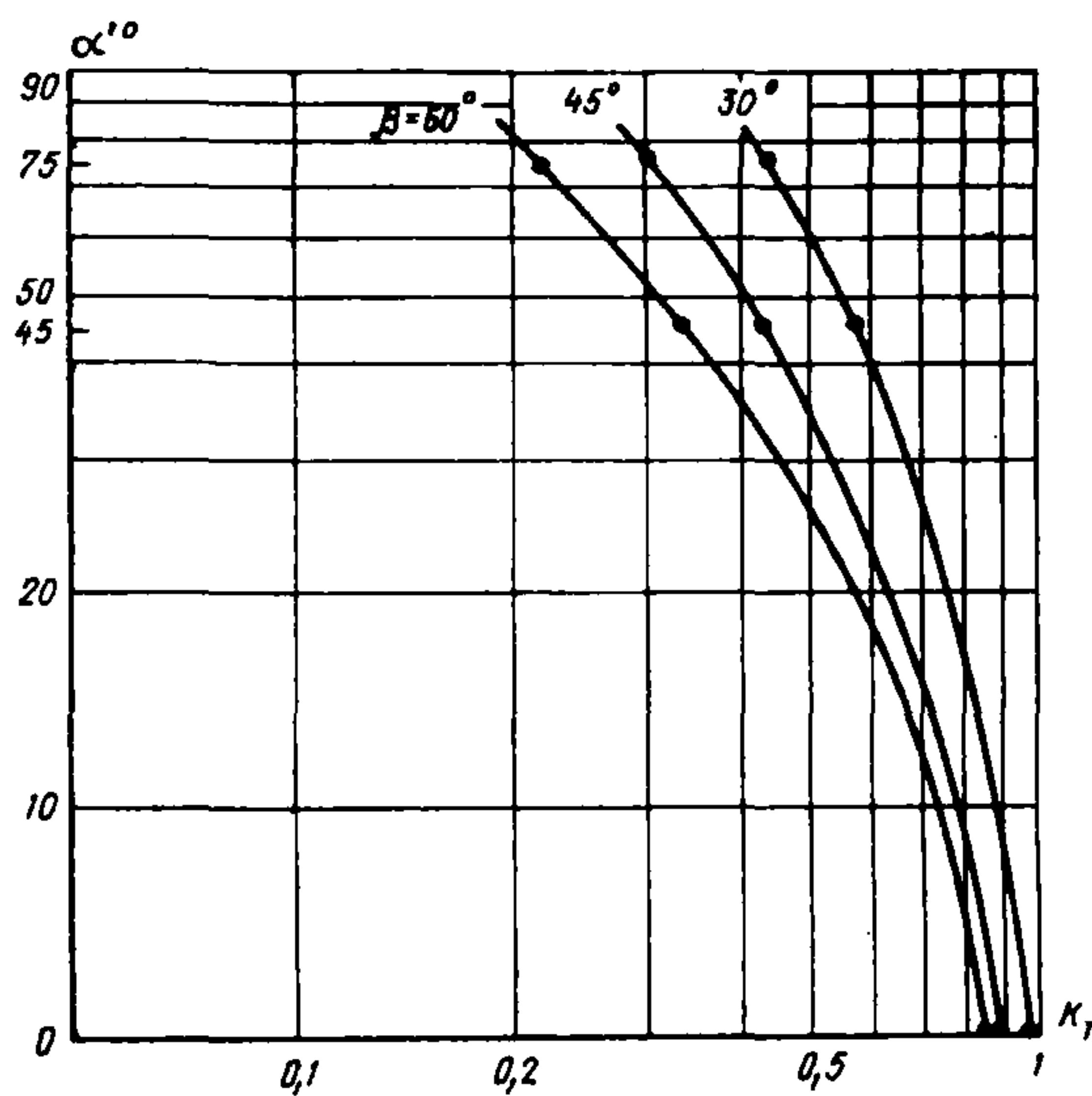
РИС. 19. ЗАВИСИМОСТЬ КОЭФФИЦИЕНТА ТРАНСПОРТАННОСТИ  $K_t$  ОТ УГЛА НАКЛОНА ГОРИЗОНТАЛЬНЫХ ЭЛЕМЕНТОВ СЗУ ДЛЯ ИНТЕРВАЛА ЗНАЧЕНИЙ ЗАЩИТНОГО УГЛА 30—45—60°
