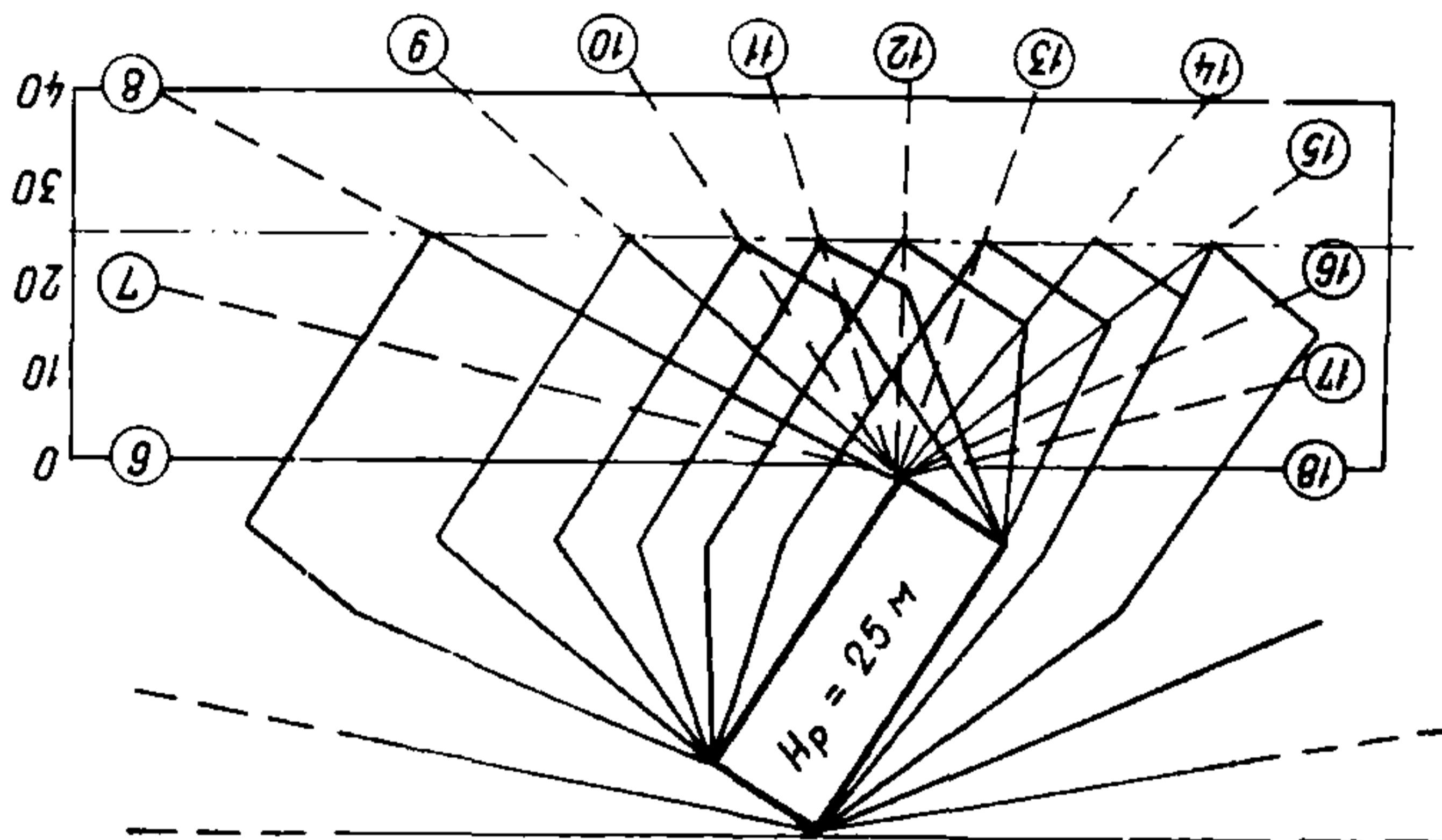
РИС. 4. ПОСТРОЕНИЕ КОНТУРОВ ТЕНЕЙ НА ГОРИЗОНТАЛЬНОЙ ПОВЕРХНОСТИ
