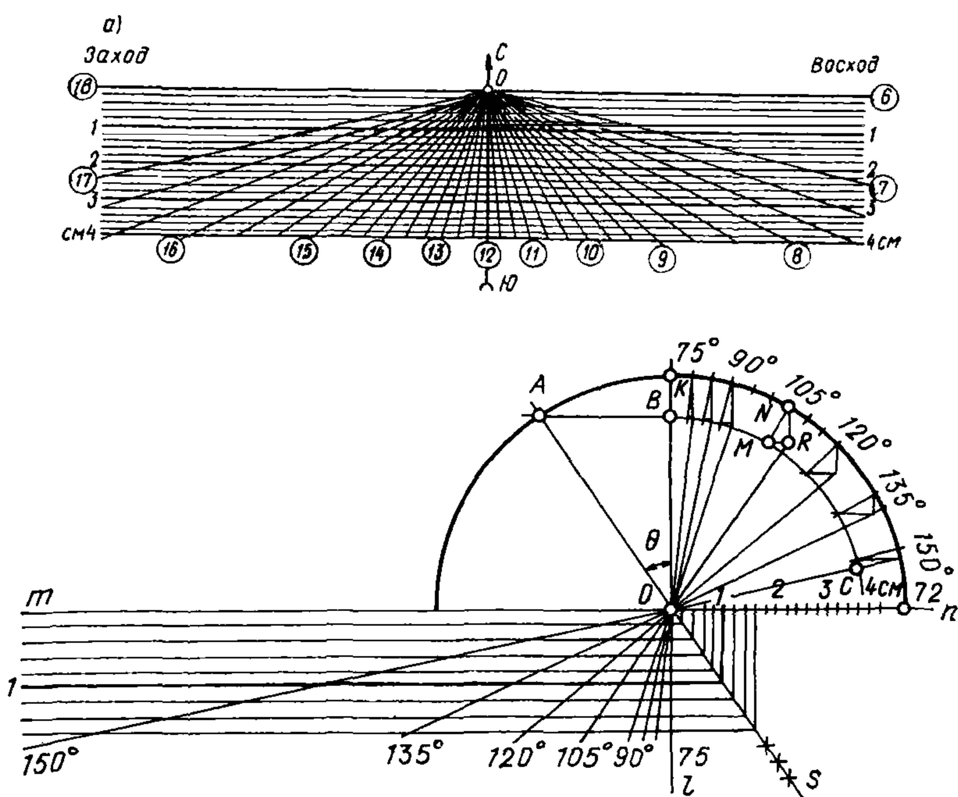
РИС. 1. ГРАФИК РАСЧЕТА ПРОДОЛЖИТЕЛЬНОСТИ ИНСОЛЯЦИИ
