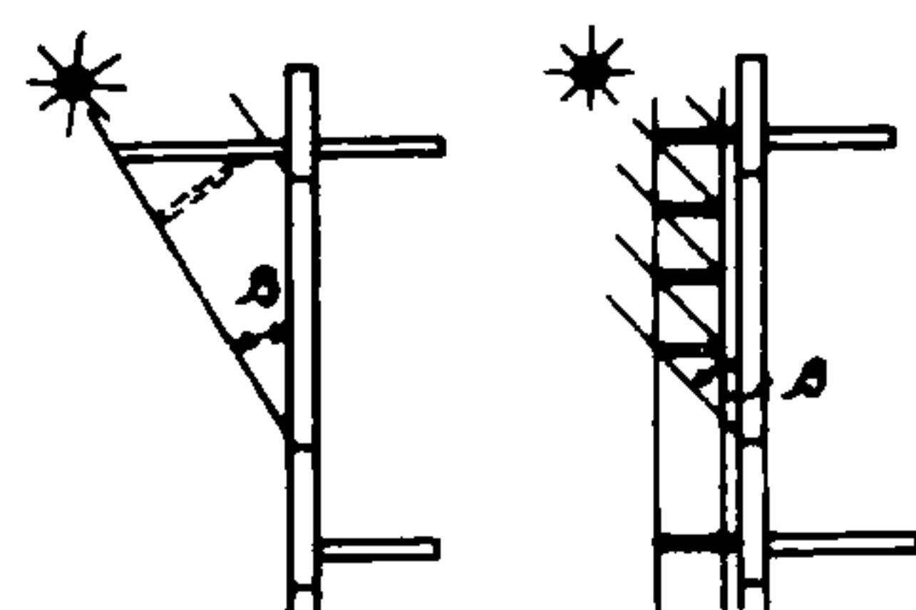
РИС. 8. ЗАЩИТНЫЕ УГЛЫ  $\beta$  И  $\gamma$  ДЛЯ ОПРЕДЕЛЕНИЯ ГЕОМЕТРИЧЕСКИХ ПАРАМЕТРОВ СОЛНЦЕЗАЩИТНЫХ УСТРОЙСТВ
