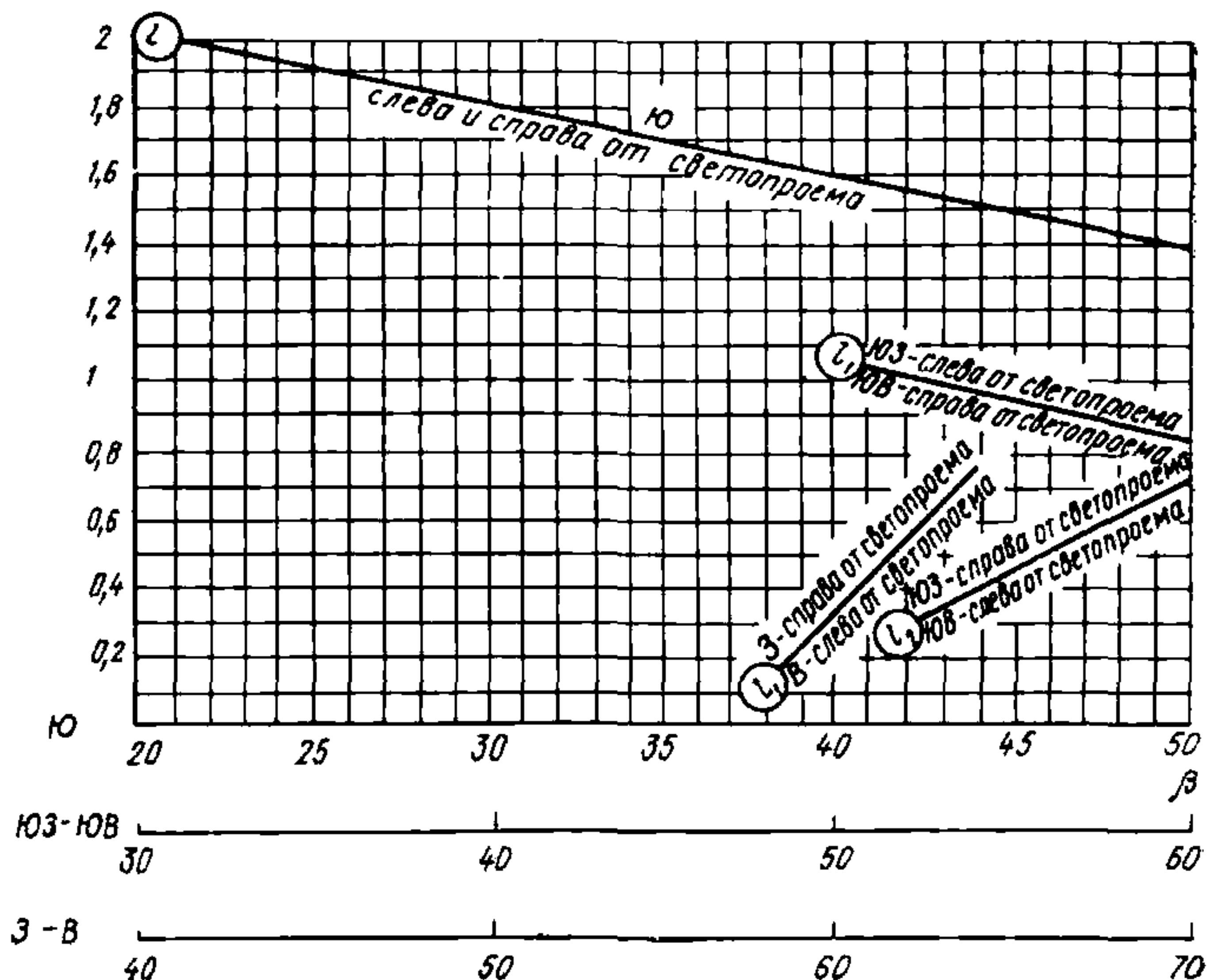
РИС. 11. ОПРЕДЕЛЕНИЕ РАЗМЕРОВ БОКОВЫХ ВЫНОСОВ КОЗЫРЬКОВ ( $l_1$  и  $l_2$ ) В ЗАВИСИМОСТИ ОТ ОРИЕНТАЦИИ (РАЗМЕРЫ  $l_1$  и  $l_2$  ДАНЫ В ОТНОСИТЕЛЬНЫХ ЕДИНИЦАХ ОТ ВЕЛИЧИНЫ ПРЕВЫШЕНИЯ КОЗЫРЬКА НАД ПОДОКОННИКОМ —  $H$ )
