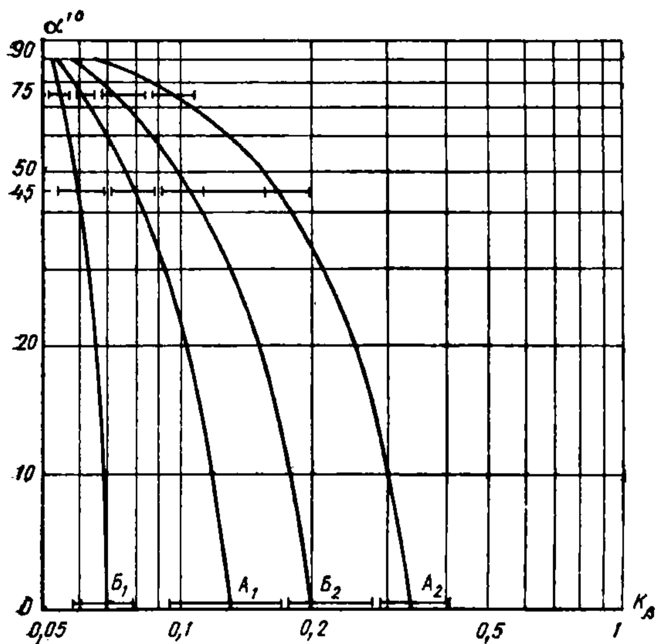
РИС. 20. ЗАВИСИМОСТЬ КОЭФФИЦИЕНТА ПРОПУСКАНИЯ СОЛНЕЧНОЙ РАДИАЦИИ ОТ УГЛА НАКЛОНА ГОРИЗОНТАЛЬНЫХ ЭЛЕМЕНТОВ СЗУ ПРИ ОТКРЫТОМ (A) И ЗАКРЫТОМ (B) РЕЖИМАХ ПОМЕЩЕНИЯ
