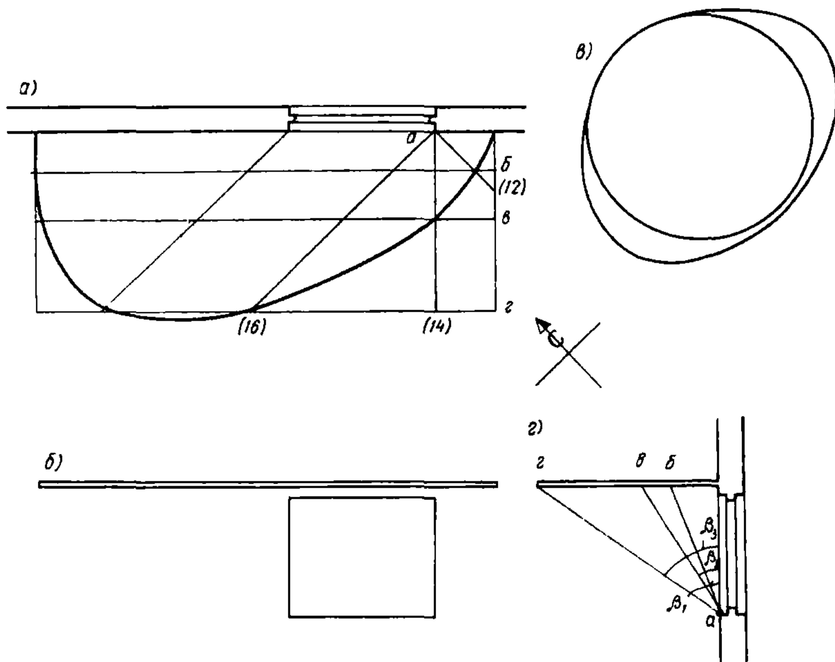
РИС. 10. ПОСТРОЕНИЕ КОЗЫРЬКА СВОБОДНОЙ ФОРМЫ В ЗАВИСИМОСТИ ОТ ДВИЖЕНИЯ СОЛНЦА ПО НЕБОСВОДУ
