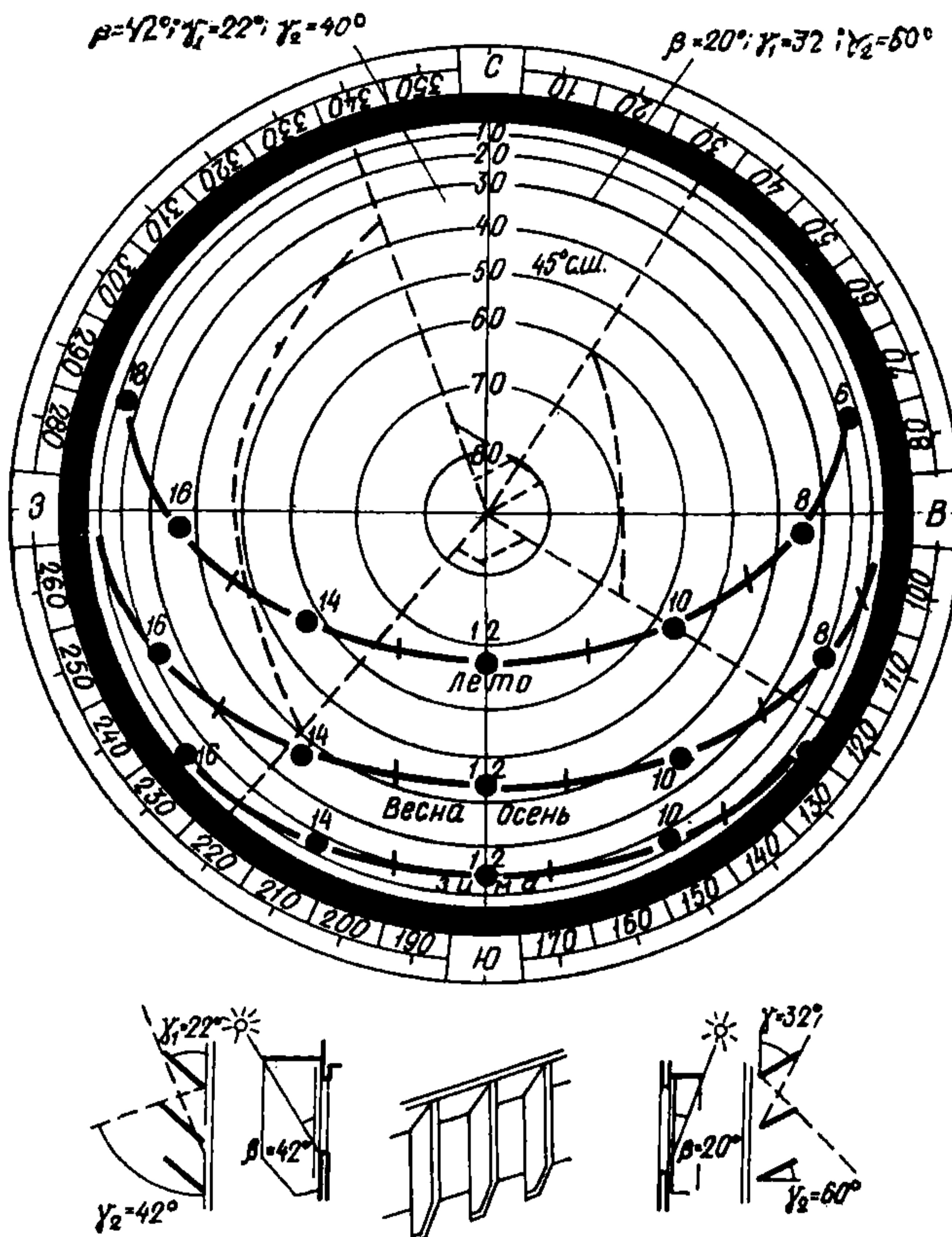
РИС. 3. К ГРАФИЧЕСКОМУ МЕТОДУ ВЫБОРА РАЗМЕРОВ КОЗЫРЬКОВ И ЭКРАНОВ. ПРИ НАЛОЖЕНИИ ГРАФИКА РИС. 2 НА СОЛНЕЧНУЮ КАРТУ ПО КРИВЫМ ТРАЕКТОРИИ СОЛНЦА ОЧЕРЧИВАЮТСЯ ГРАНИЦЫ (ВРЕМЯ) ЗАТЕНИЕНИЯ СВЕТОПРОЕМОВ
