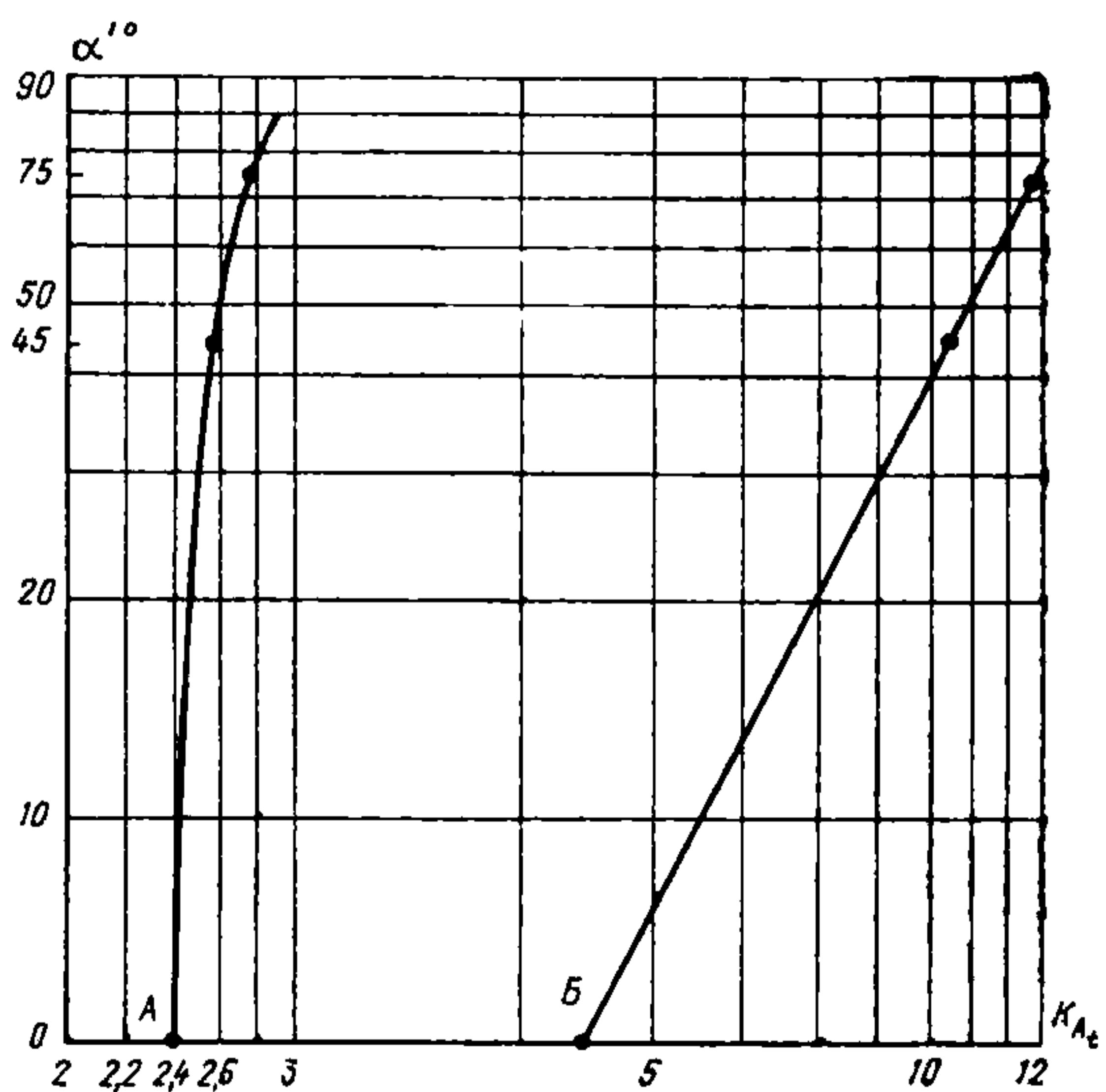
РИС. 21. ЗАВИСИМОСТЬ КОЭФФИЦИЕНТА АМПЛИТУДЫ КОЛЕБАНИЙ ТЕМПЕРАТУРЫ ВОЗДУХА  $K_{A_t}$  ОТ УГЛА НАКЛОНА ГОРИЗОНТАЛЬНЫХ ЭЛЕМЕНТОВ СЗУ ПРИ ОТКРЫТОМ (A) И ЗАКРЫТОМ (B) РЕЖИМАХ ПОМЕЩЕНИЯ
