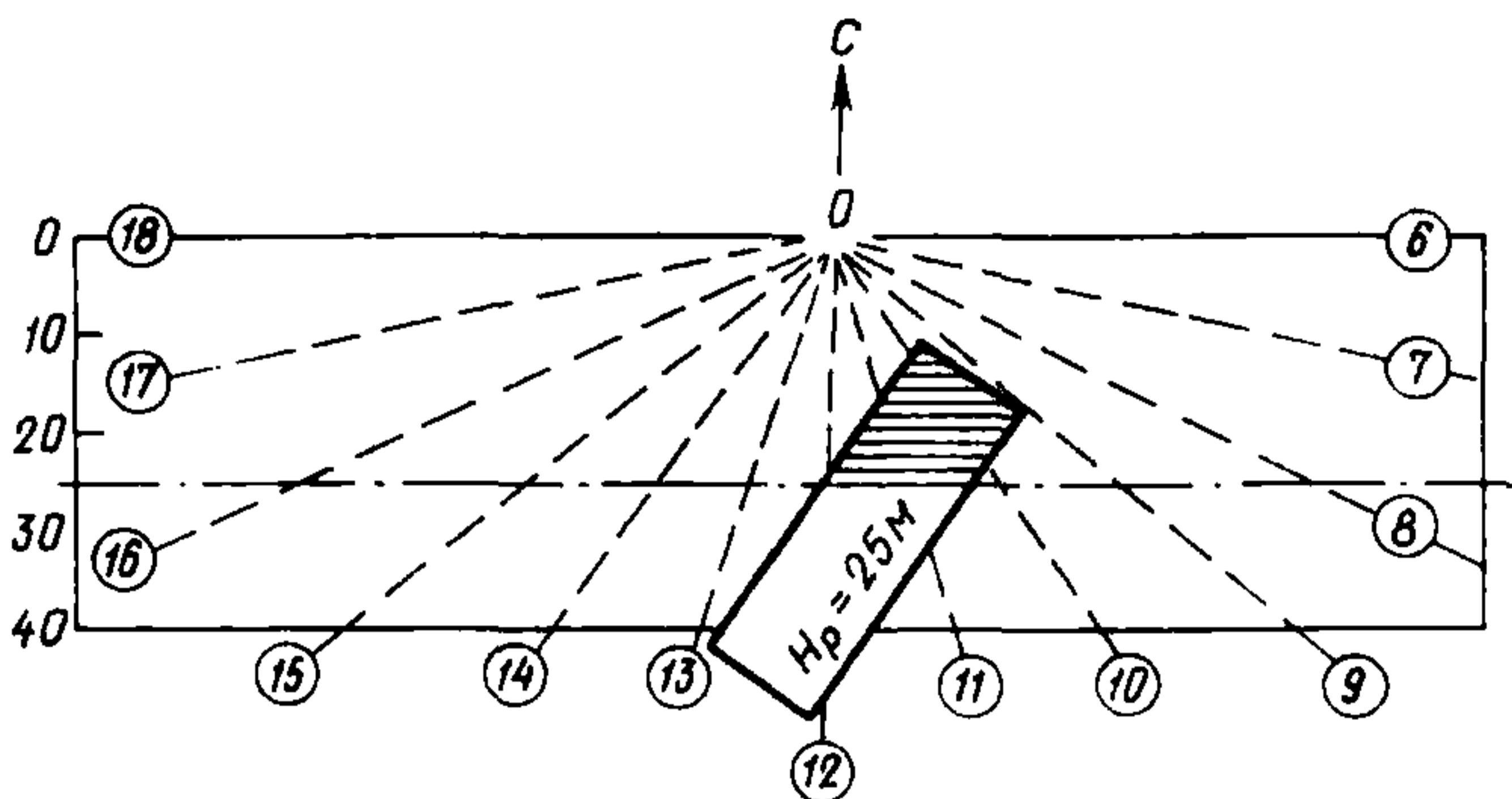
РИС. 3. ОПРЕДЕЛЕНИЕ ПРОДОЛЖИТЕЛЬНОСТИ ИНСОЛЯЦИИ ЗАДАННОЙ ТОЧКИ
