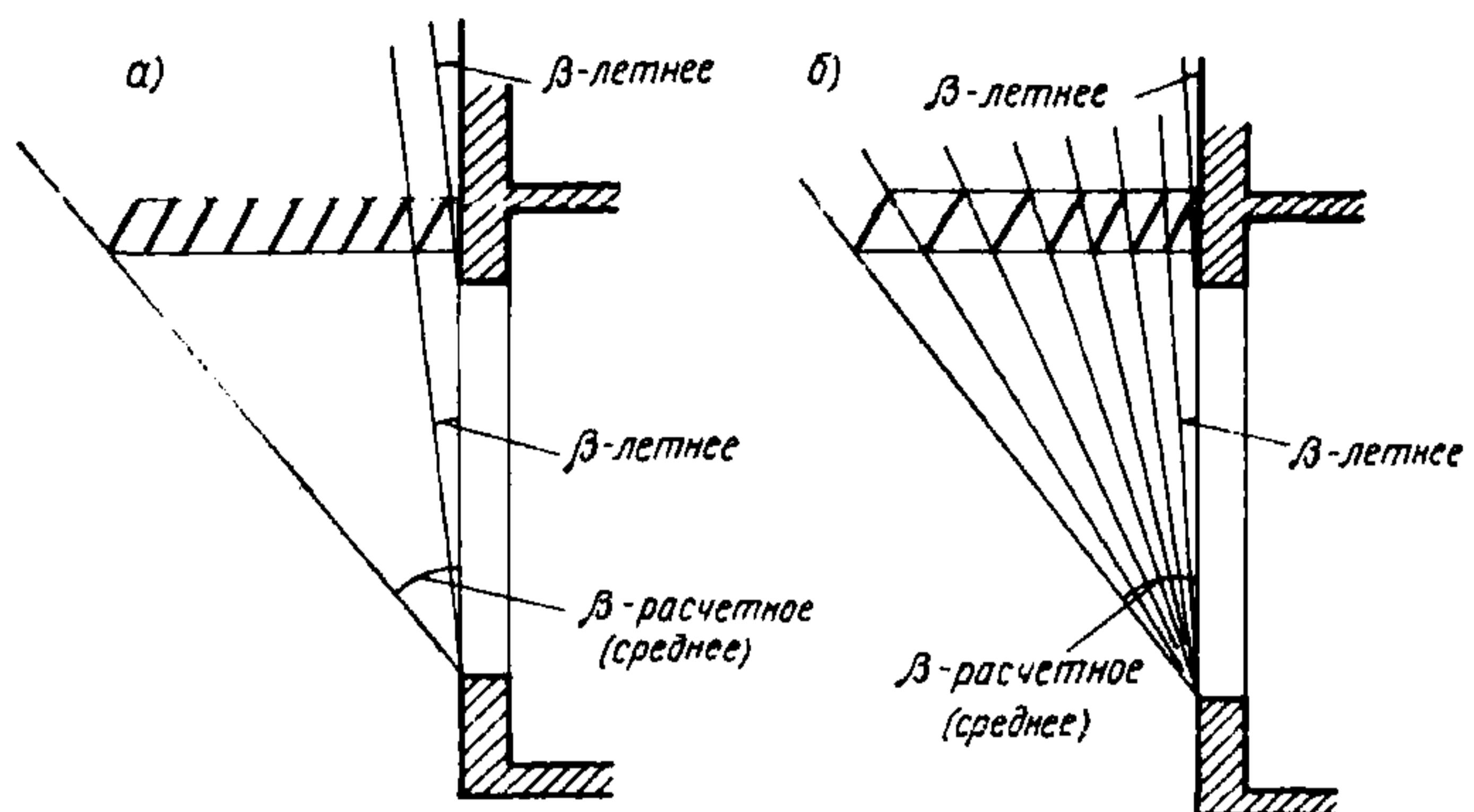
РИС. 9. КОНСТРУКТИВНЫЕ СХЕМЫ РЕШЕТЧАТЫХ КОЗЫРЬКОВ
