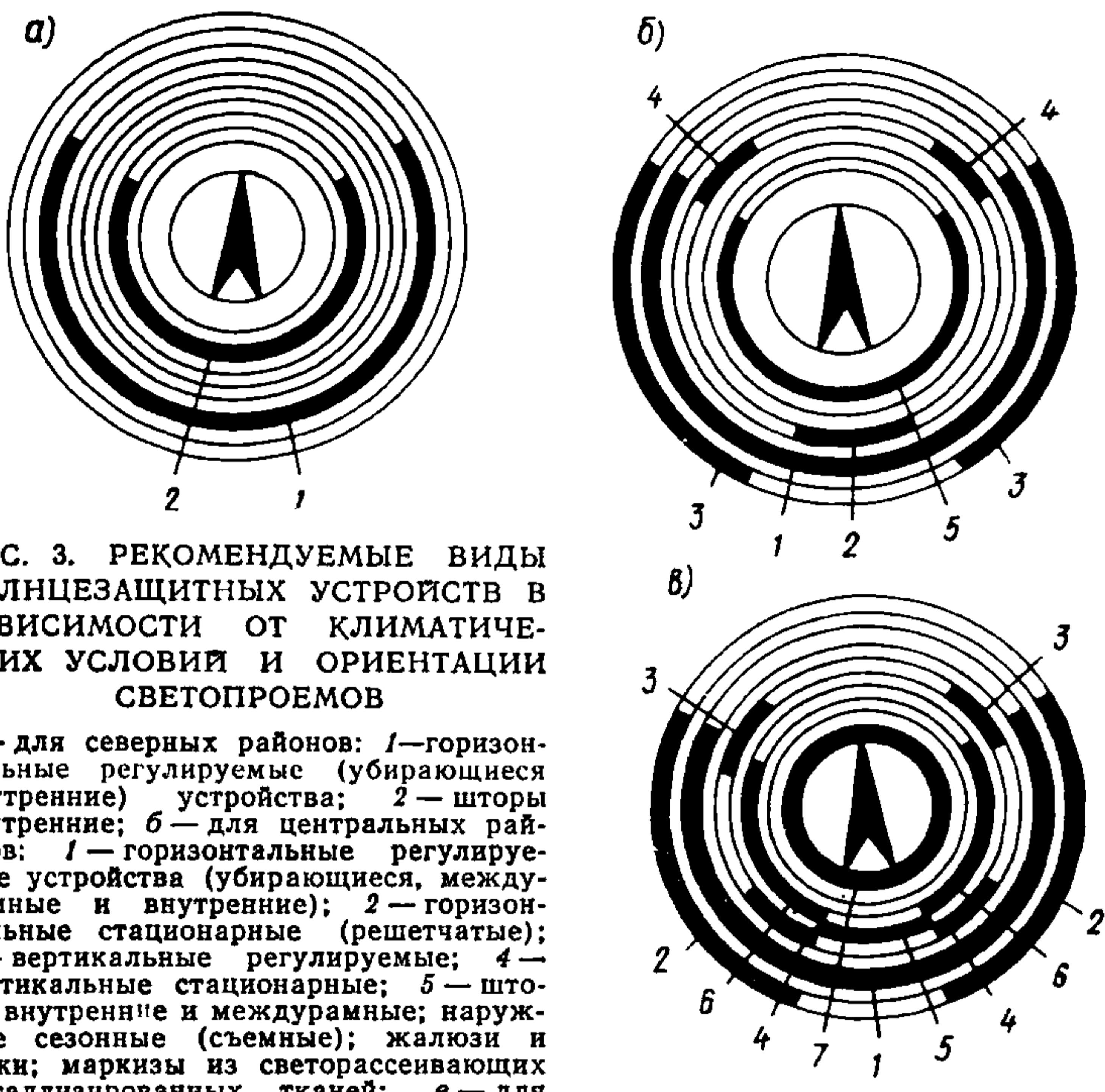
РИС. 3. РЕКОМЕНДУЕМЫЕ ВИДЫ СОЛНЦЕЗАЩИТНЫХ УСТРОЙСТВ В ЗАВИСИМОСТИ ОТ КЛИМАТИЧЕСКИХ УСЛОВИЙ И ОРИЕНТАЦИИ СВЕТОПРОЕМОВ
