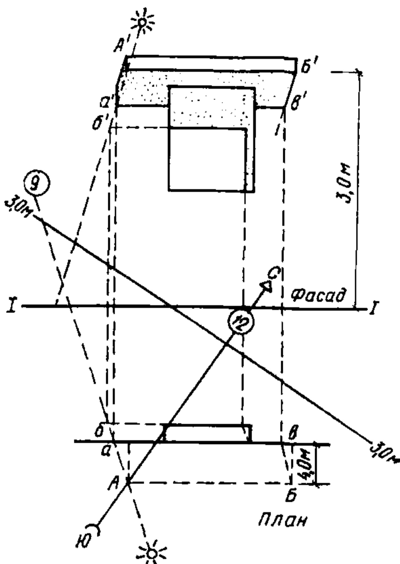
РИС. 8. ПОСТРОЕНИЕ СХЕМЫ ЗАТЕНЕНИЯ ФАСАДА КОЗЫРЬКОМ (БАЛКОНОМ)
