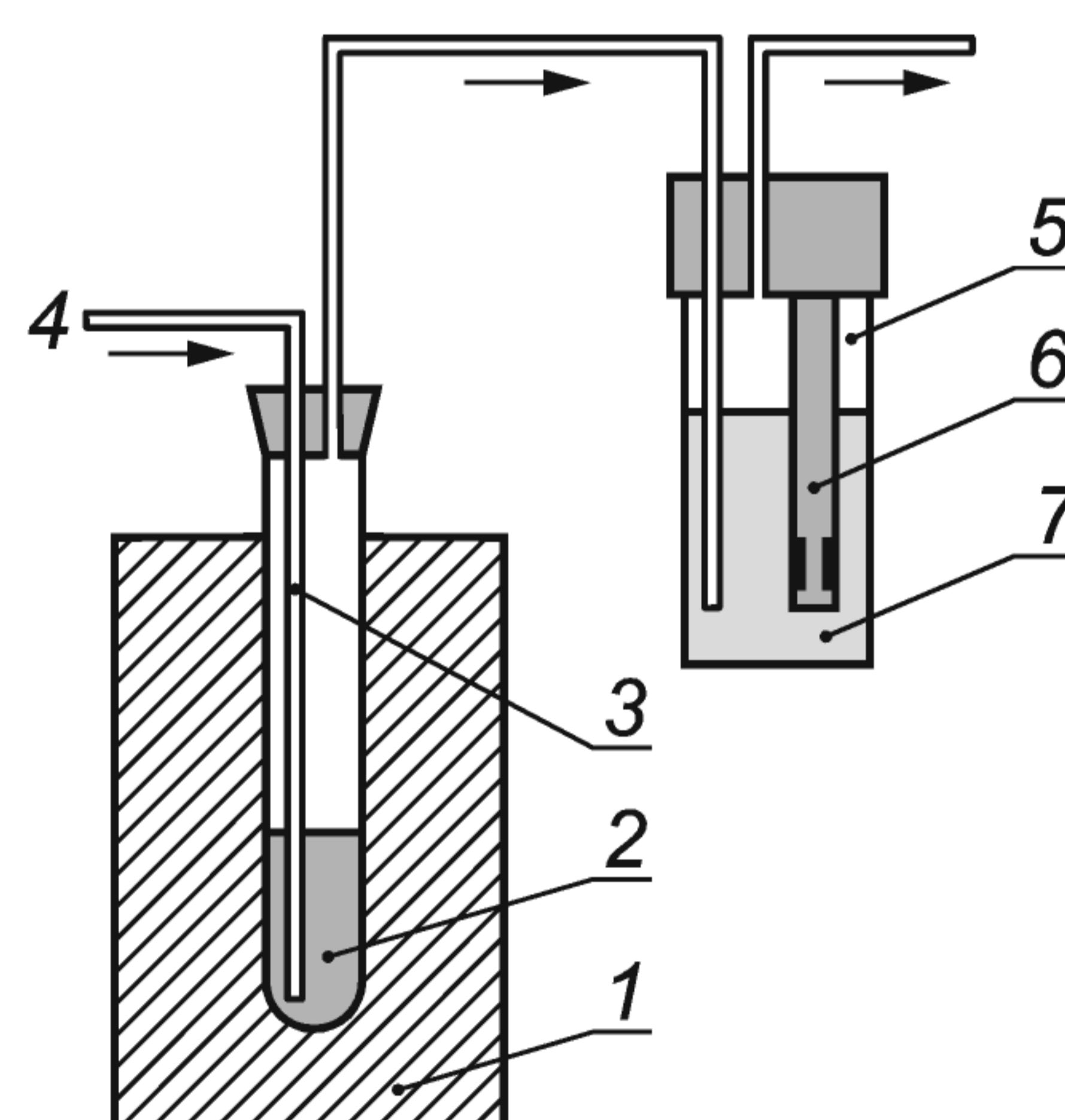
1 — нагревательный блок; 2 — образец; 3 — реактор; 4 — воздух; 5 — сосуд для измерения; 6 — электрод; 7 — раствор для измерения
