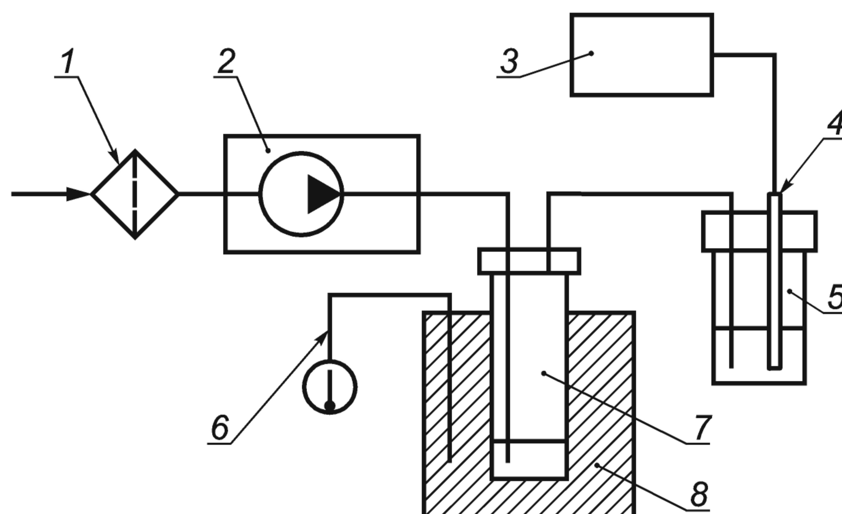
1 — воздушный фильтр (5.1.1); 2 — газовый диафрагменный насос с контролем скорости потока (5.1.2); 3 — аппаратура для измерения и регистрации (5.1.6); 4 — электрод (5.1.5); 5 — измерительная ячейка (5.1.4); 6 — тиристор и контактный термометр (5.1.7); 7 — реактор (5.1.3); 8 — нагревательный блок (5.1.8)
