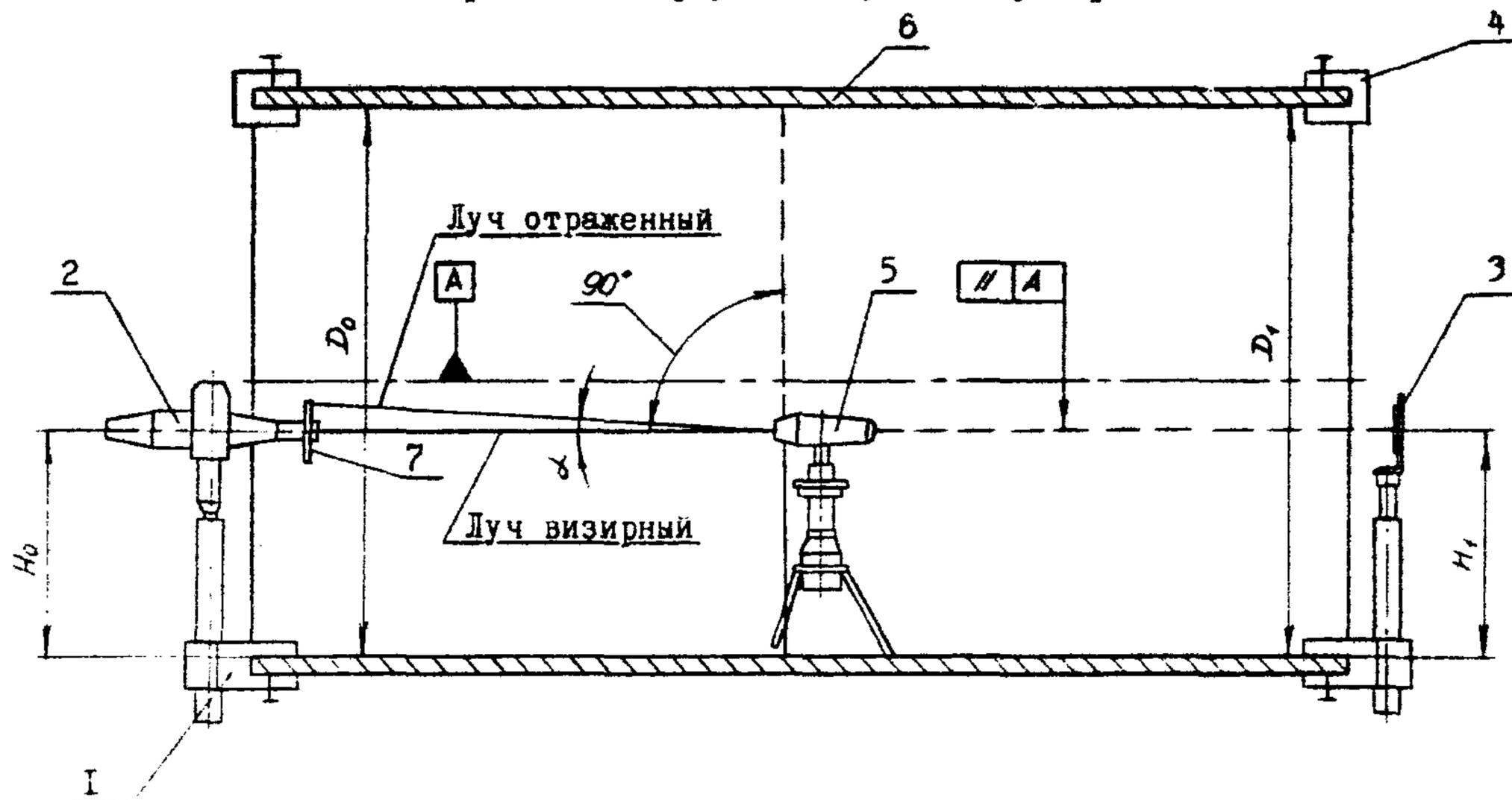
I-стойка; 2-лазерный визир; 3-мишень; 4-приспособление для натяжения струны; 5-разметчик оптический; 6-корпус; 7-экран
