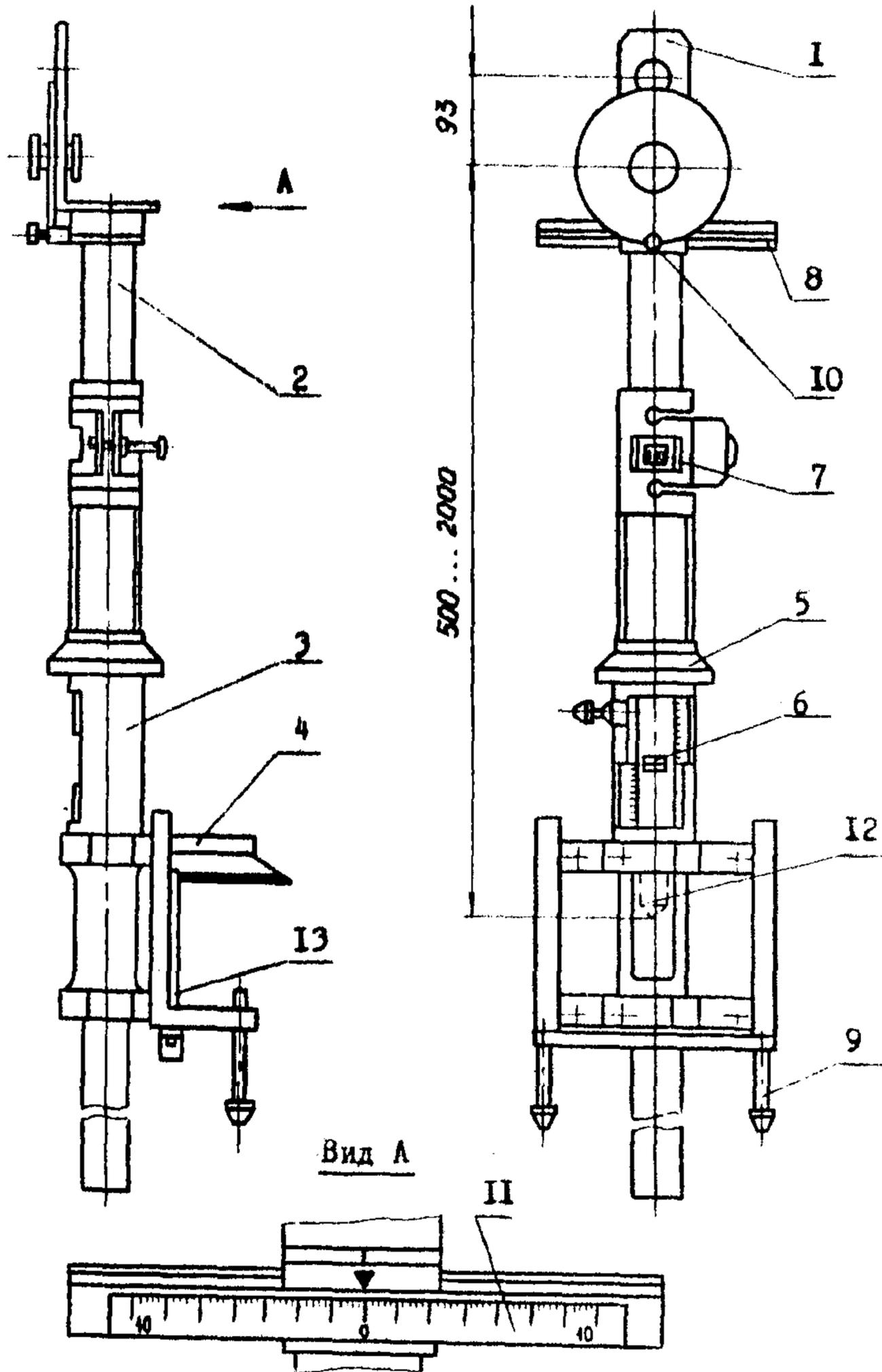
1-кронштейн; 2-штанга; 3-корпус; 4-струбцина; 5-гайка; 6-шкала; 7-линейка масштабная; 8-механизм горизонтального перемещения; 9-винт; 10-винт; 11-линейка; 12-установ; 13-упор
