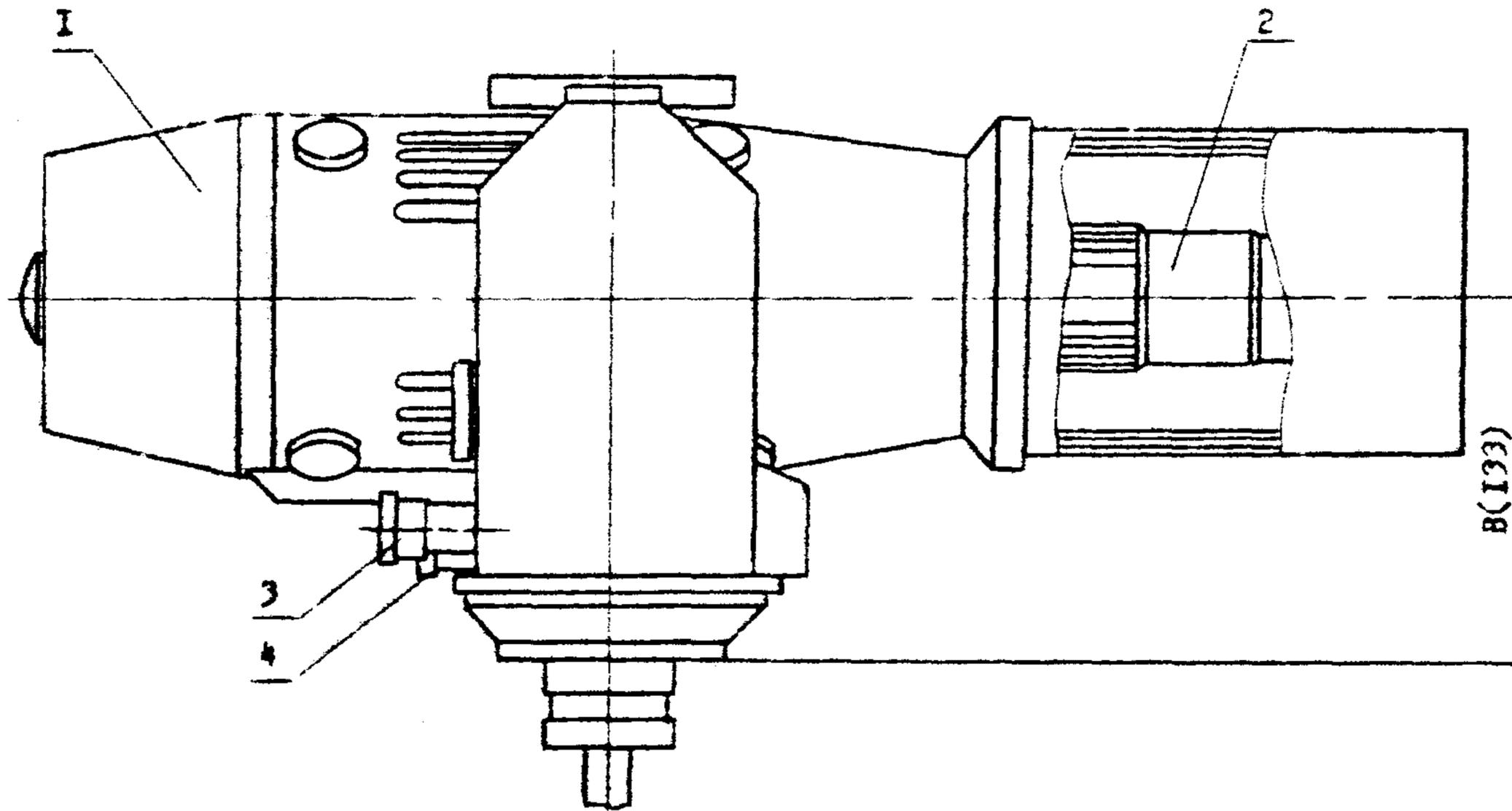
1-корпус; 2-коллиматор-интерферометр; 3-винт вертикального перемещения;
