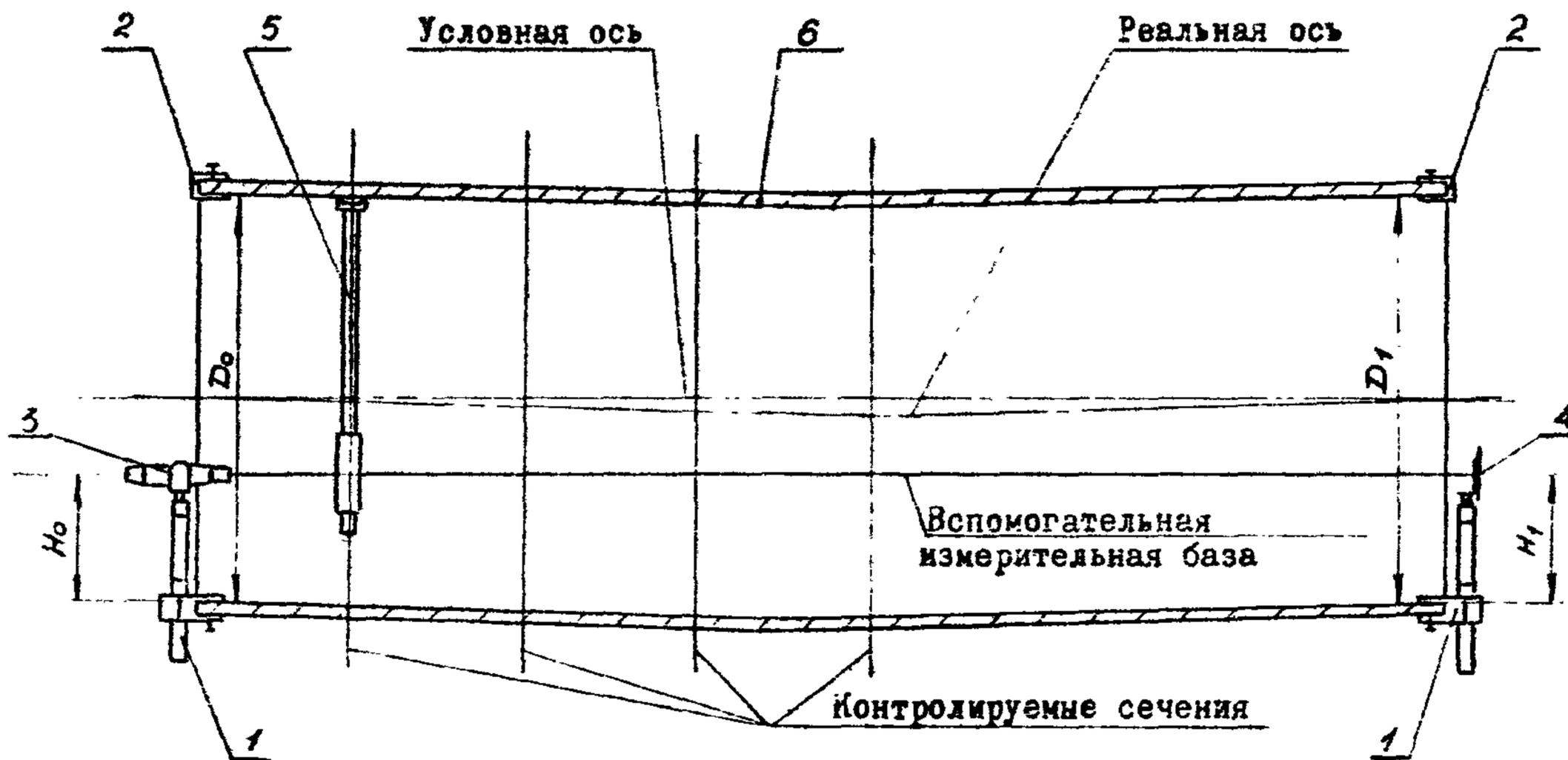
1-стойка; 2-приспособление для натяжения струны; 3-лазерный визир; 4-мишень;
