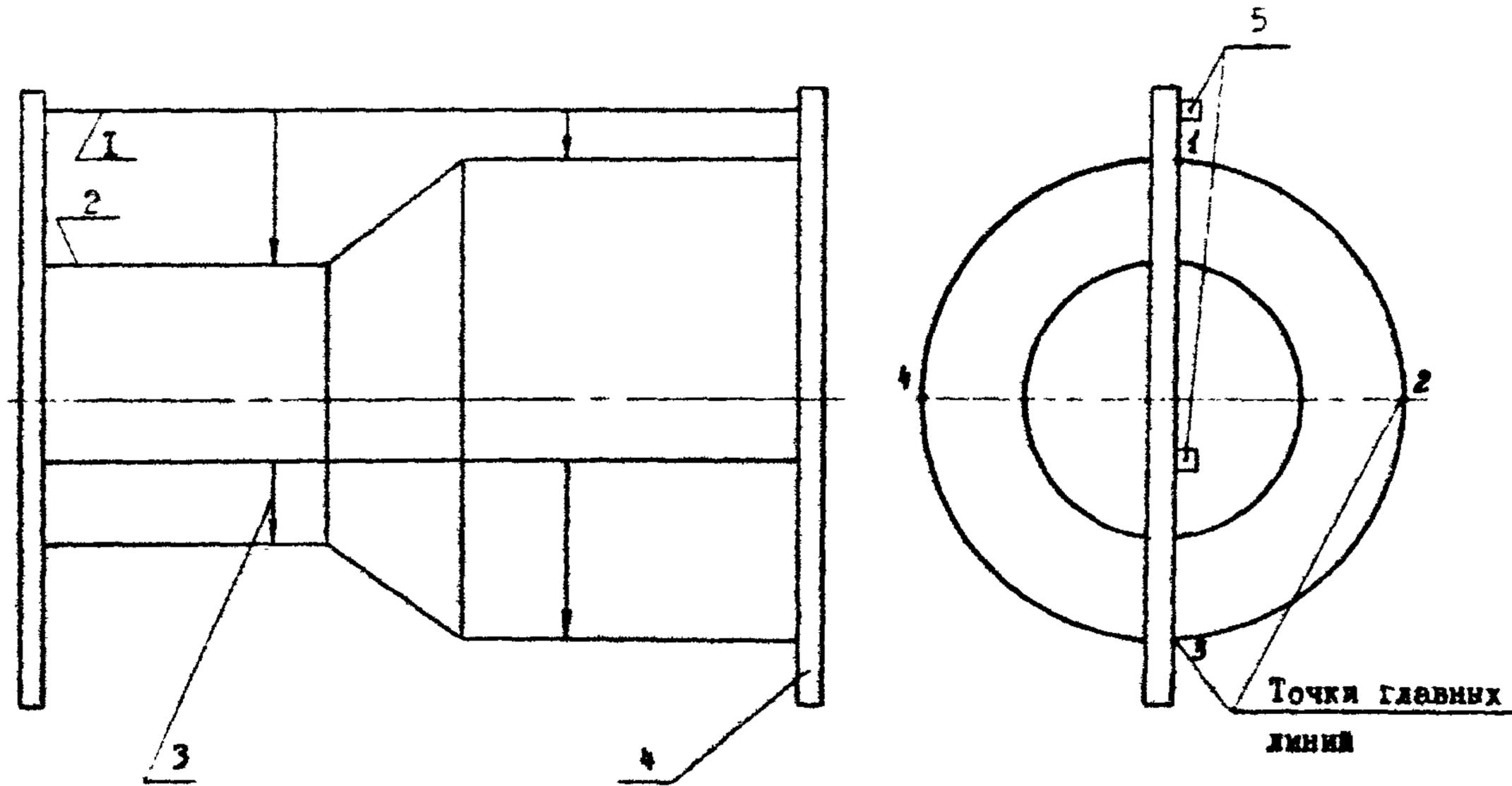
1-струна; 2-корпус; 3-отвес; 4-уголок; 5-приспособление для натяжения струны
