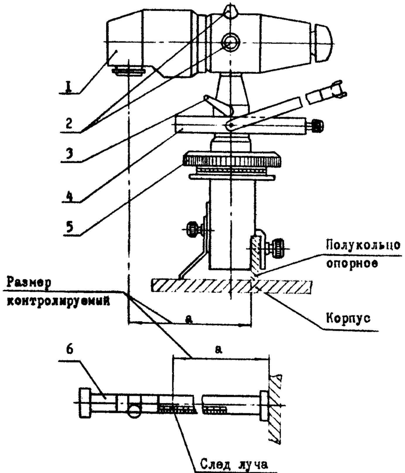
1-головка оптическая; 2-механизм выверки; 3-зажим;
