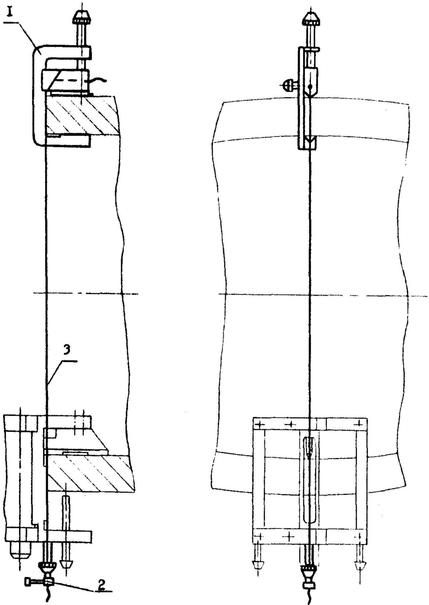
1-струбцина; 2-натяжное устройство; 3-струна
