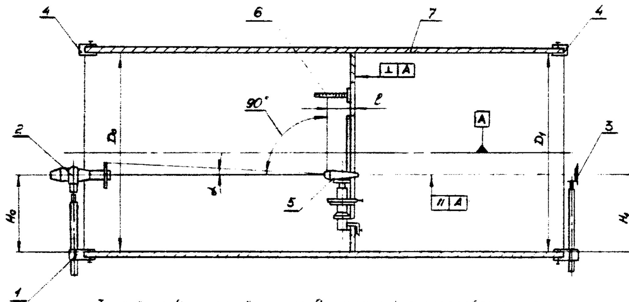
1-стойка; 2-лазерный визир; 3-мишень; 4-приспособление для
