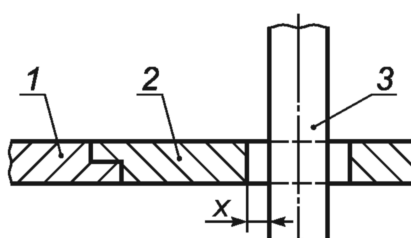
1 — стол; 2 — вставка стола; 3 — шпиндель режущего инструмента;
