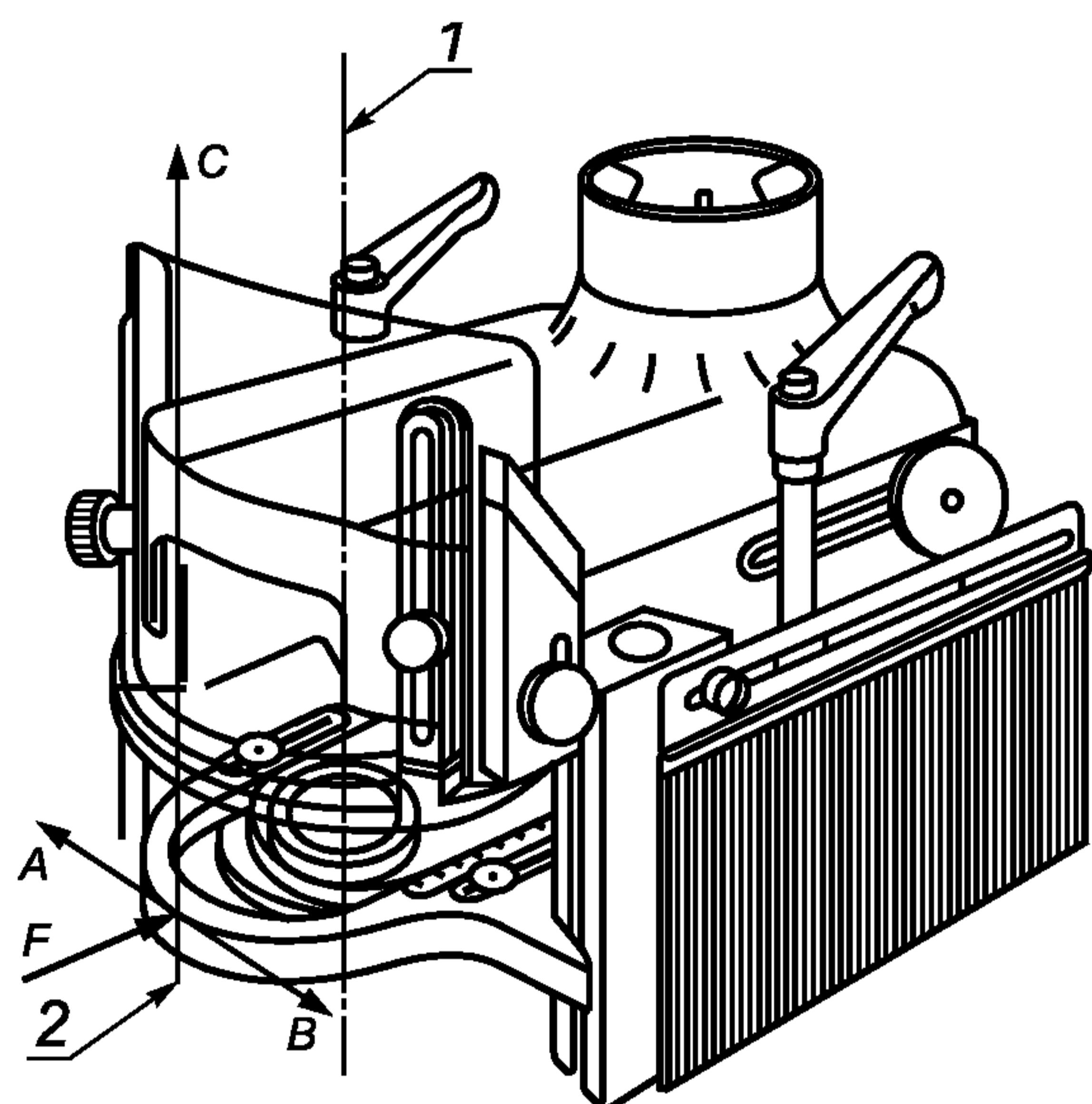
1 — ось шпинделя; 2 — точки приложения сил и измерения на направляющей опоре;
