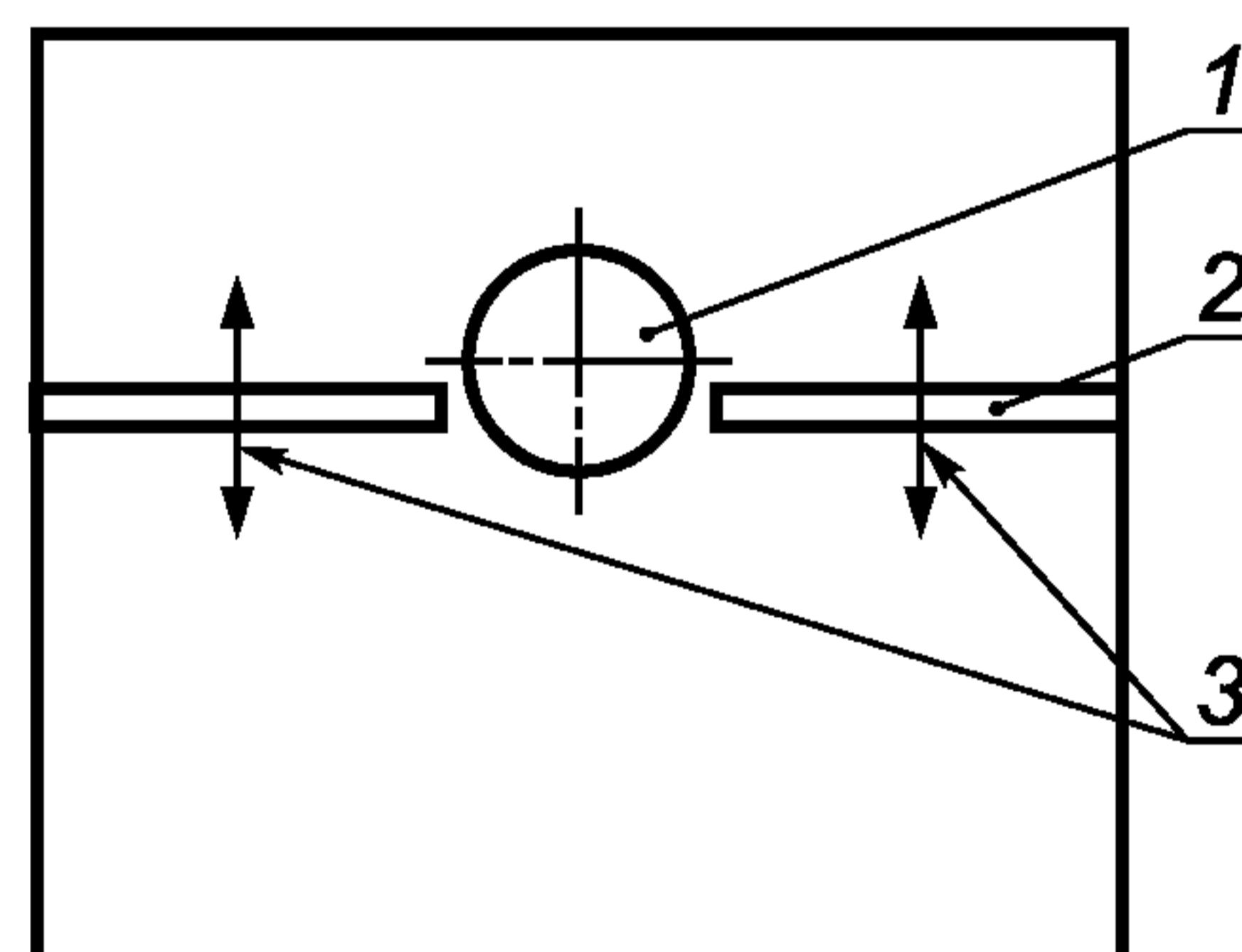
1 — режущий инструмент; 2 — направляющие упоры;
