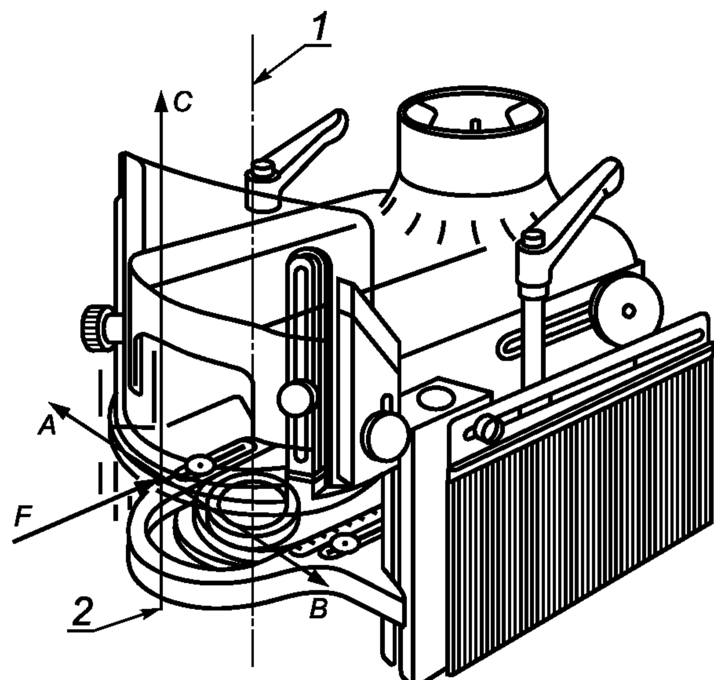
1 — ось шпинделя; 2 — точки приложения сил и измерения на регулируемом ограждении (защита рук);
