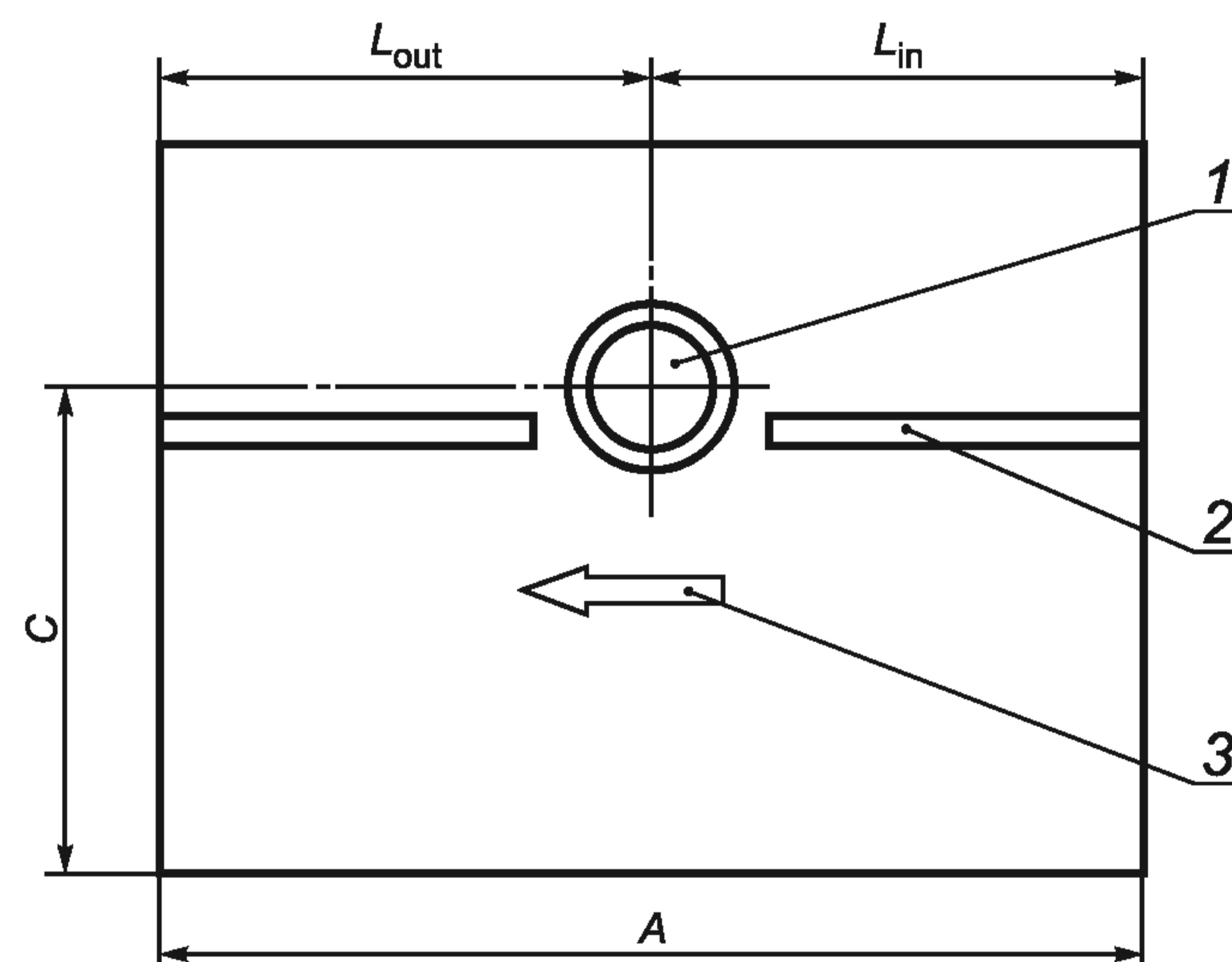
1 — отверстие стола; 2 — направляющая; 3 — направление подачи
