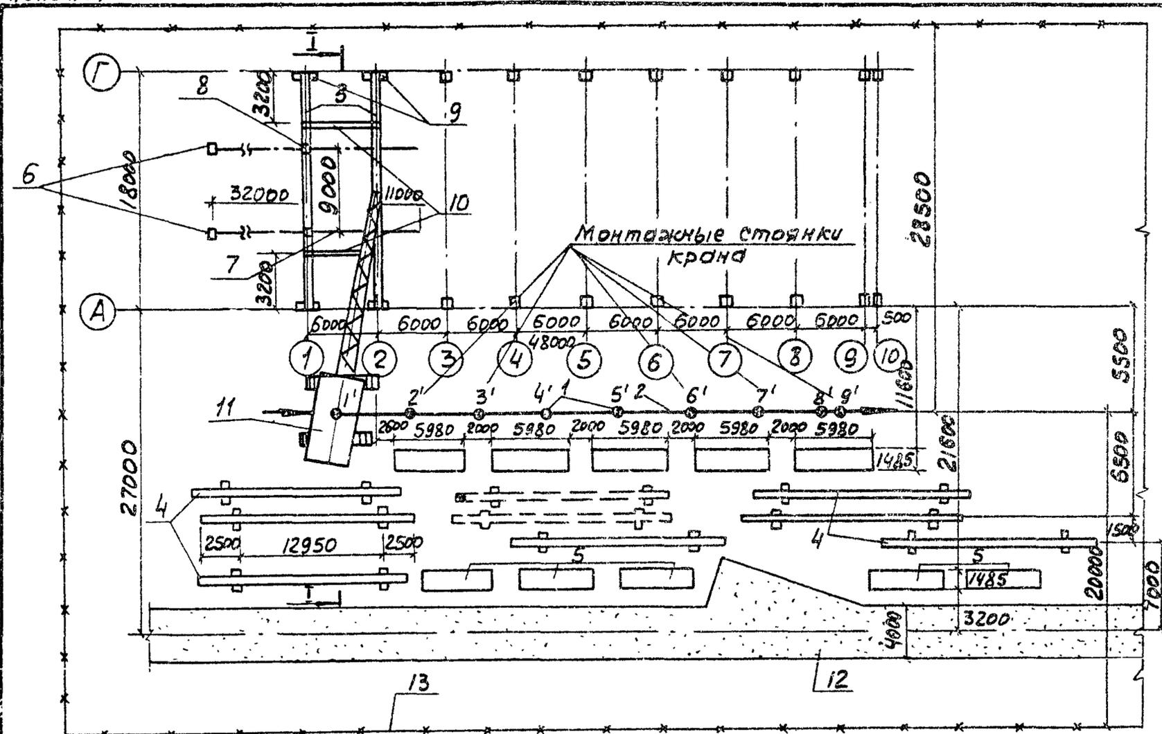
1-рабочие стоянки монтажного крана; 2-направление монтажа балок; 3-смонтированные балки покрытия; 4-складирование балок покрытия; 5-штабеля плит; 6-бетонные якоря; 7-расчалка; 8-место крепления расчалок; 9-инвентарные приставные лестницы; 10-инвентарные распорки; 11-гусеничный край СКГ-50; 12-временная автодорога; 13-временное ограждение; 14-траверса Q=100 кН. Альбом РЧ-455-69 ч. II 088.000.
