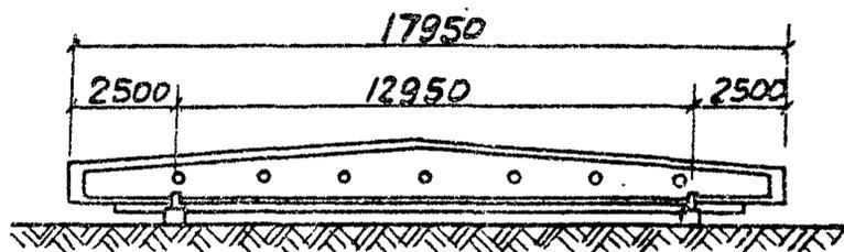
Рис. 4. Размещение опор при складировании
