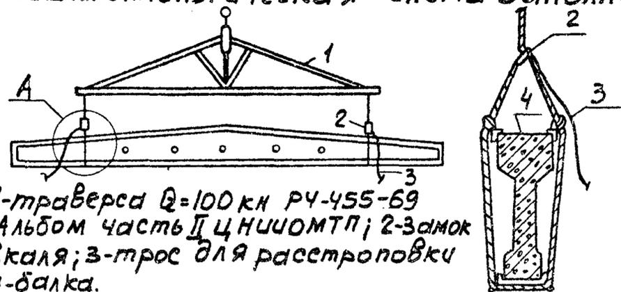
1-траверса Q=100 кН РЧ-455-69 Альбом часть II ЦНИИОМТП; 2-замок Скаля; 3-трос для расстроповки 4-балка.
