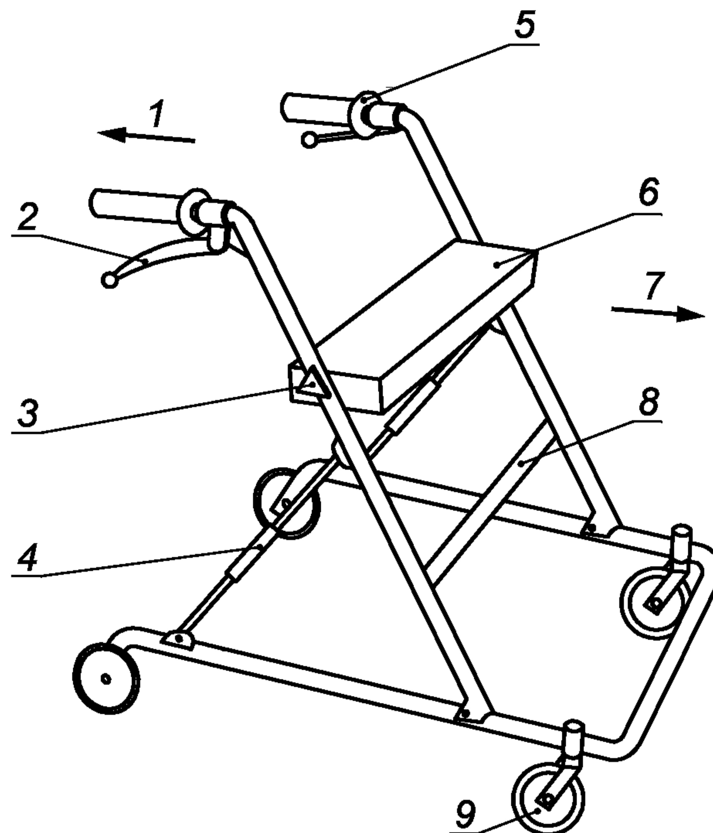
1 — направление назад; 2 — ручка тормоза; 3 — механизм регулирования высоты; 4 — механизм складывания;
