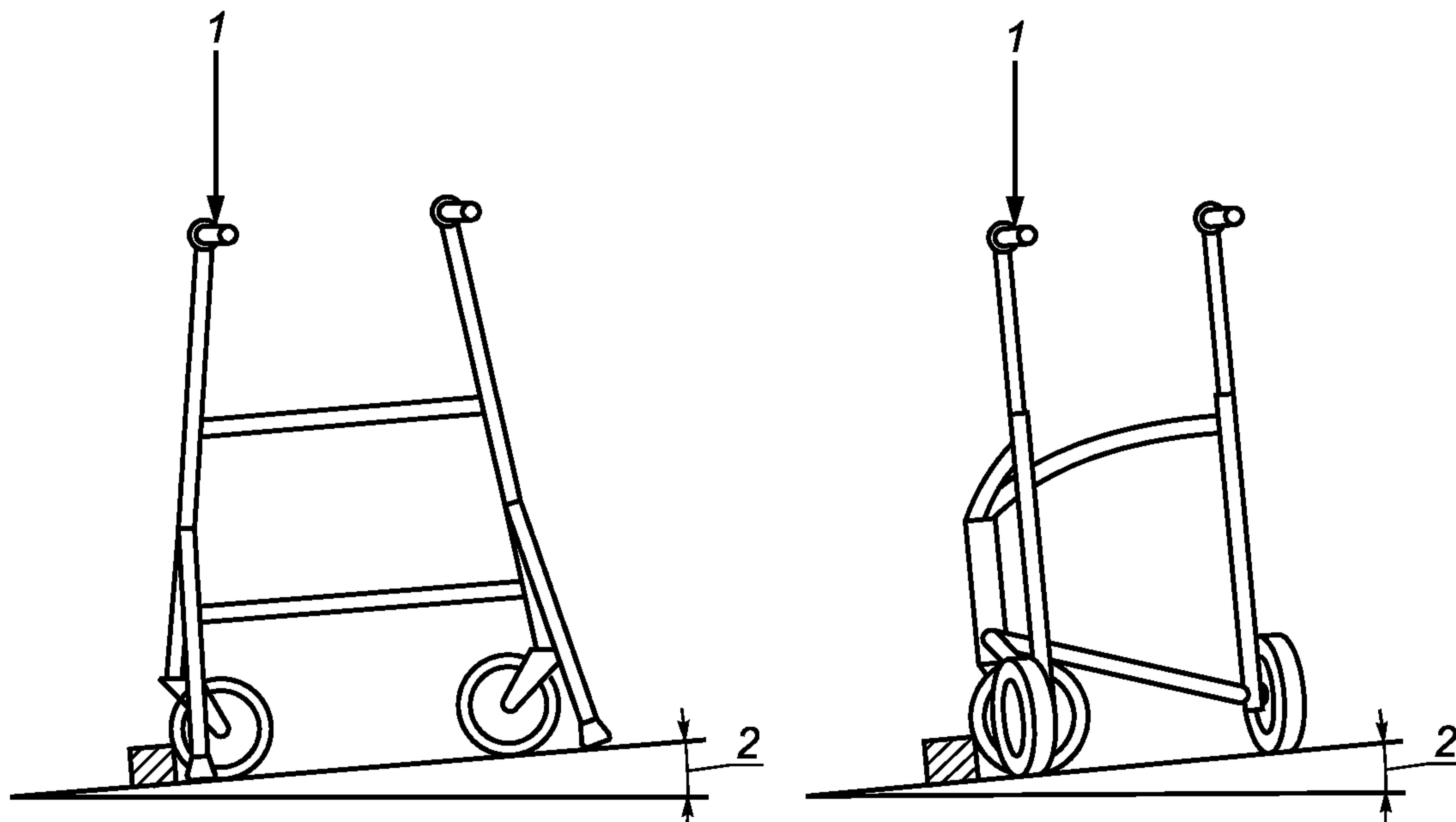
1 — нагрузка; 2 — угол наклона
