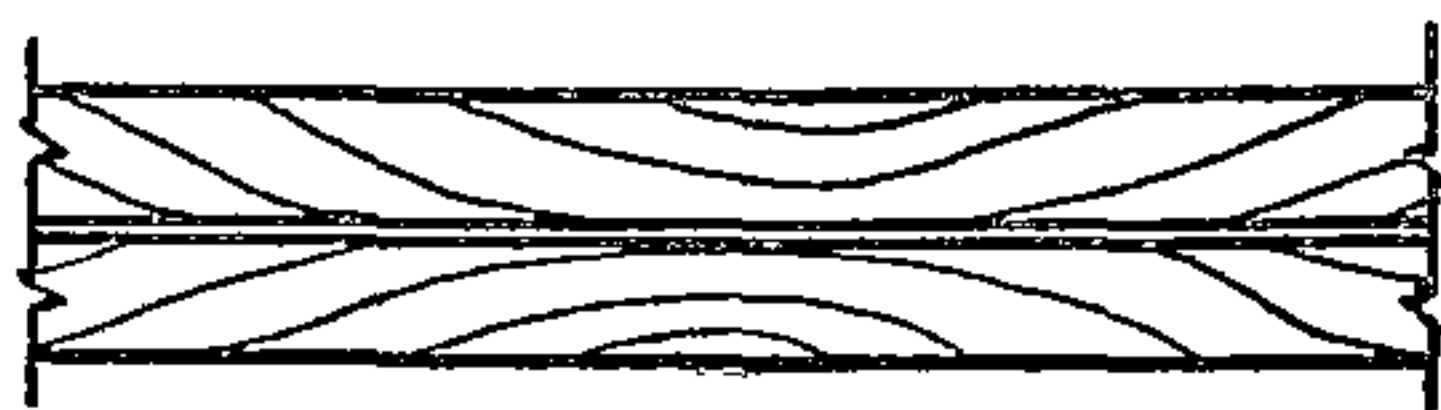
Рис. 35. Правильный способ сплачивания деревянных элементов
