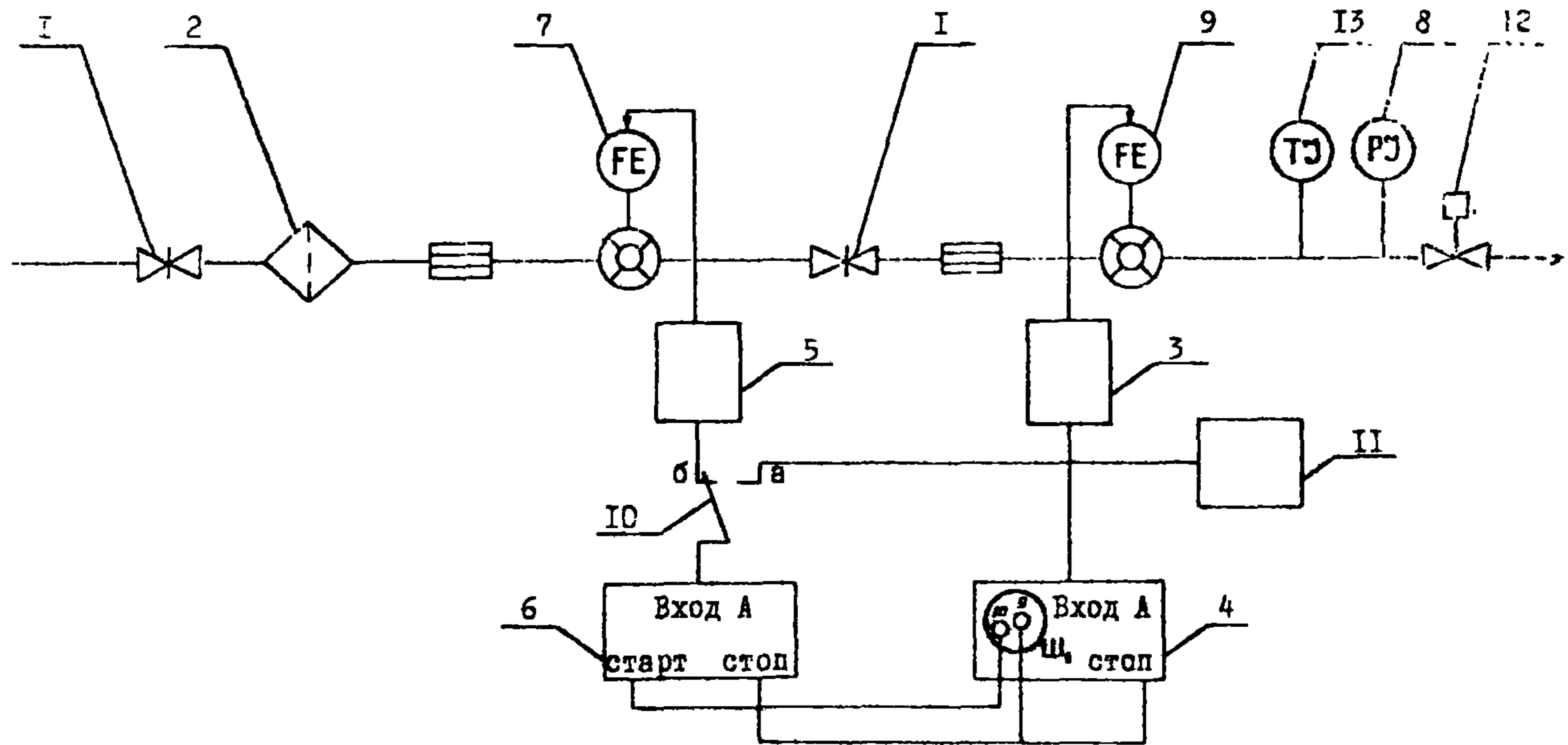
I-задвижки; 2-фильтр; 3,5-предусилители вторичные приборов турбинных счетчиков); 4,6-счетчики программные реверсивные; 7-рабочий преобразователь расхода с магнитоиндукционным передающим преобразователем; 8-манометр; 9-контрольный преобразователь расхода с магнитоиндукционным передающим преобразователем, по зренний по МИ224-80; 10-переключатель; II-частотомер; 12-устройство регулирования давления и расхода; 13-термометр.
