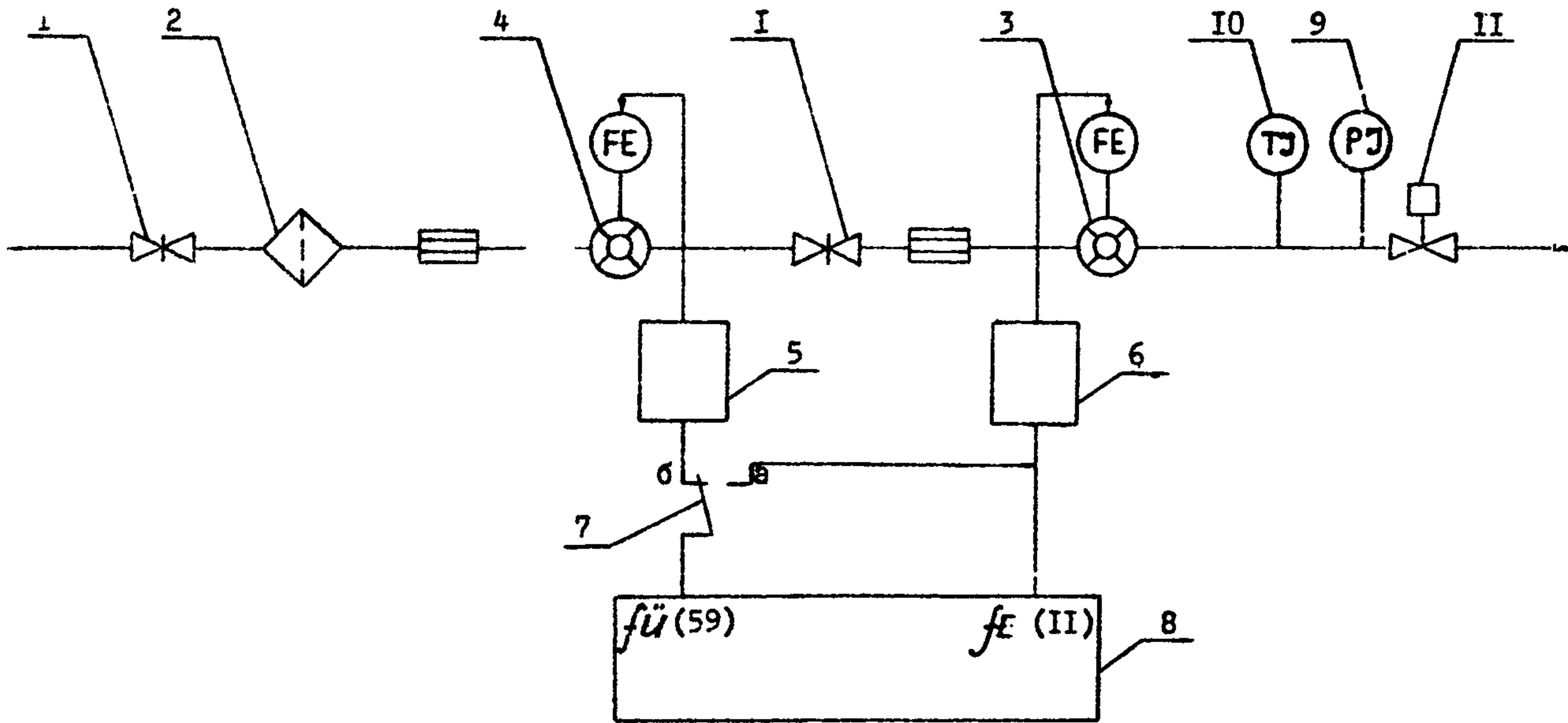
I-запорный; 2-фильтр; 3-контрольный преобразователь расхода с магнитоиндукционным передающим преобразователем, поверенный по МИ224-80; 4-рабочий преобразователь расхода с магнитоиндукционным передающим преобразователем; 5,6-предусилители; 7-переключатель; 8-прибор "УЛЬТРАКВАНТ"; 9-манометр; 10-термометр; II-устройство регулирования давления и расхода.
