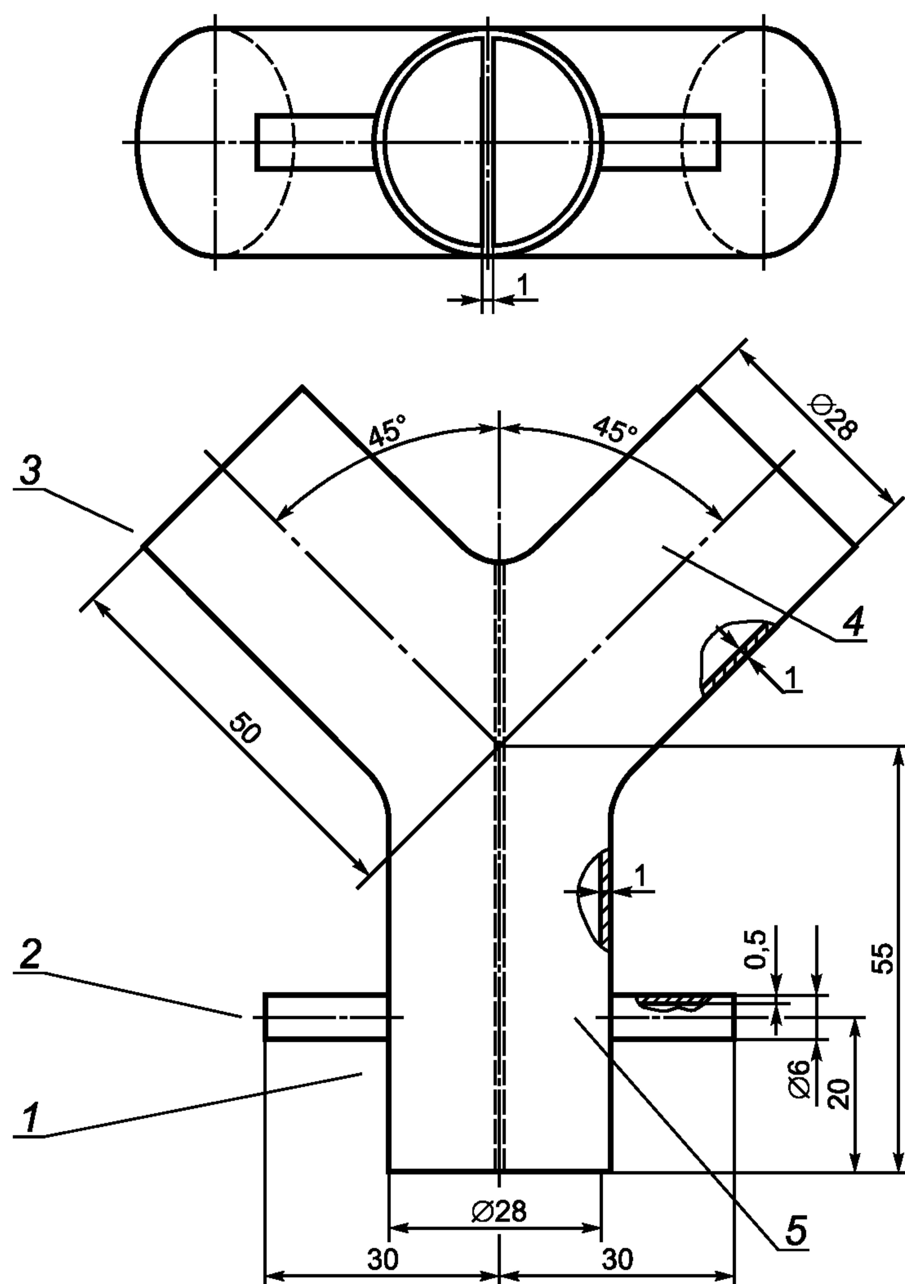
1 — выходной патрубок тройника; 2 — штуцер для присоединения тягонапоромера; 3 — патрубок, направленный к линии выдоха ИЛ; 4 — патрубок, направленный к линии вдоха ИЛ; 5 — штуцер для установки термоэлектрического преобразователя
