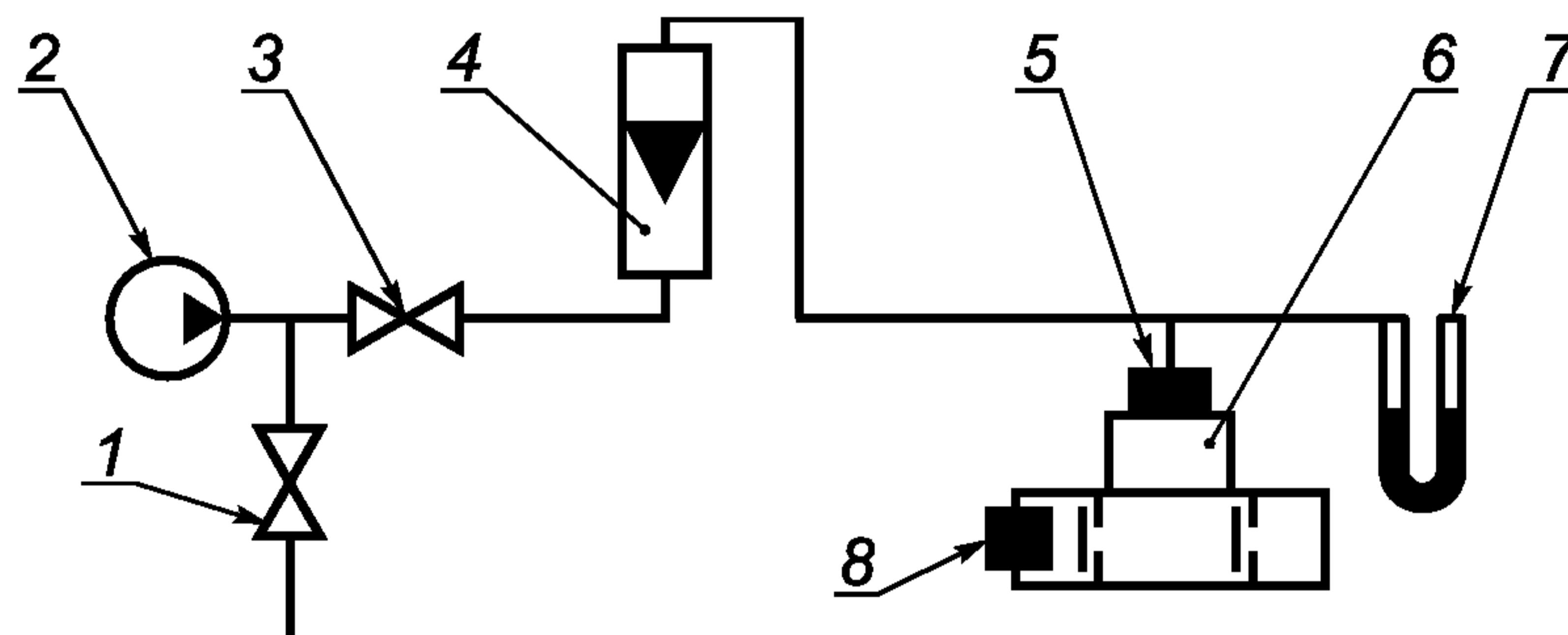
1, 3 — регулирующий вентиль; 2 — устройство подачи воздуха; 4 — расходомер с верхним пределом измерения 1 дм<sup>3</sup>/мин и относительной погрешностью не более ±2,5 %; 5 — присоединительное устройство; 6 — клапанная коробка; 7 — мановакуумметр с пределом измерения до 2500 Па и абсолютной погрешностью не более ±20 Па; 8 — пробка
