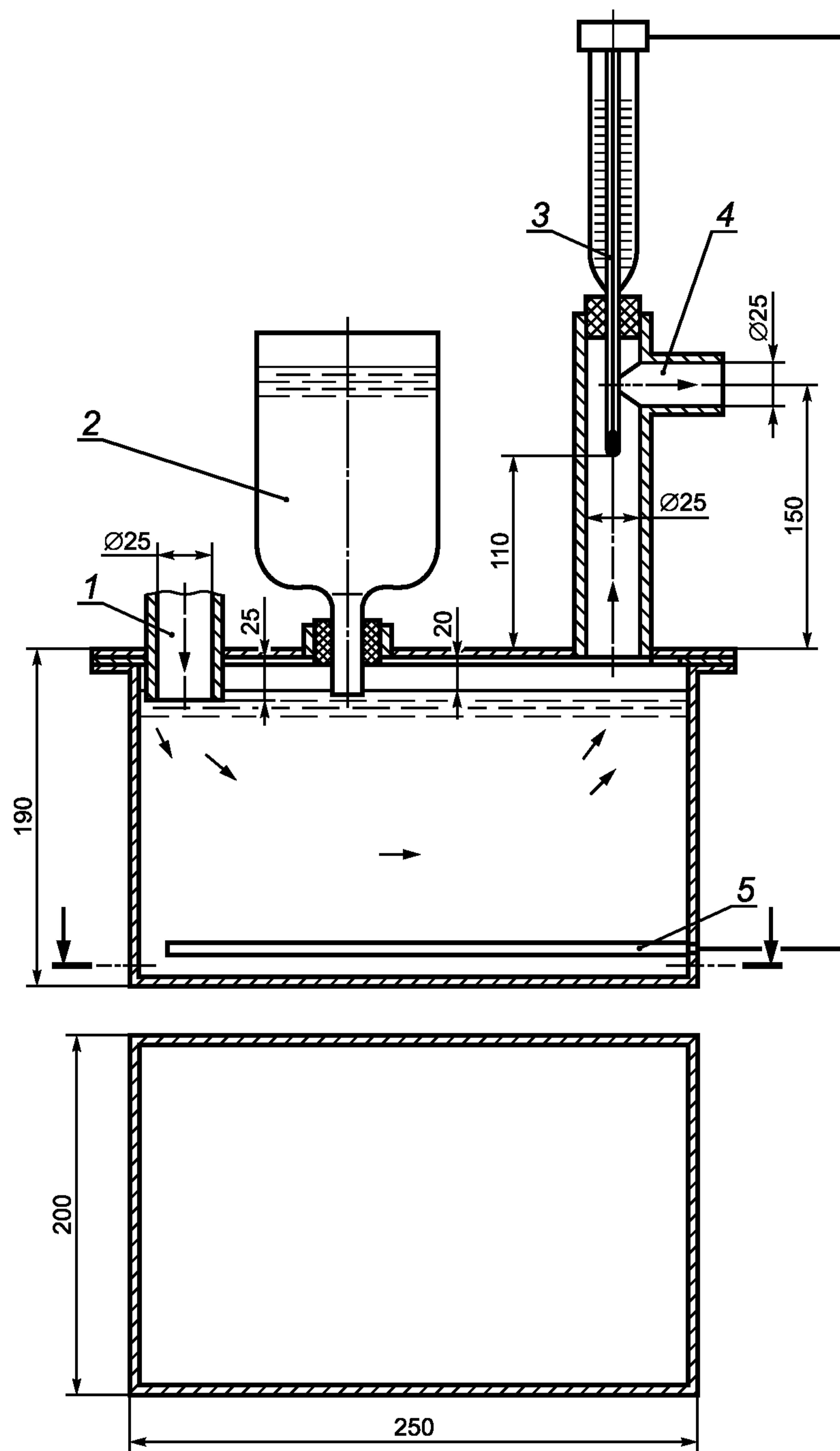
1 — штуцер, направленный к ИЛ; 2 — пополняющий резервуар; 3 — терморегулирующее устройство;
