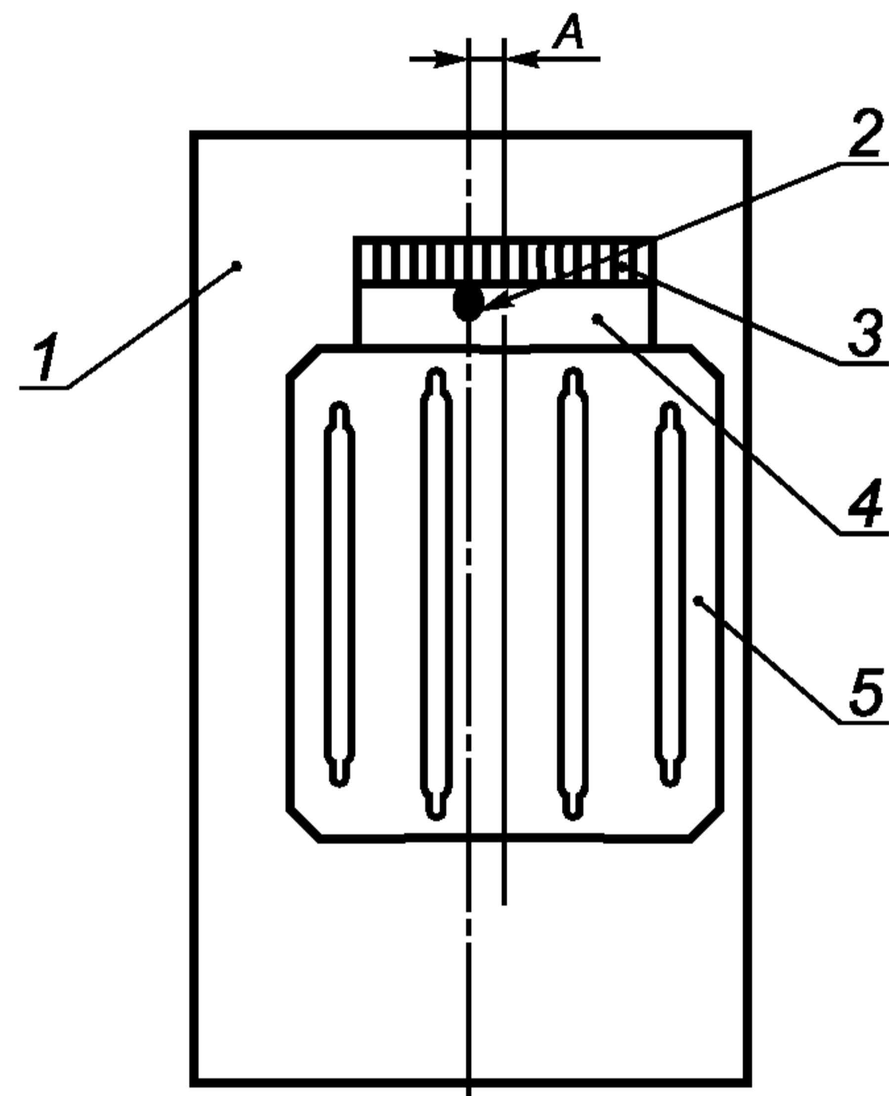
1 — щит; 2 — штырь; 3 — горизонтальная линейка; 4 — приспособление; 5 — аппарат
