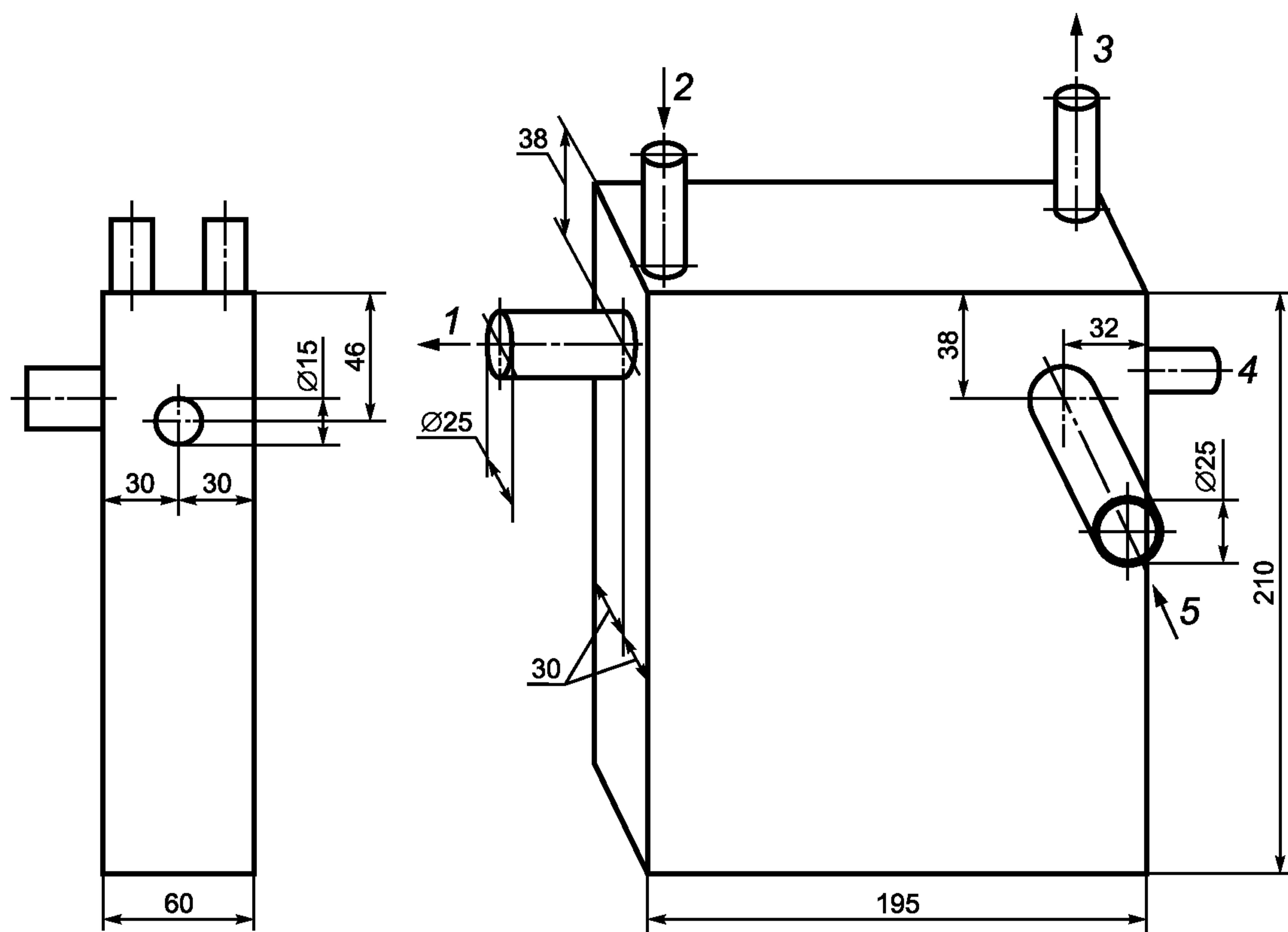
1 — штуцер, направленный к ИЛ; 2 — входное отверстие для охлаждающей воды; 3 — выходное отверстие для охлаждающей воды; 4 — штуцер, направленный к тройнику
