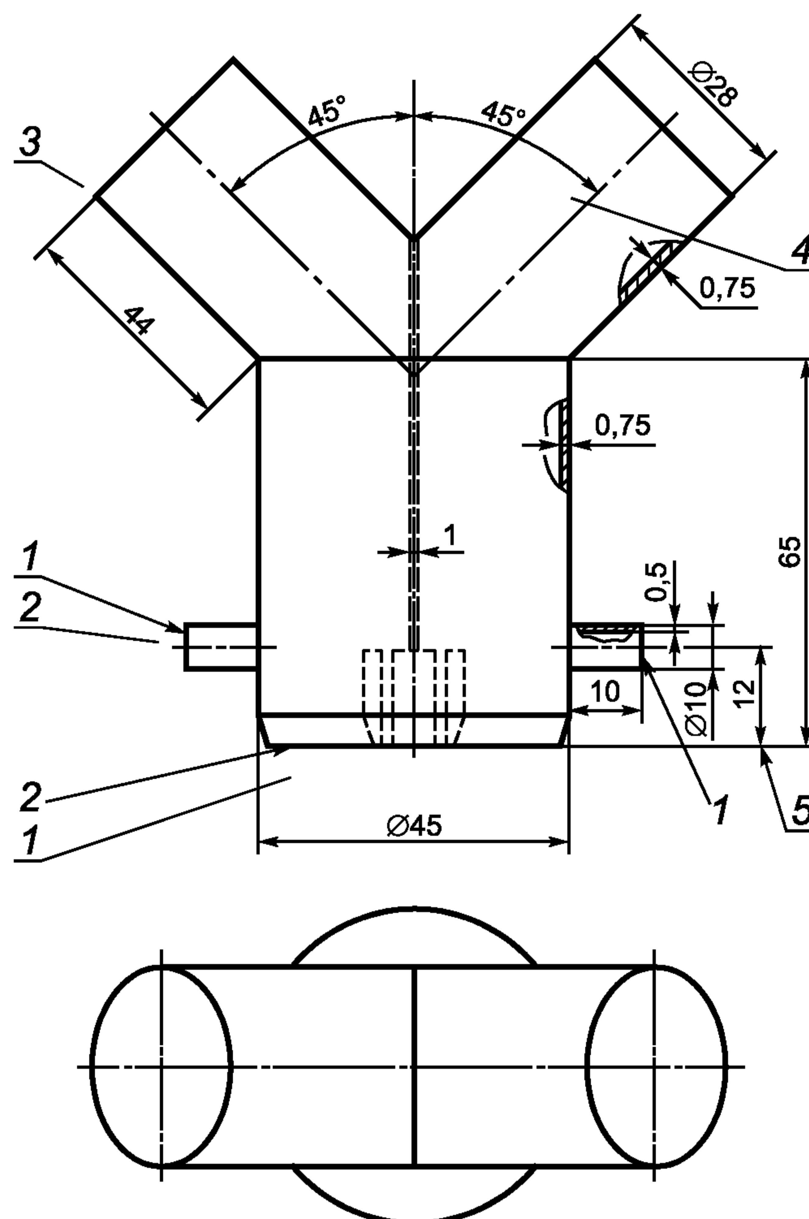
1 — выходной патрубок тройника; 2 — штуцер для присоединения тягонапоромера; 3 — патрубок, направленный к линии выдоха ИЛ; 4 — патрубок, направленный к линии вдоха ИЛ; 5 — штуцер для установки термоэлектрического преобразователя
