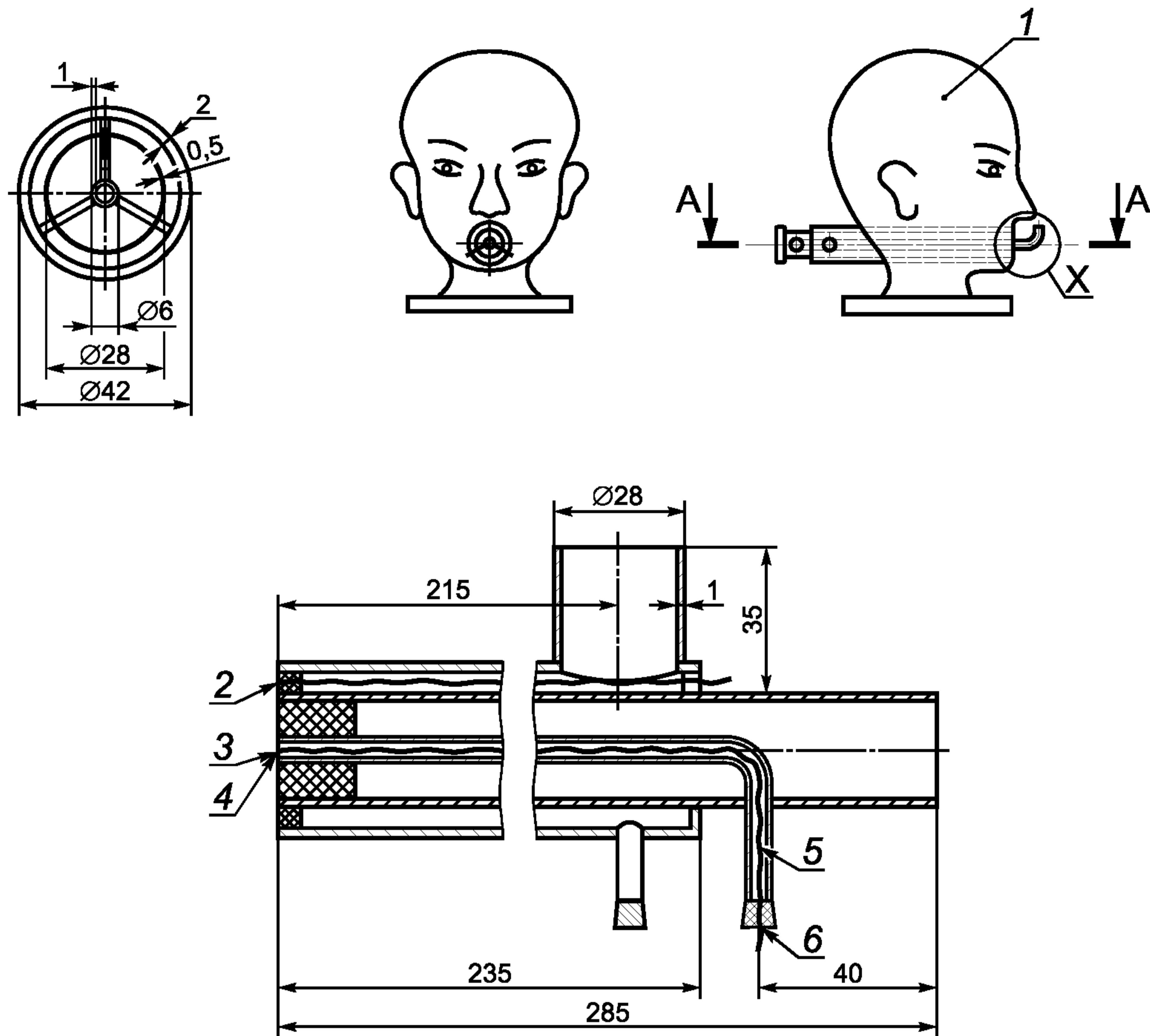
1 — макет головы (голова Шеффилда); 2 — точка измерения температуры на выдохе; 3 — точка измерения температуры на вдохе; 4 — точка измерения давления; 5 — термоэлектрический преобразователь; 6 — место подсоединения тягонапоромера
