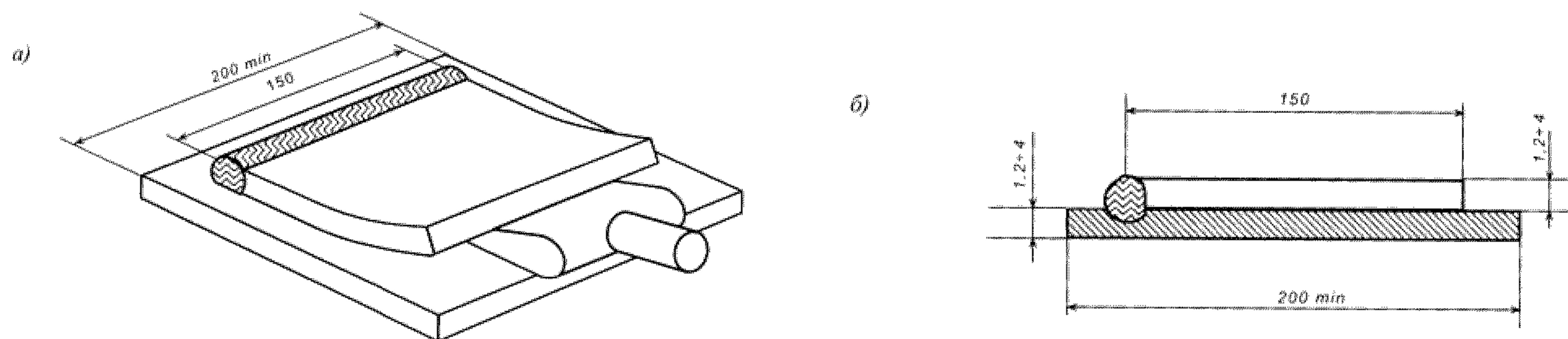
Рис. 2 Нахлесточная проба, испытываемая на разъединение пластин:
