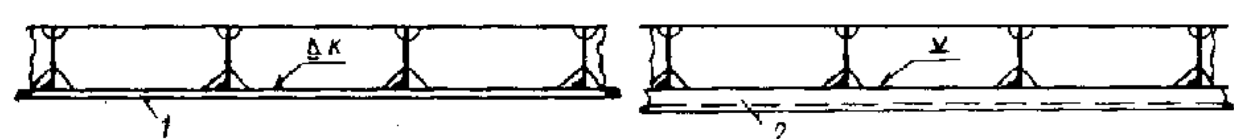
Рис. 2.3.6.1 Разносящие бортовые стингеры: 1 — поясок (полоса); 2 — поясок (бульб с участком стенки полособульба)
