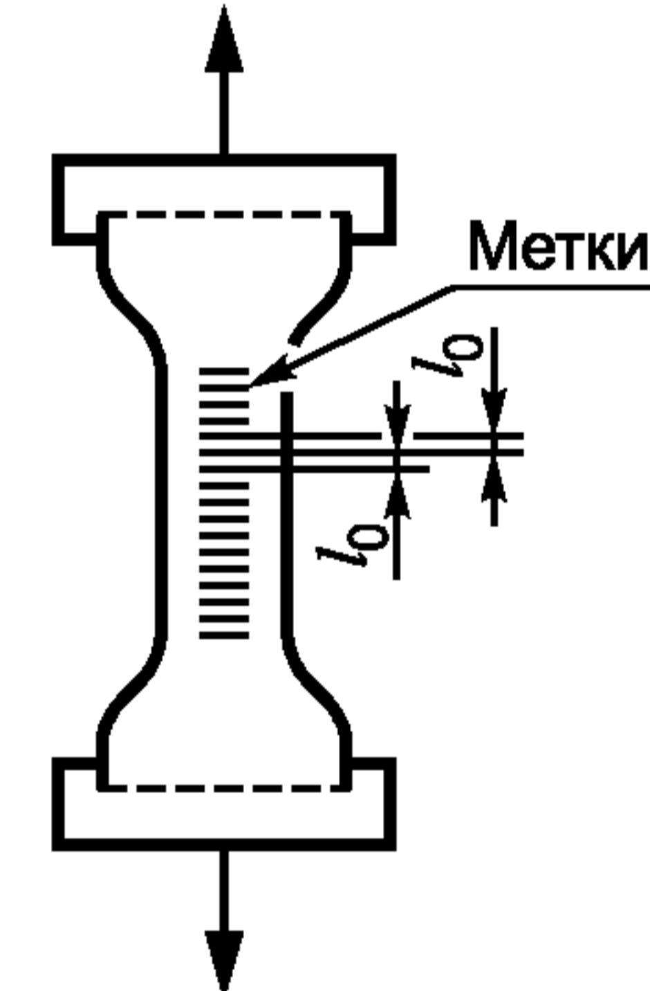
Рисунок 2 — Пример образца для испытаний (с нанесенными метками)
