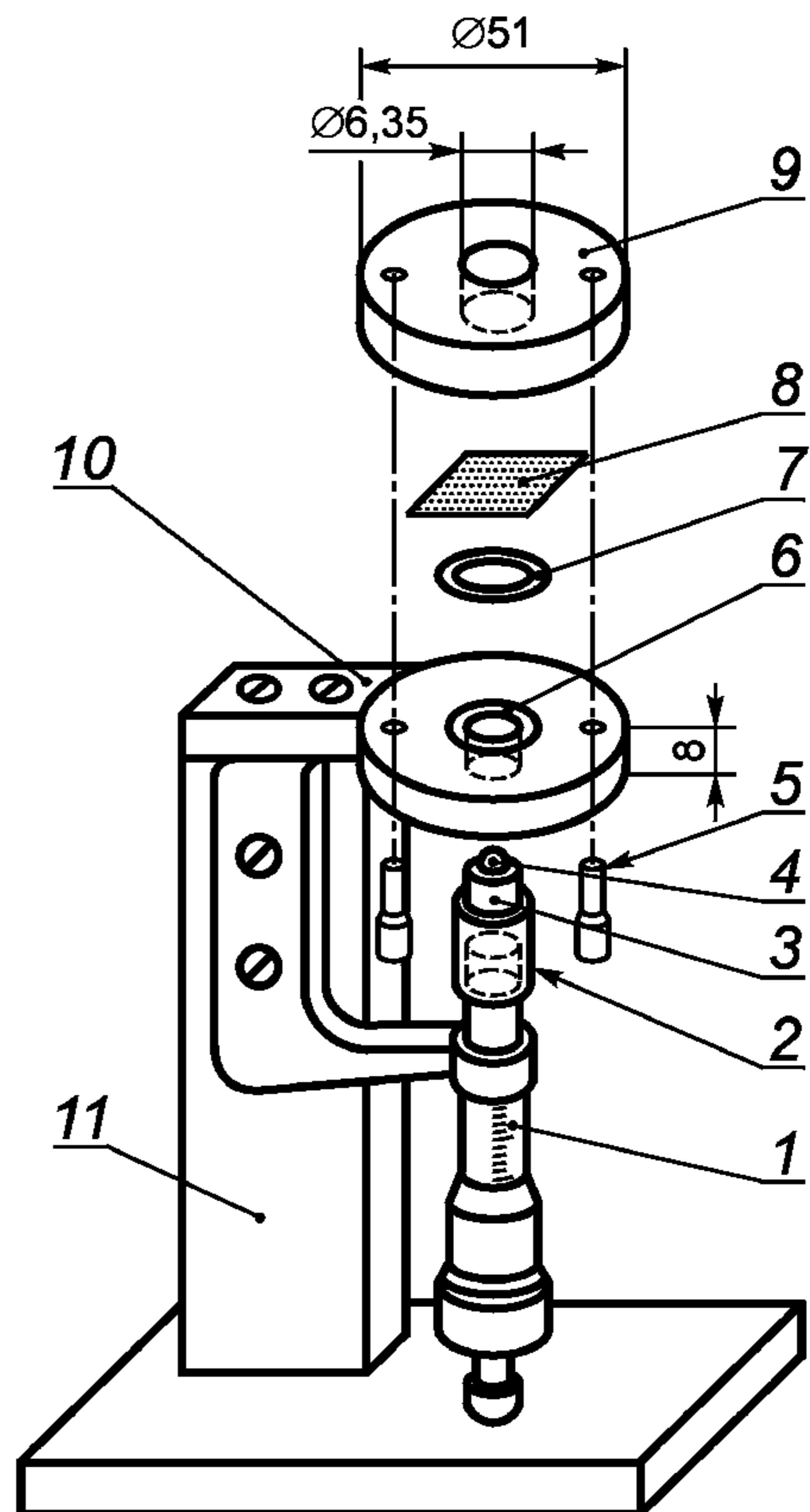
1 — микрометр; 2 — эпоксидная изоляция; 3 — шпиндельная надставка; 4 — стальной шарик; 5 — электрическая лампочка; 6 — паз; 7 — уплотнительное кольцо круглого сечения; 8 — испытуемый образец; 9 — верхняя пластина диаметром 51 мм, толщиной 8 мм с отверстием в центре диаметром 6,35 мм; 10 — нижняя пластина с отверстием в центре диаметром 6,35 мм; 11 — подставка
