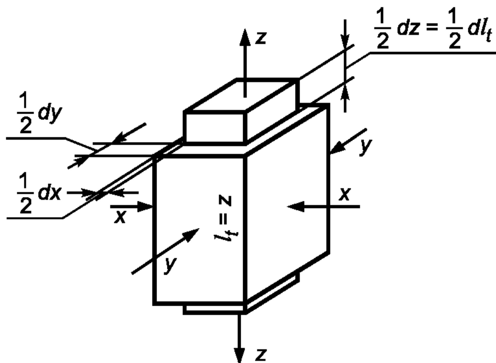
Рисунок B.1 — Схема для испытания на растяжение
