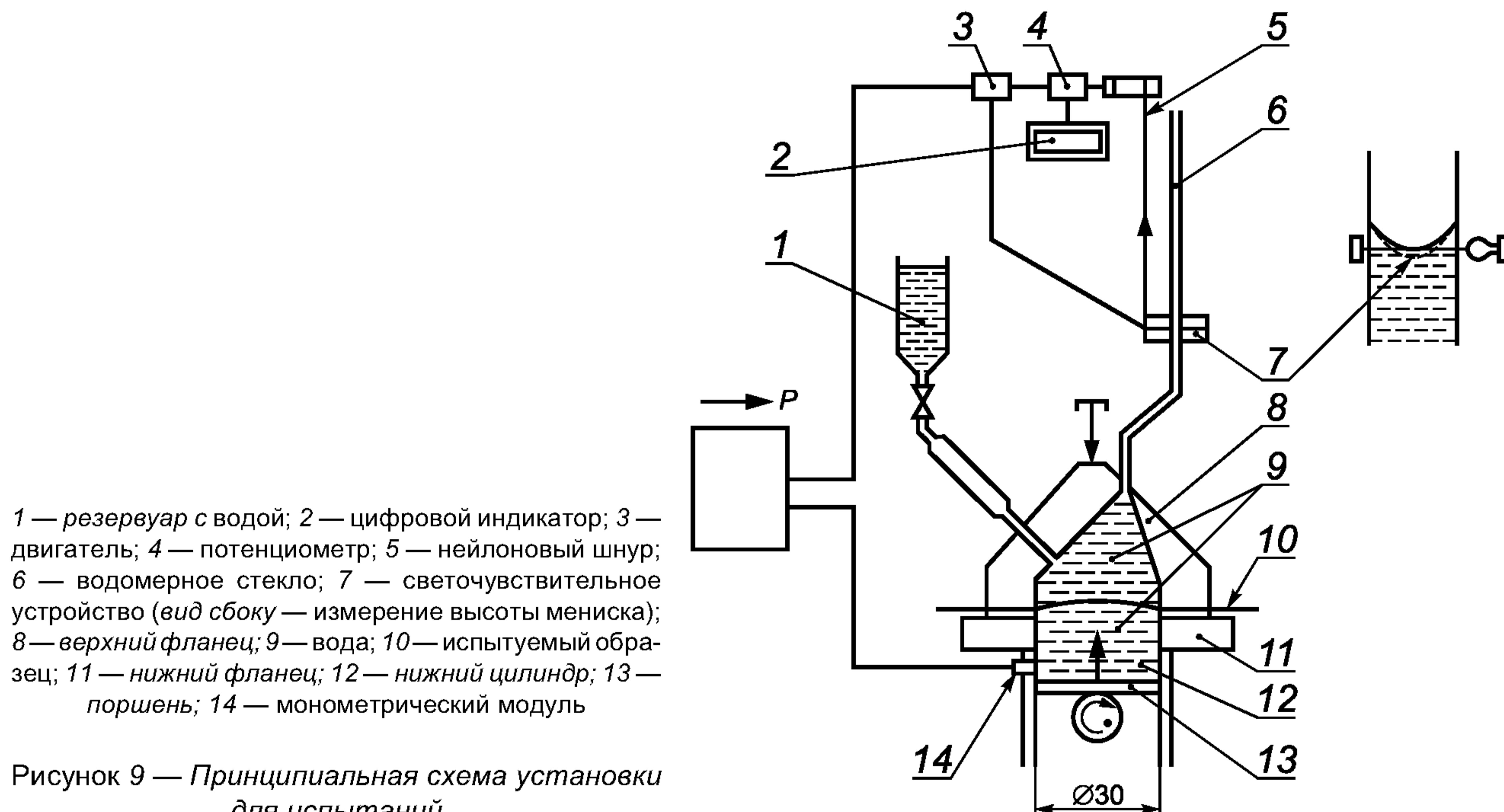
Рисунок 9 — Принципиальная схема установки для испытаний
