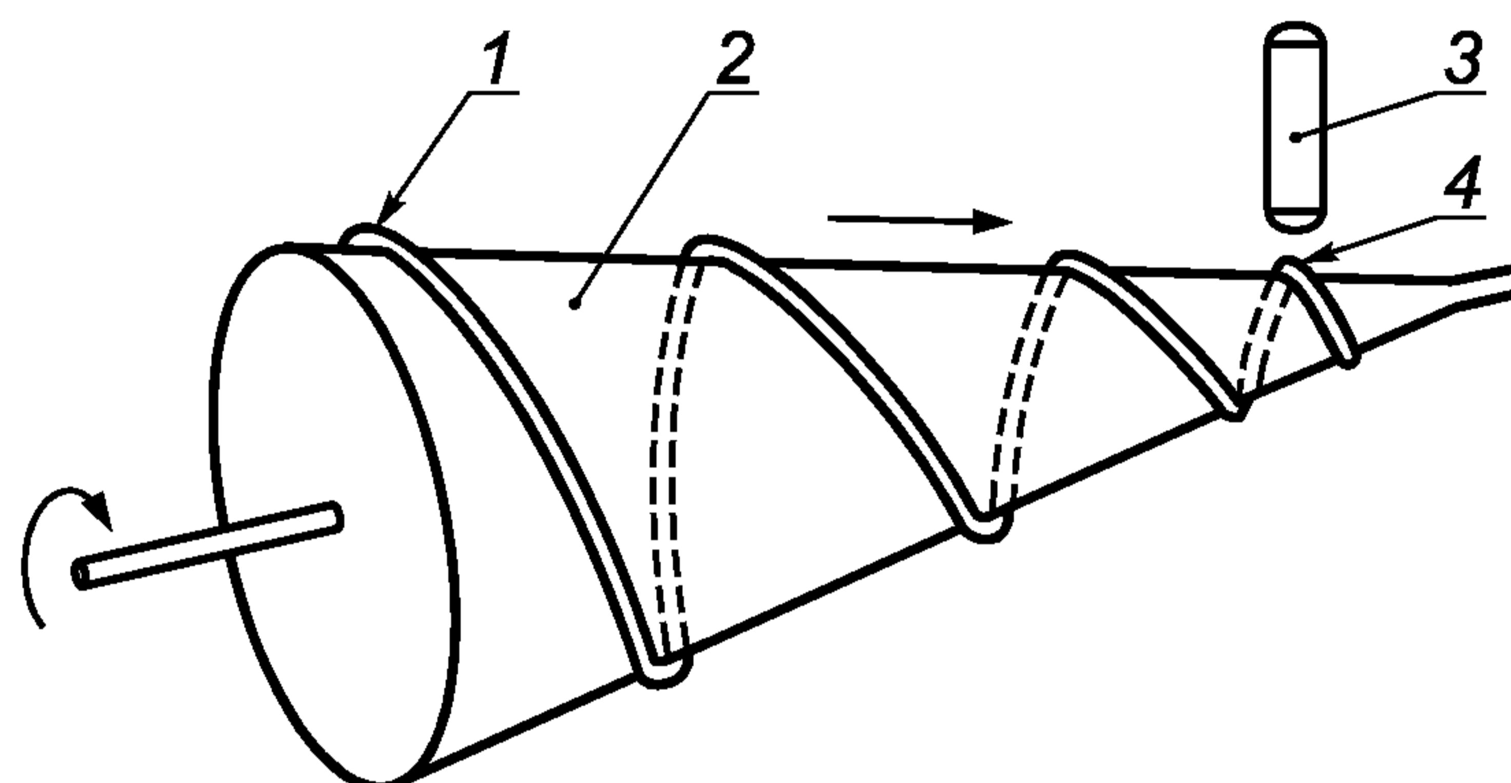
1 — медная проволока с испытуемым покрытием;
