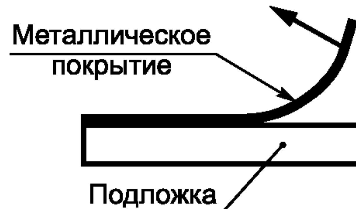
Рисунок 1 — Пример получения свободного покрытия
