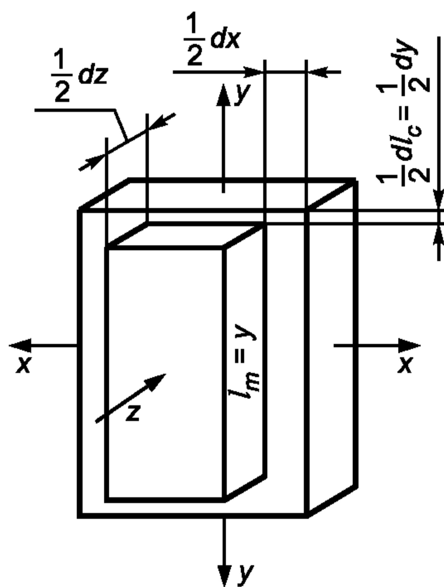
Рисунок B.2 — Схема для испытания на выдавливание
