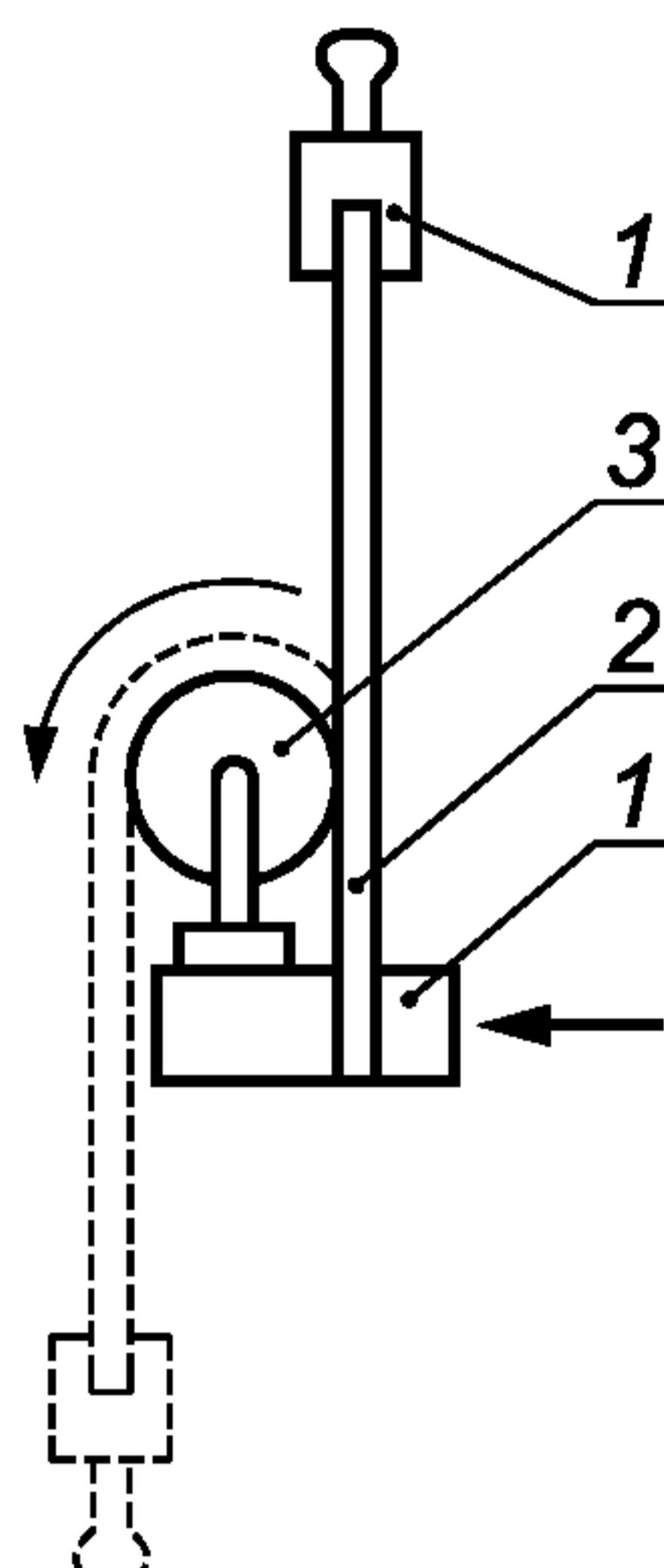
1 — захваты; 2 — испытуемый образец;
