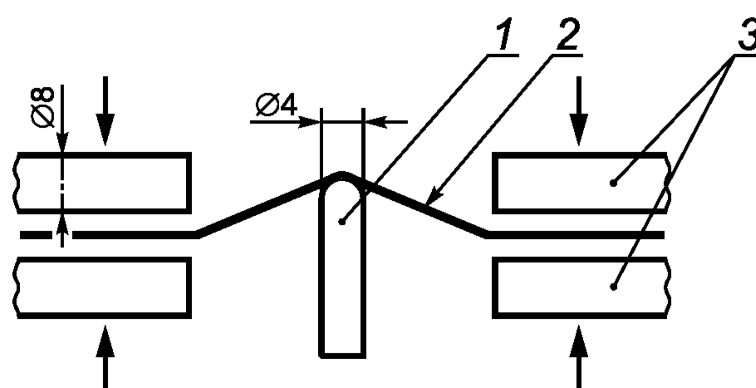
1 — оправка, например, шпиндельная надставка со стальным шариком; 2 — испытуемый образец; 3 — приспособление для крепления образца
