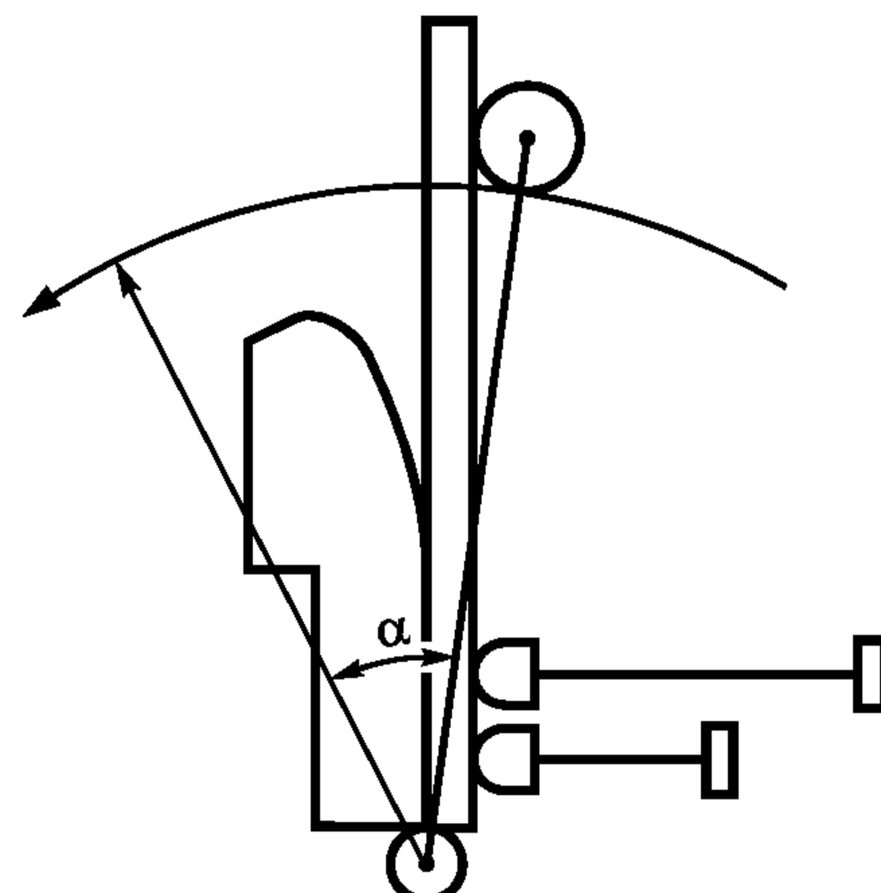
Рисунок 22 — Угол отклонения рычага ( $\alpha$ )
