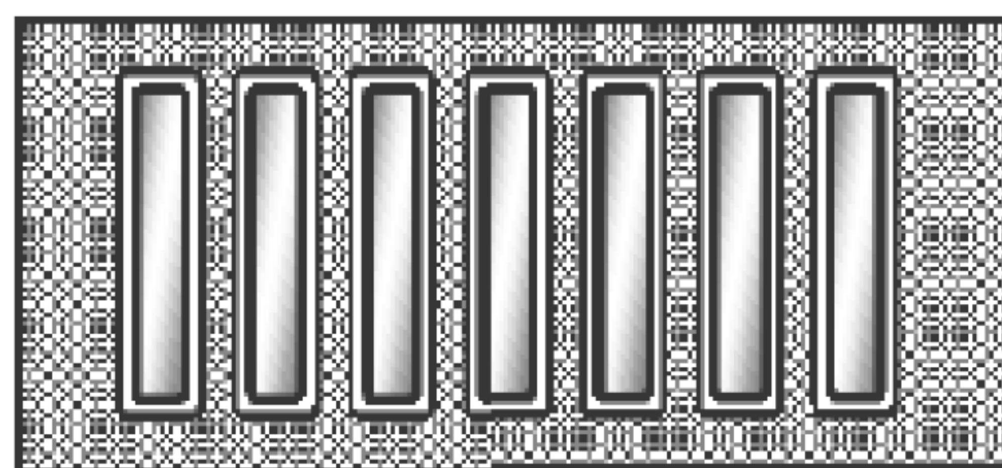
Контактные площадки, разделенные барьером из паяльной маски для корпусов ИС с мелким шагом выводов
