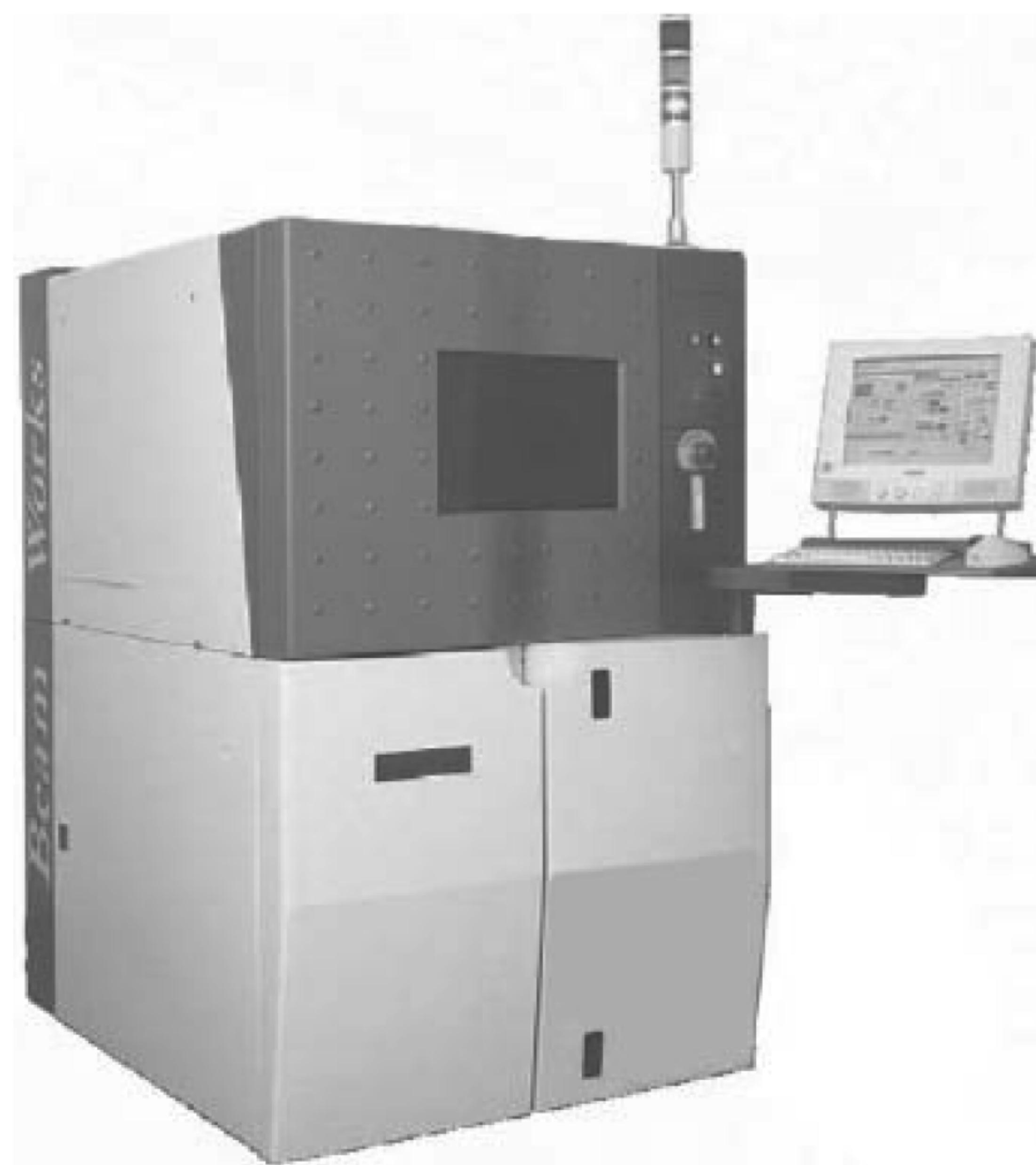
Рисунок 10 — Автоматическое лазерное оборудование для оплавления
