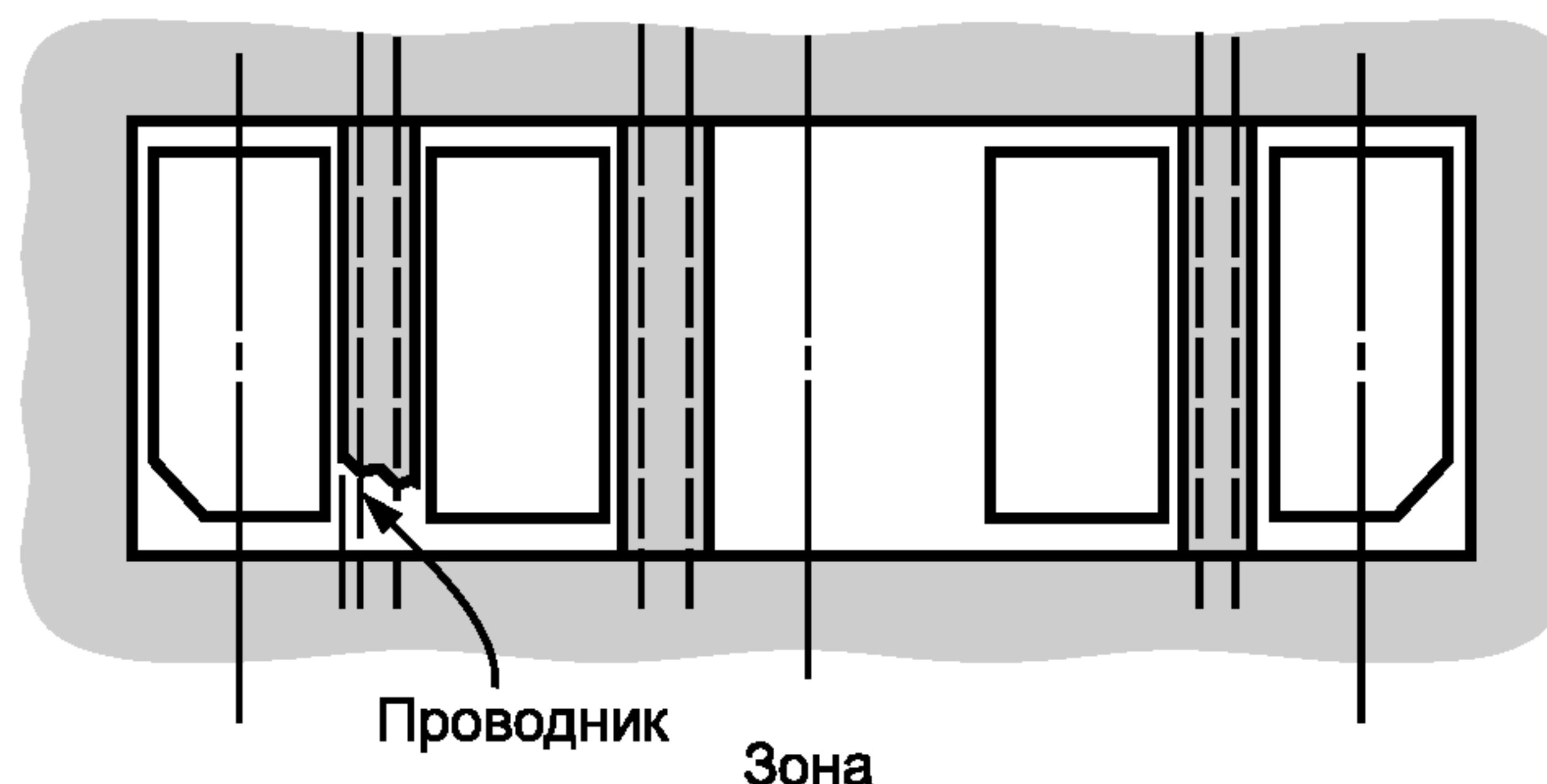
Рисунок 3 — Проводник между контактными площадками с малым шагом
