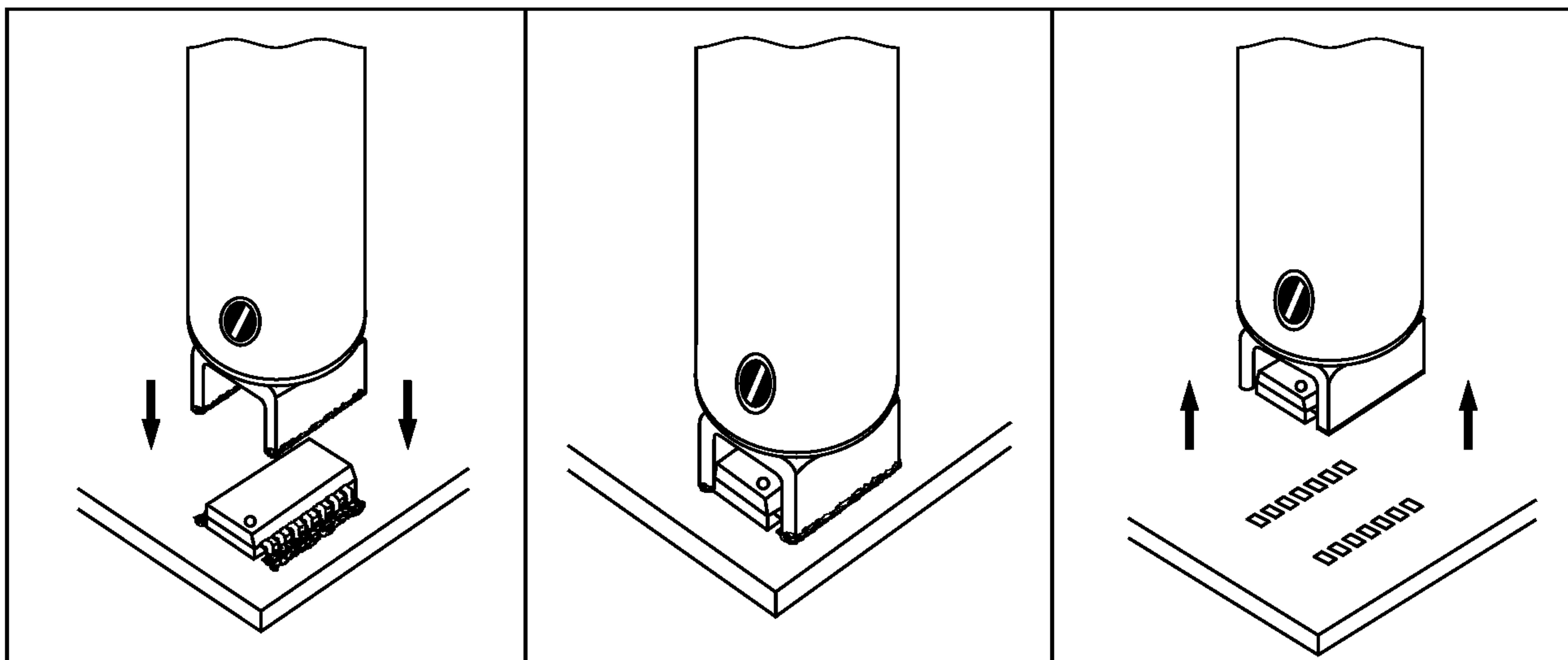
Рисунок 5 — Пример процедуры удаления корпуса SOIC
