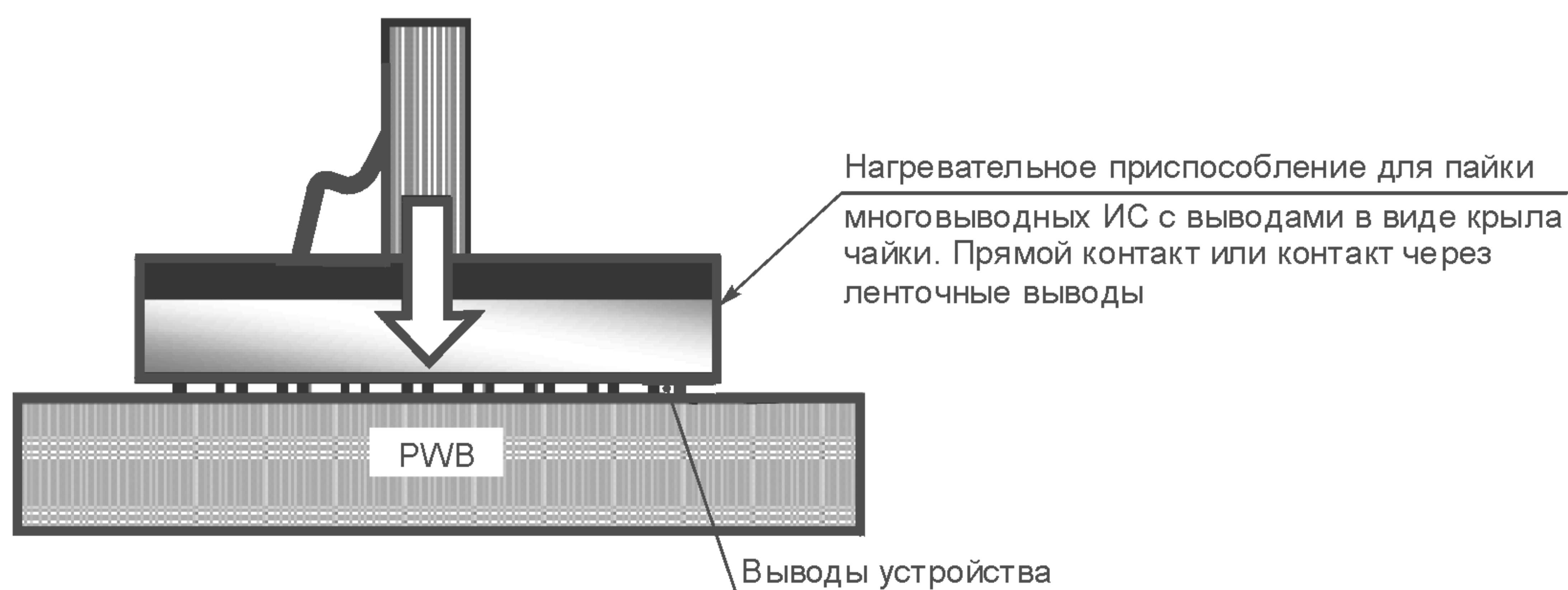
Рисунок 9 — Пайка оплавлением нагретыми термодами
