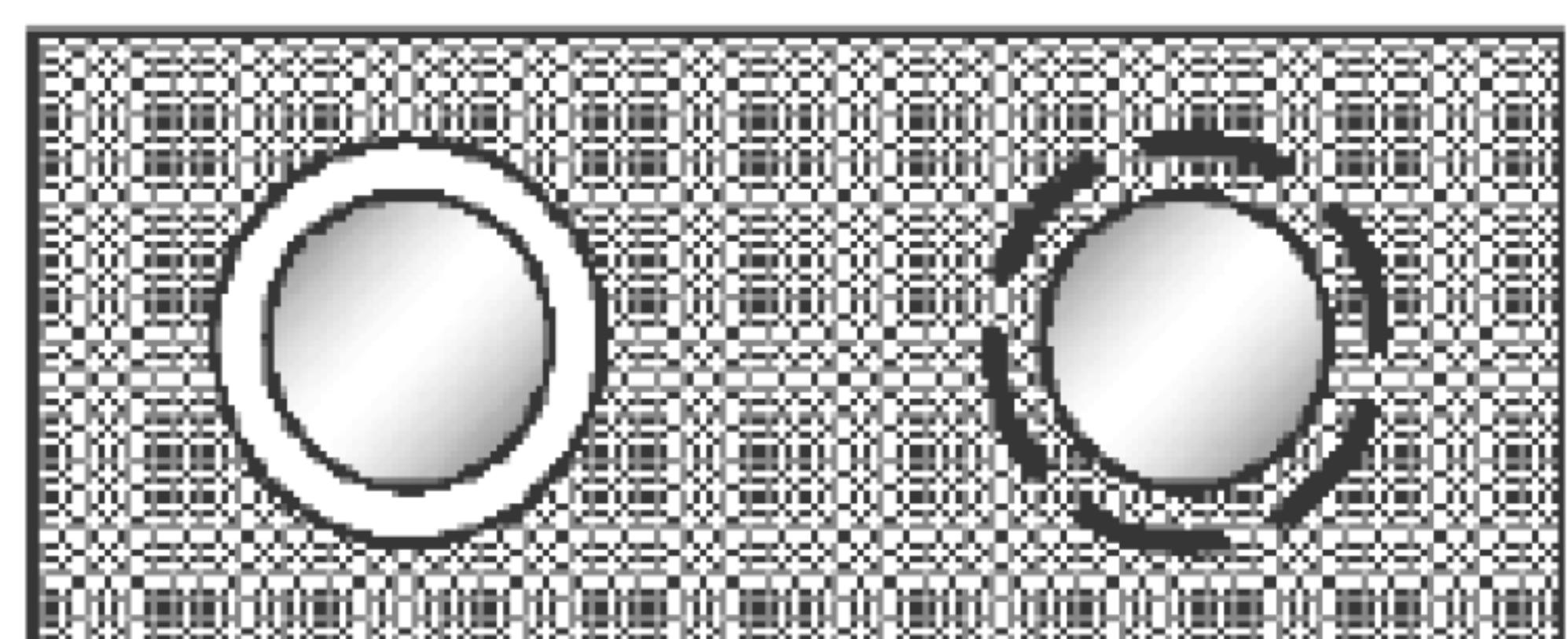
Варианты нанесения паяльной маски для корпусов BGA: с освобождением контактной площадки от маски и с нанесением маски на часть контактной площадки
