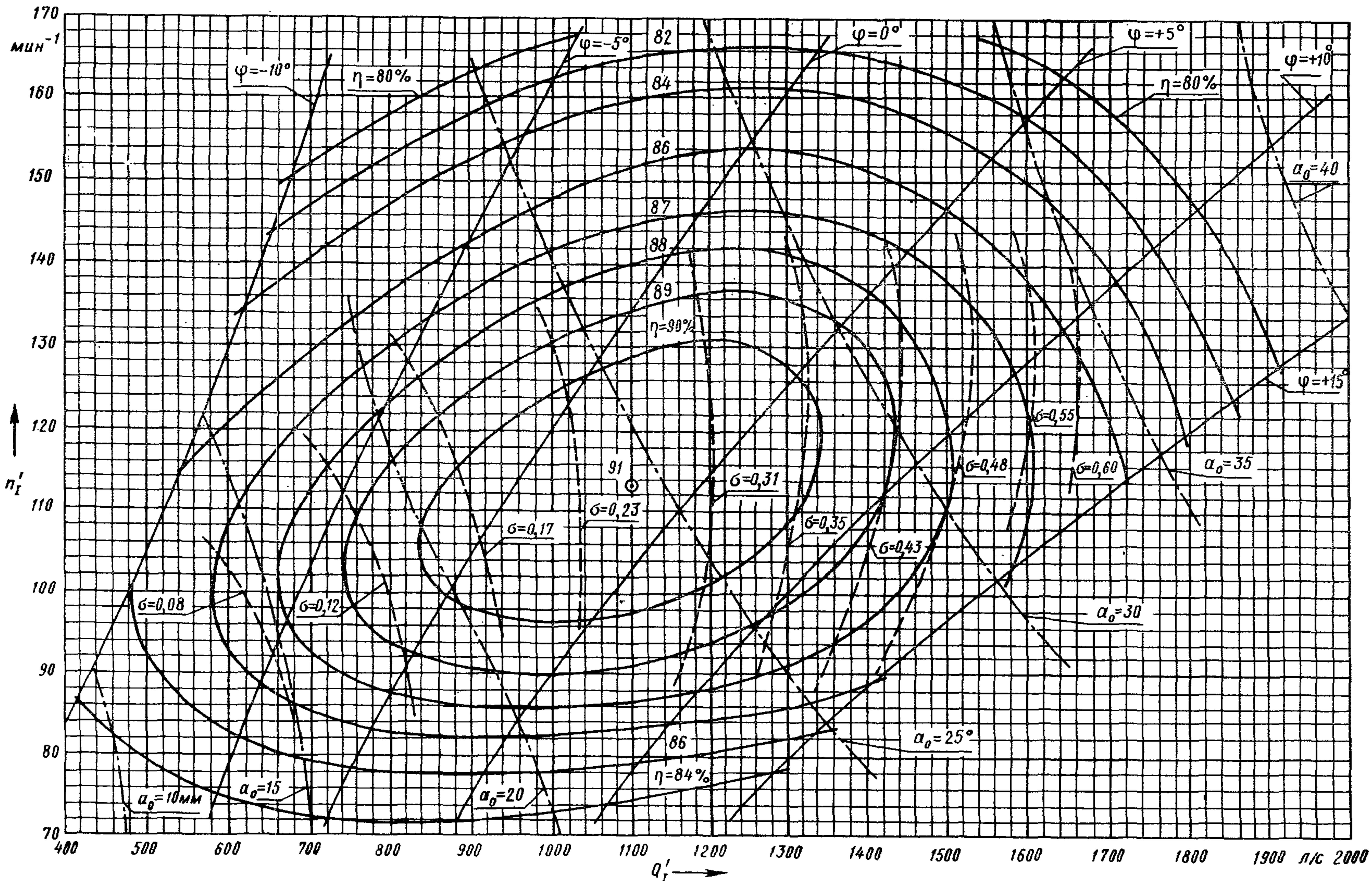
Испытания проведены при напоре гидротурбины 5 м и температуре 16°C
