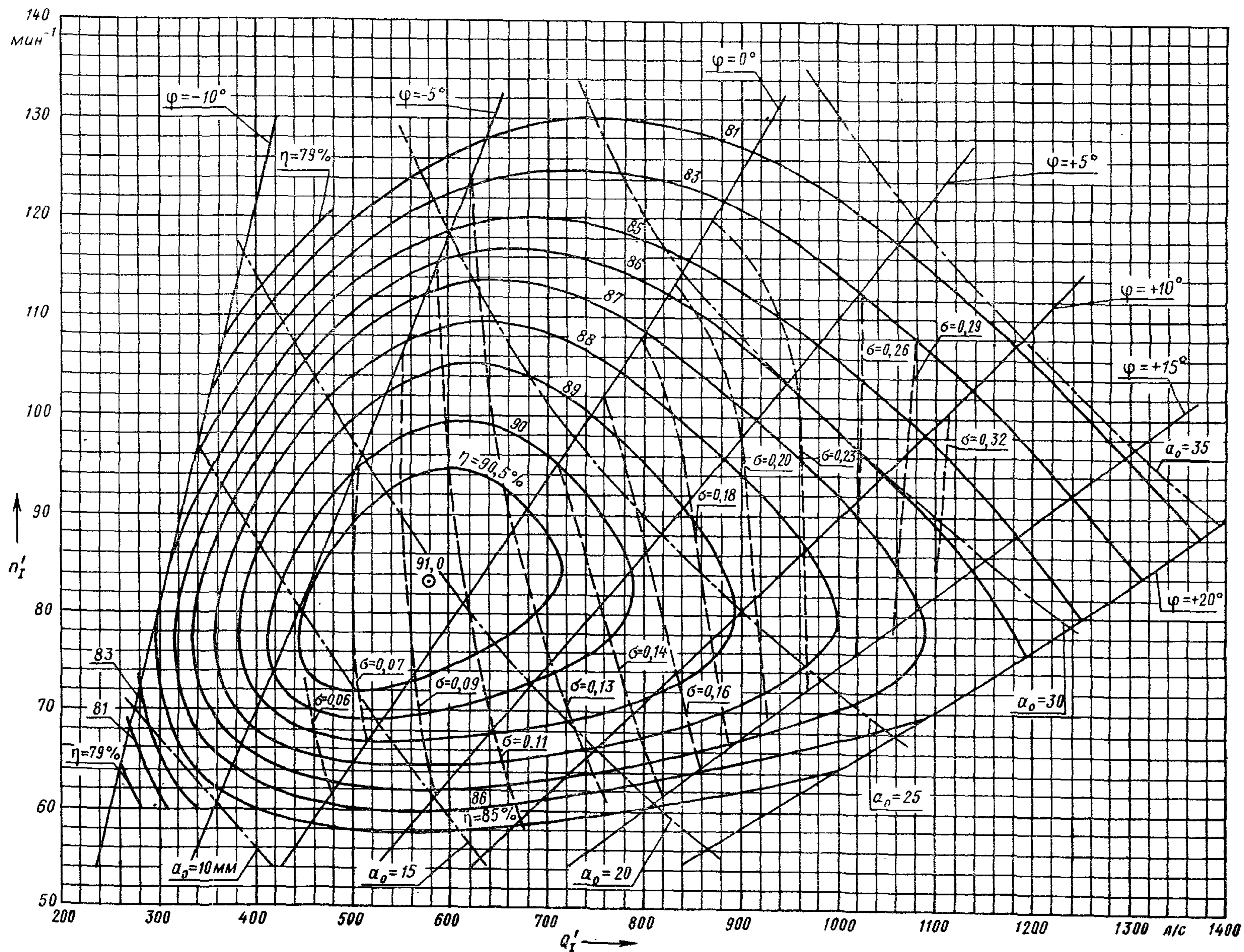
Испытания проведены при напоре гидротурбины 5 м и температуре 16°C
