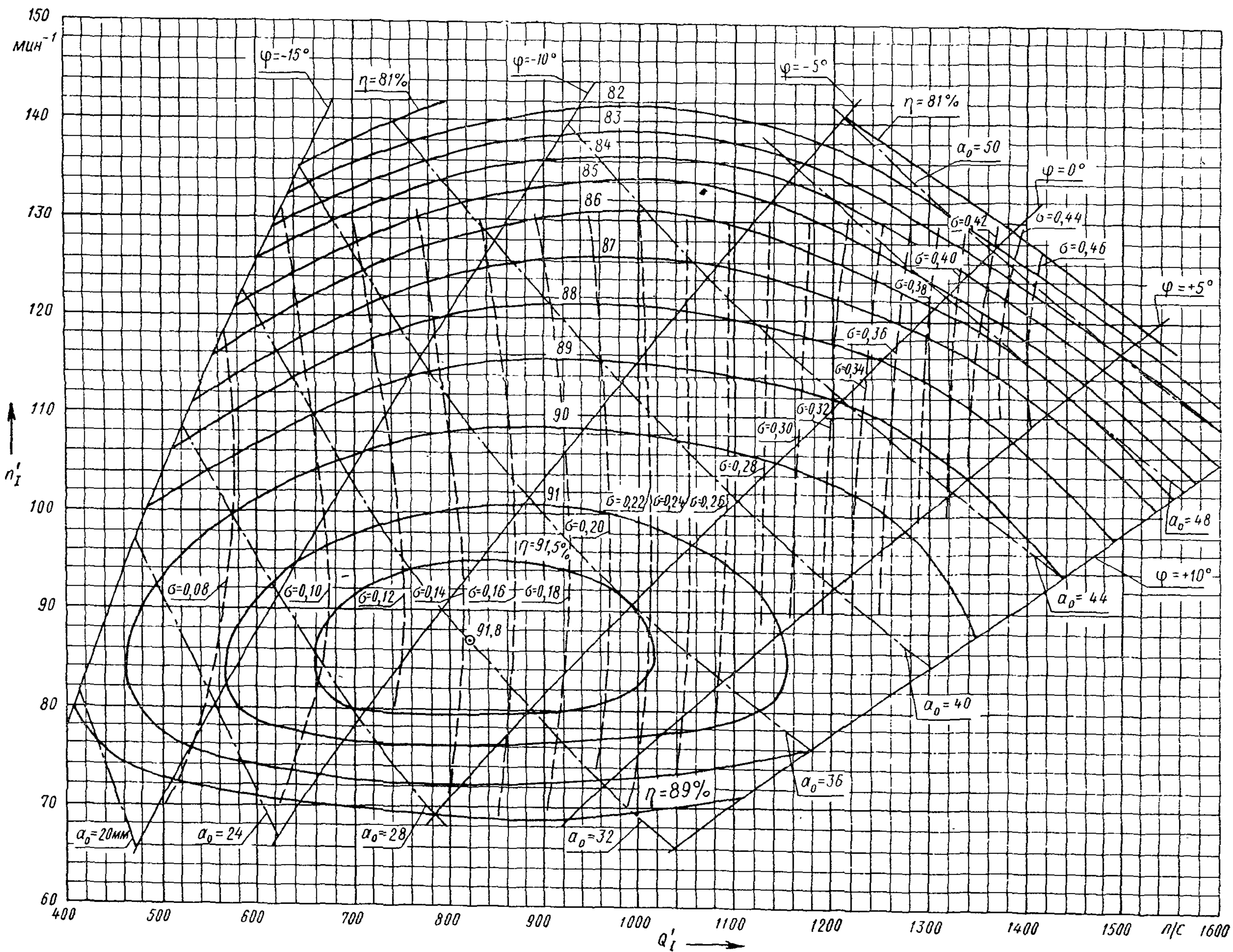
Испытания проведены при напоре гидротурбины 4 м и температуре от 14 до 18°C
