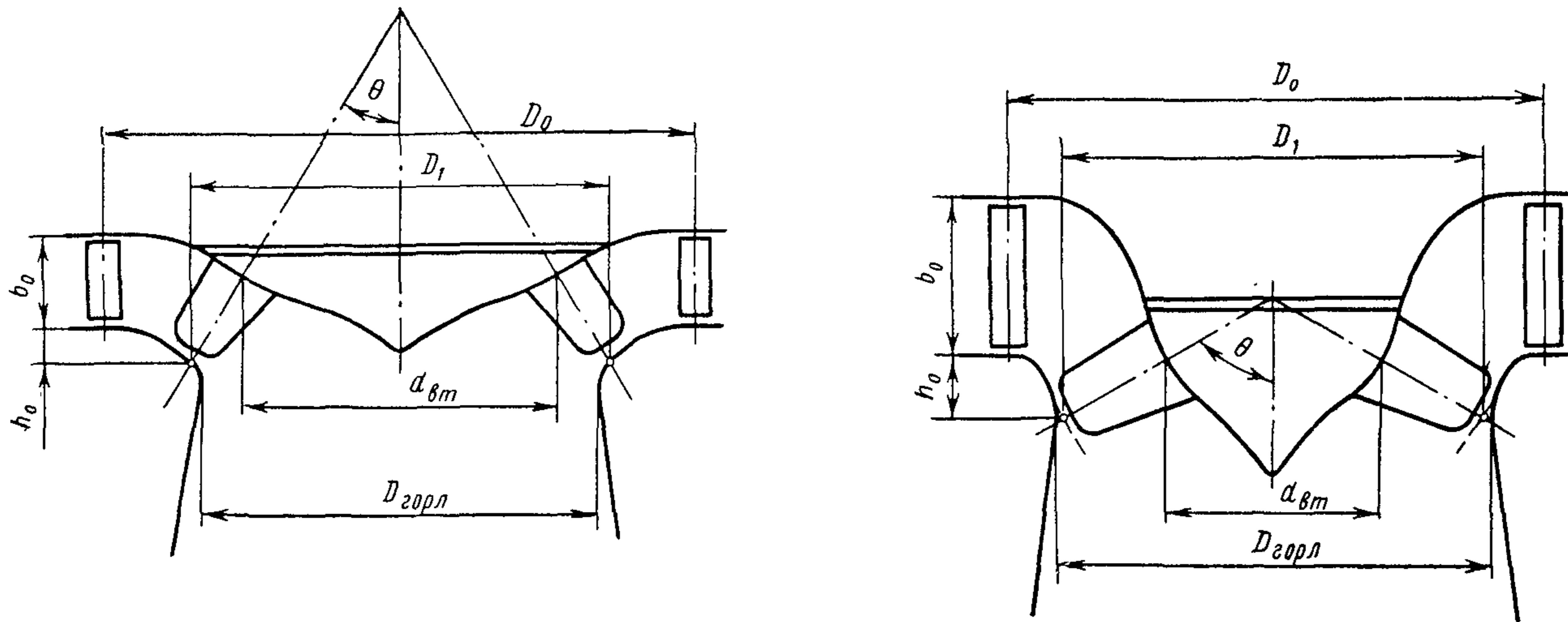
$D_1$  — диаметр рабочего колеса;  $D_0$  — диаметр направляющего аппарата;  $D_{горл}$  — диаметр горловины;  $d_{вт}$  — диаметр корпуса;  $b_0$  — высота направляющего аппарата;  $\theta$  — угол наклона лопастей
