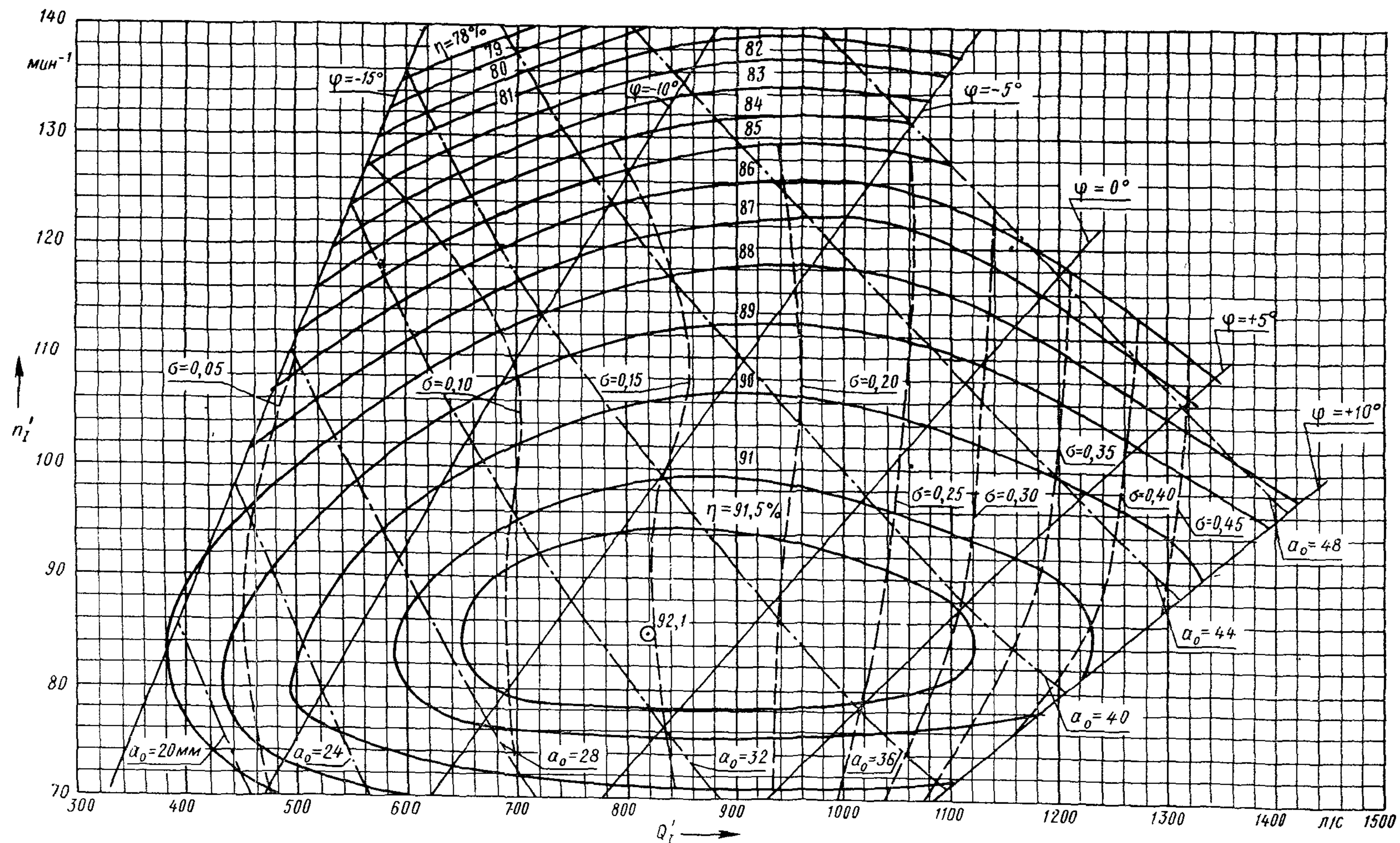
Испытания проведены при напоре гидротурбины 4 м и температуре от 11,5 до 18°C
