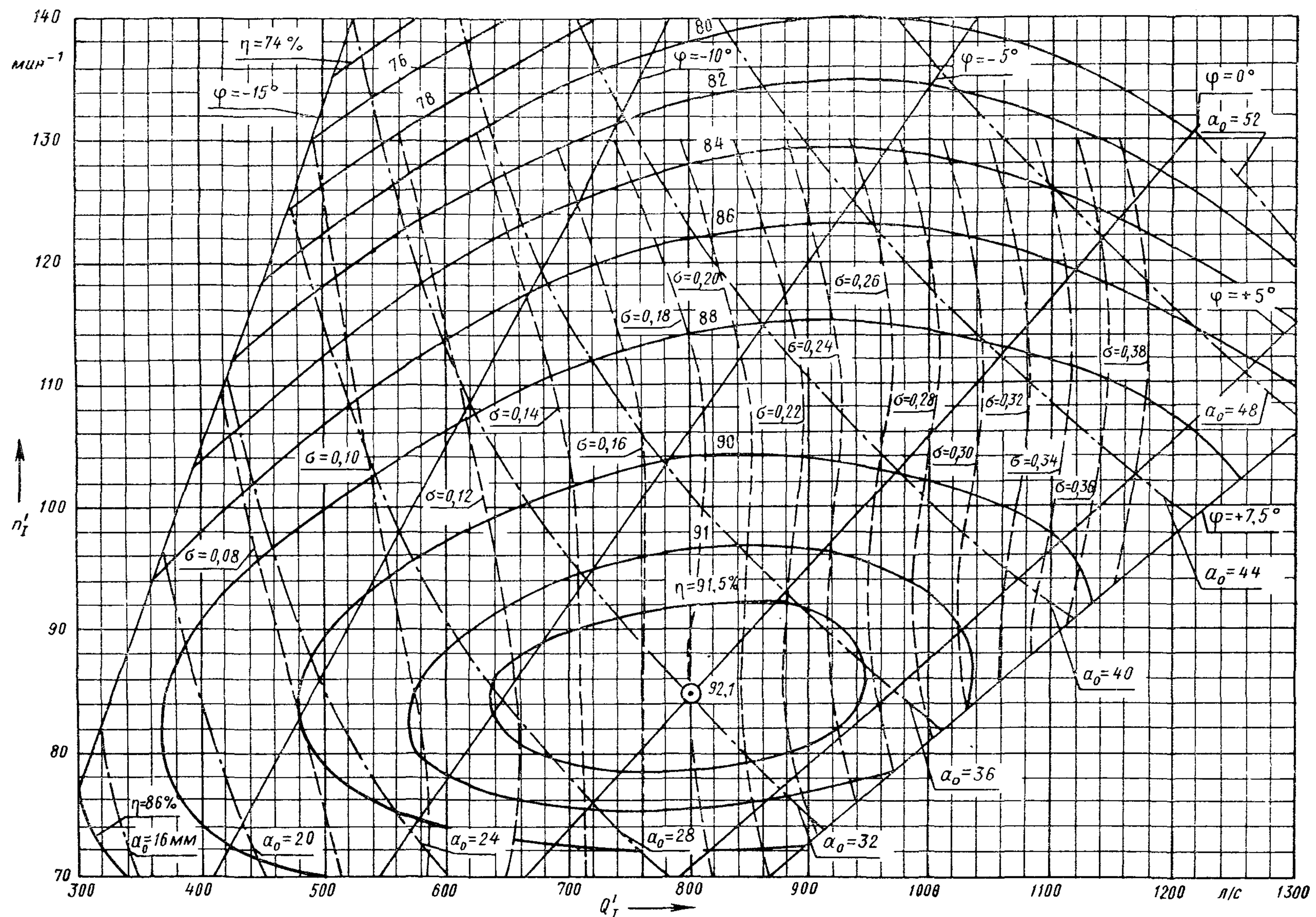
Испытания проведены при напоре гидротурбины 4 м и температуре от 5 до 7°C
