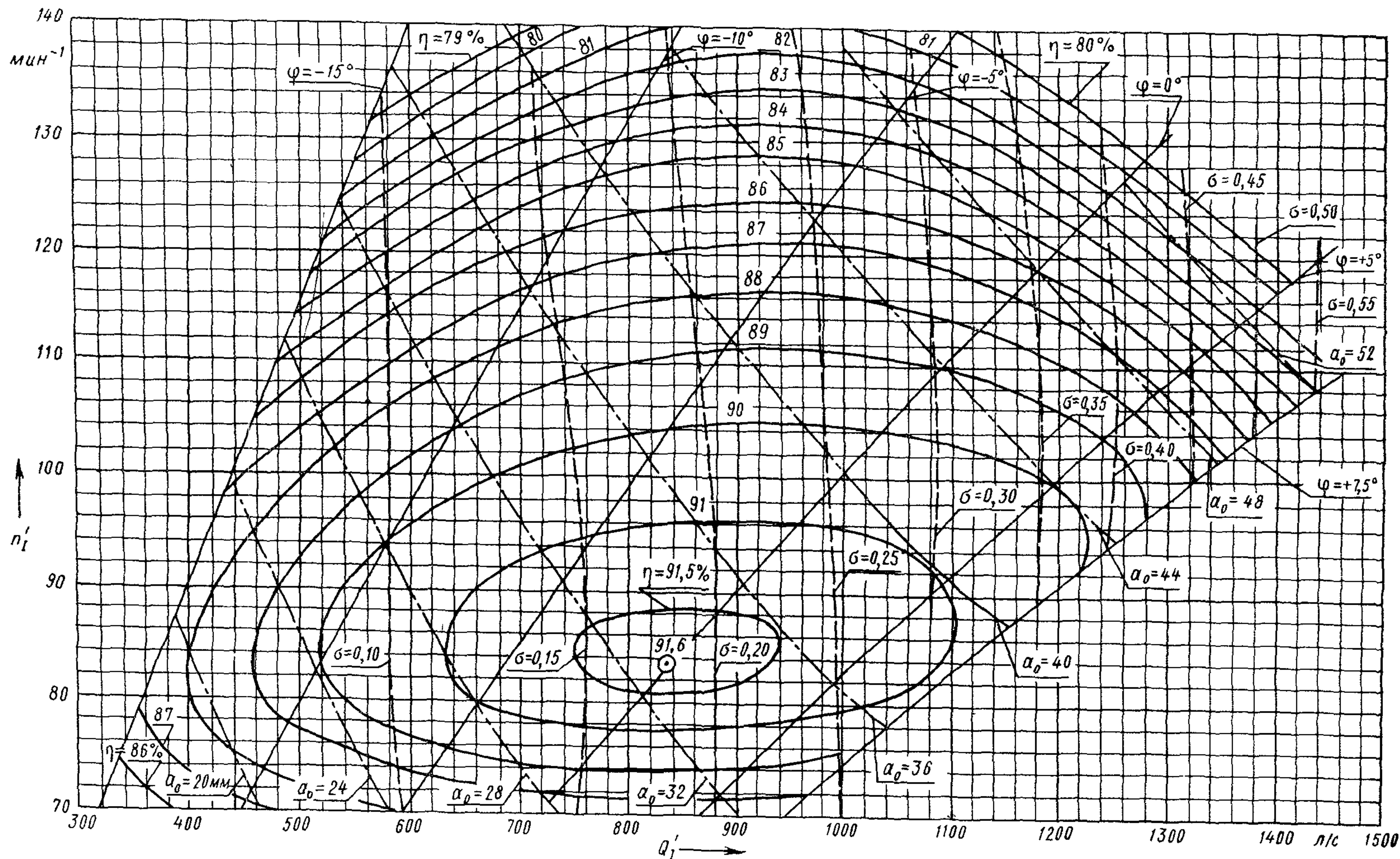
Испытания проведены при напоре гидротурбины 4 м и температуре от 6 до 11°C
