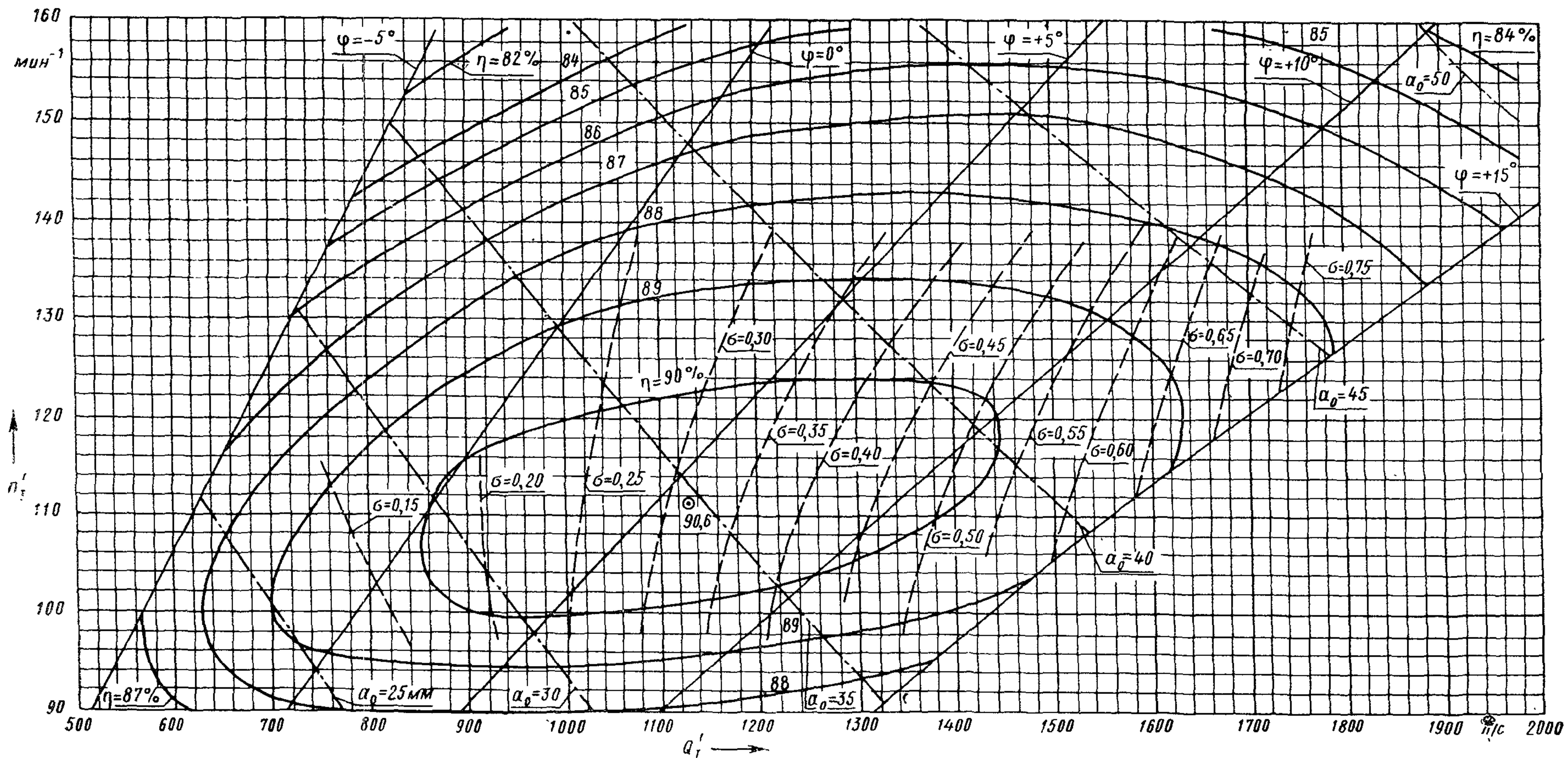
Испытания проведены при напоре гидротурбины 12 м и температуре 20°C
