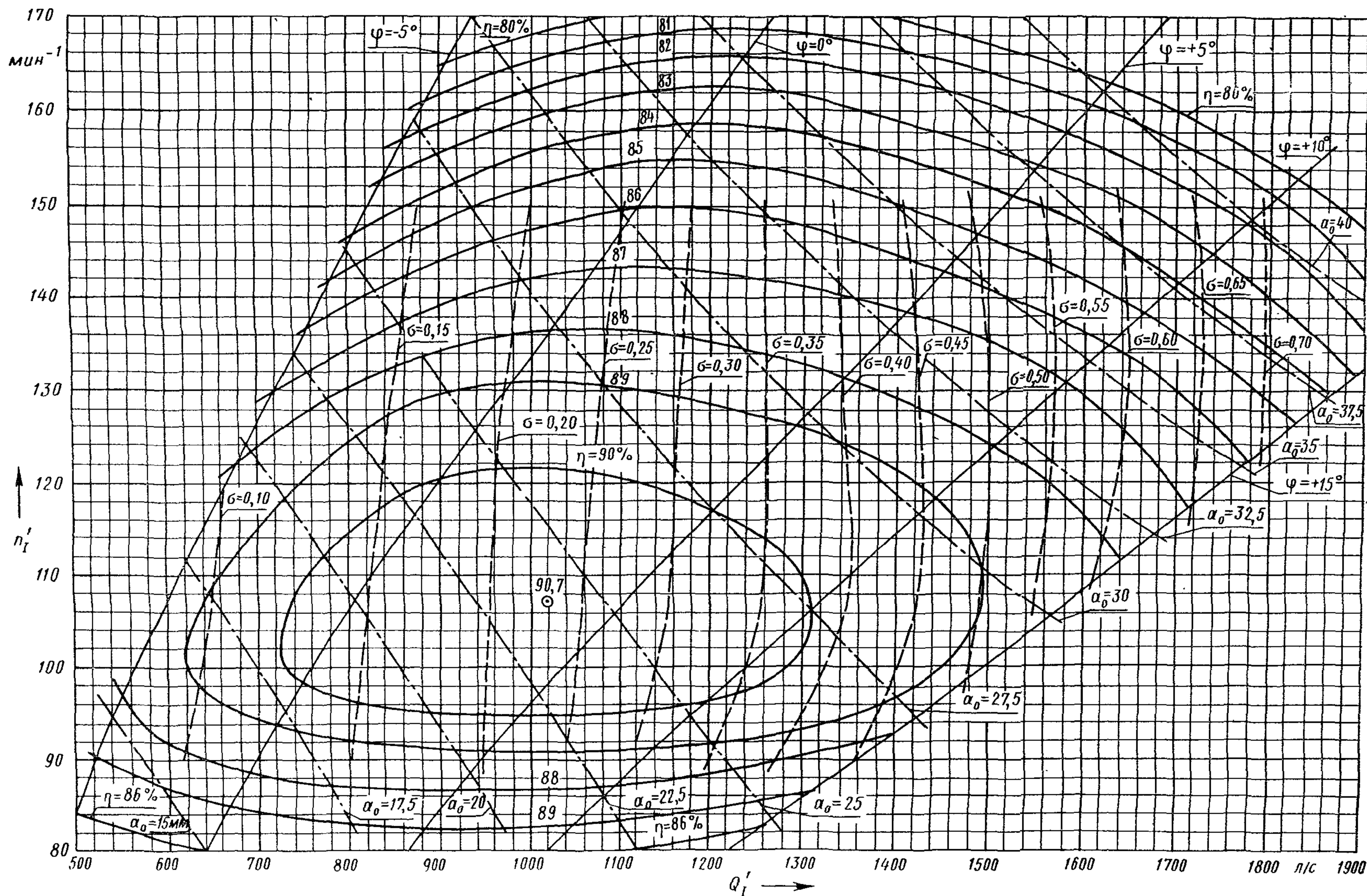
Испытания проведены при напоре гидротурбины от 3 до 6 м и температуре от 3 до 7°C
