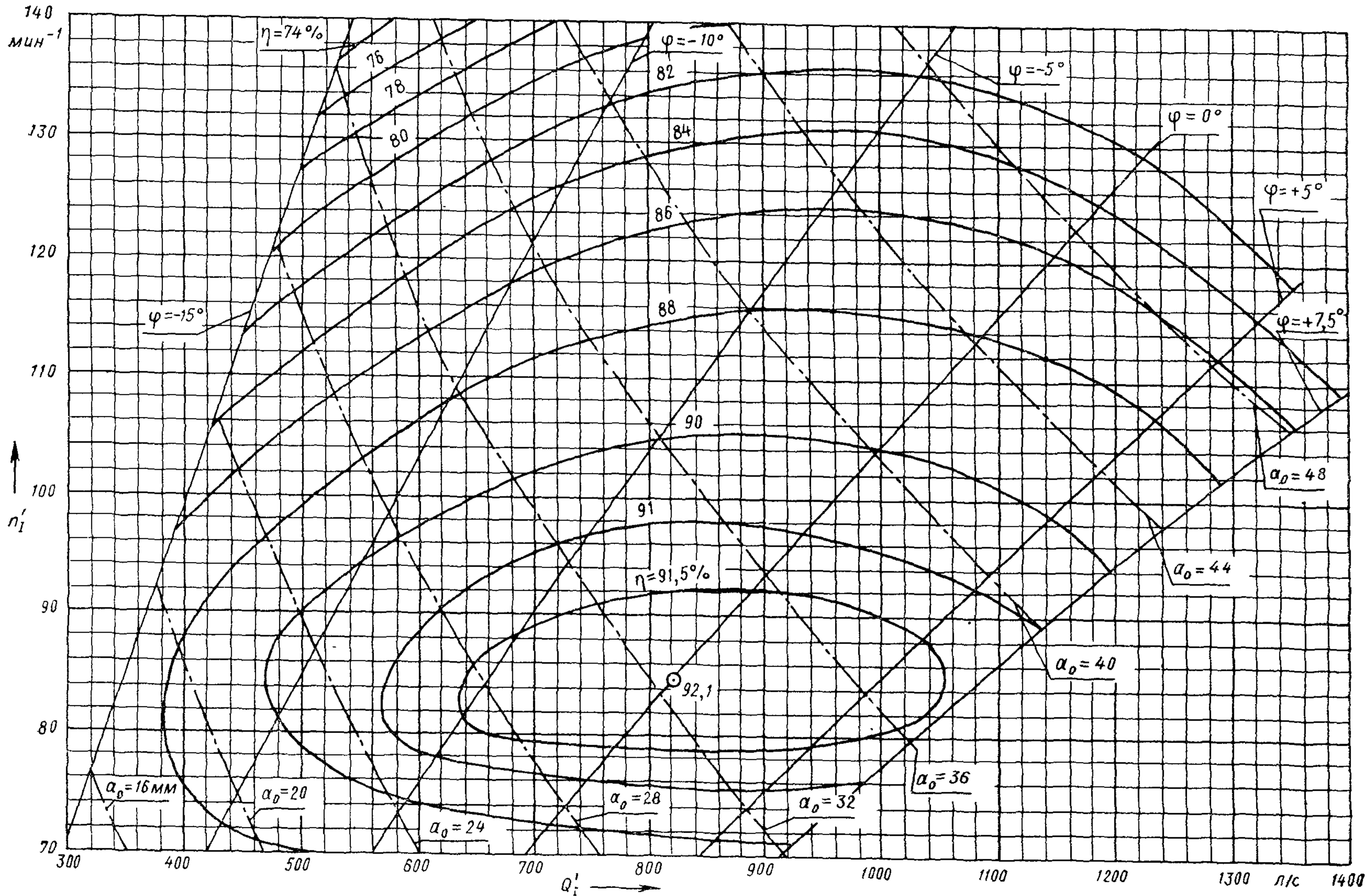
Испытания проведены при напоре гидротурбины 4 м и температуре от 17 до 20°C
