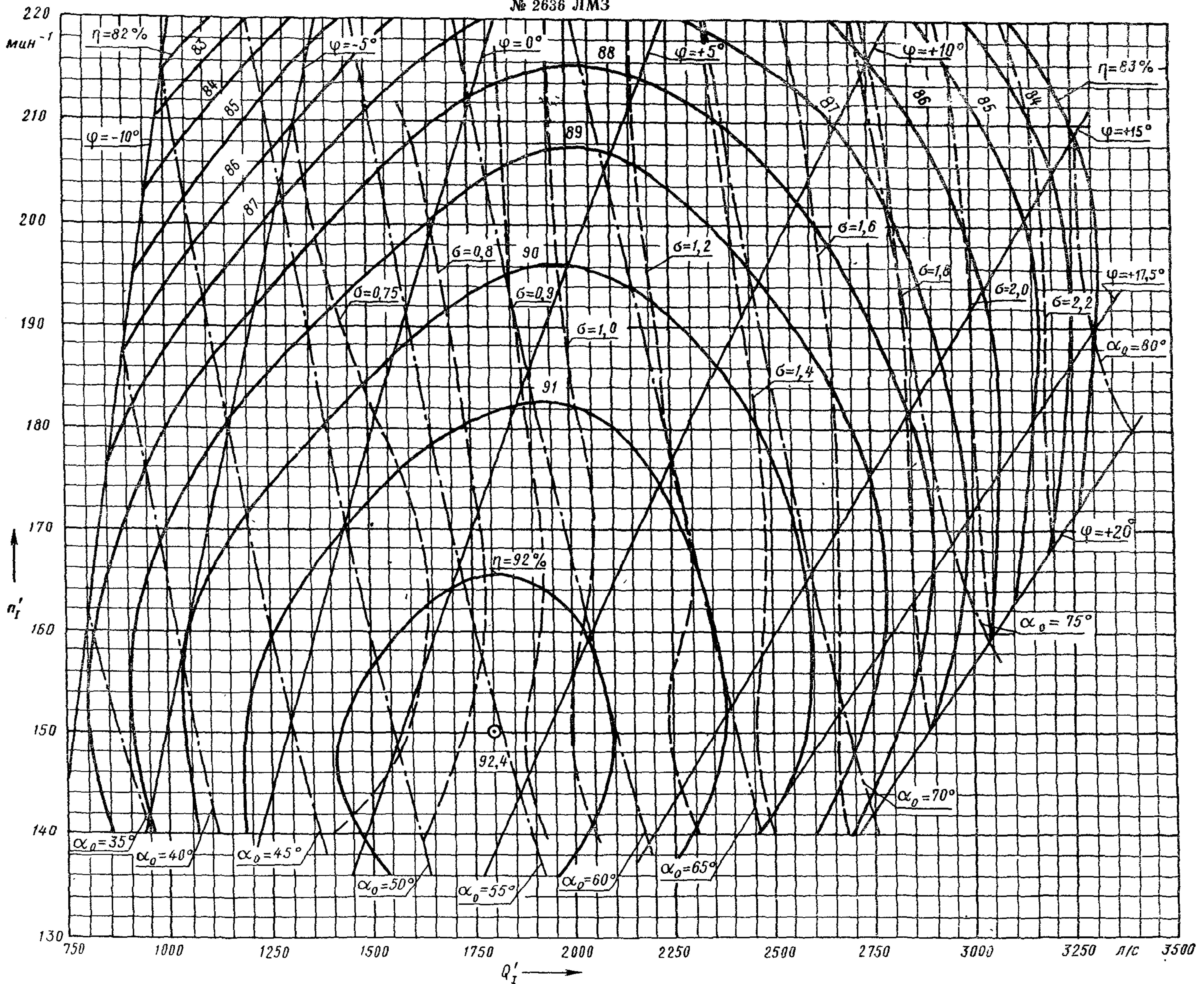
Испытания проведены при напоре гидротурбины от 2 до 3 м и температуре 16°C
