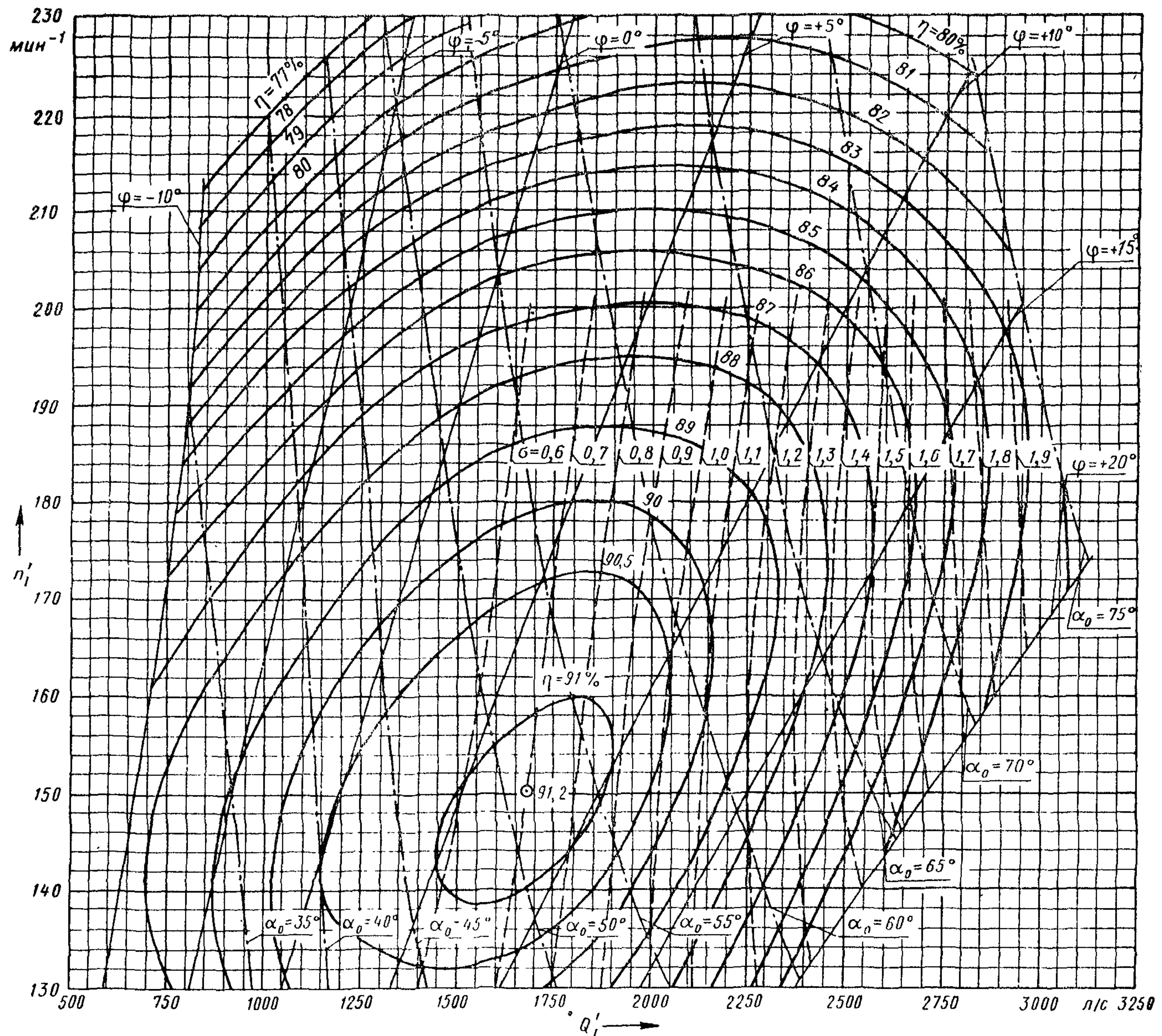
Испытания проведены при напоре гидротурбины 2,6 м и  $t=18^{\circ}\text{C}$
