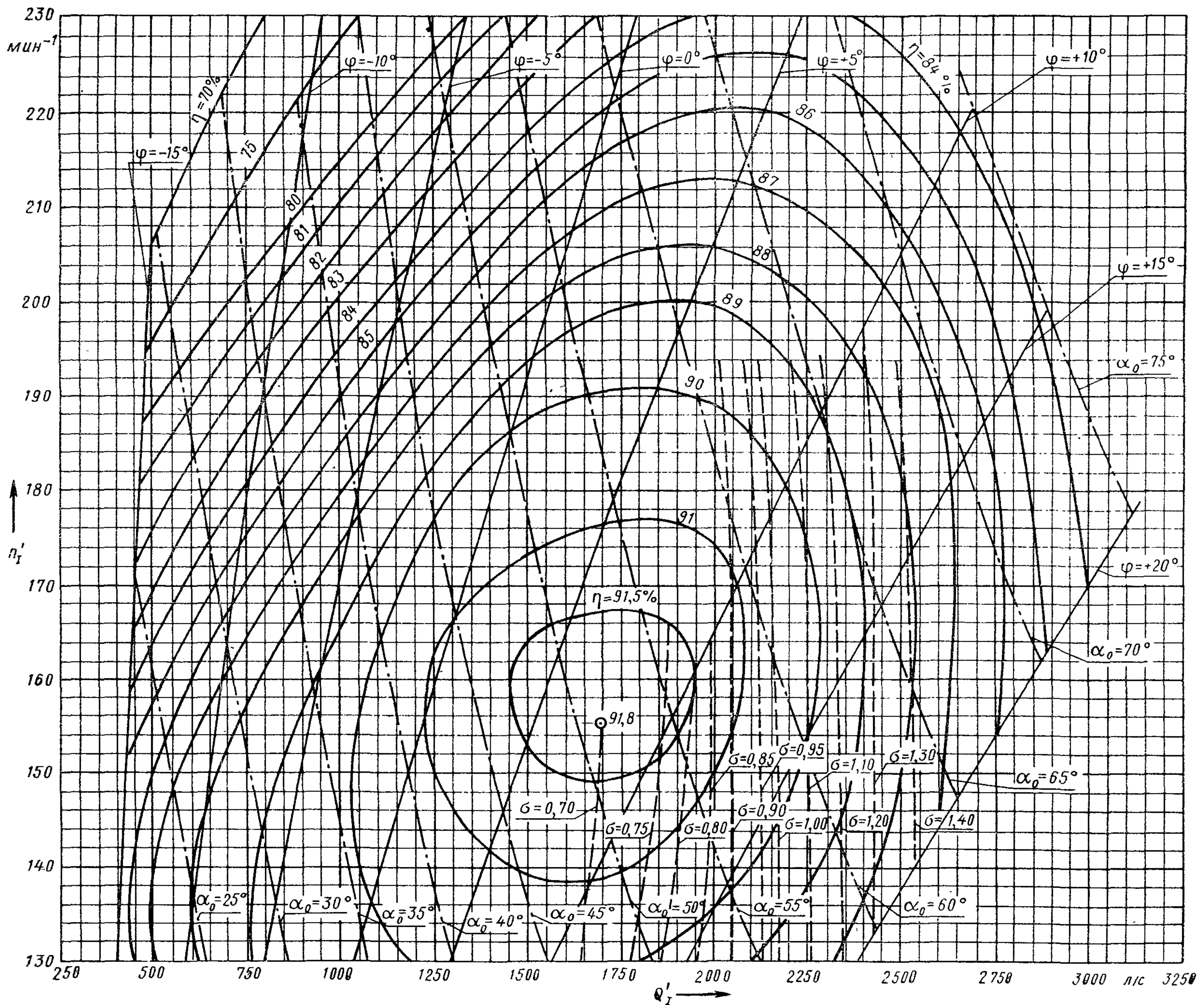
Испытания проведены при напоре гидротурбины 3,6 м и температуре 18°C
