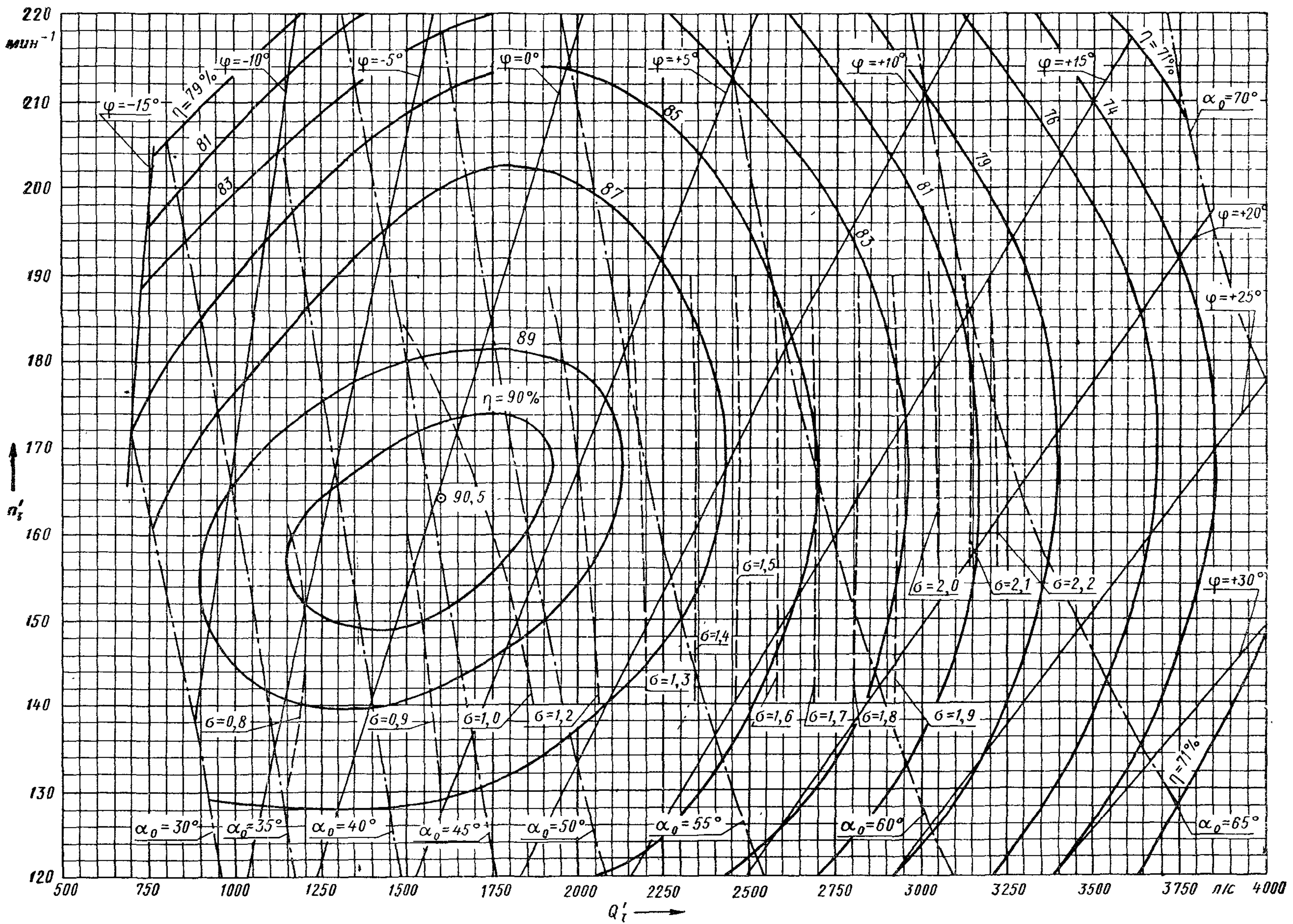
Испытания проведены при напоре гидротурбины 3,6 м и температуре 18°C
