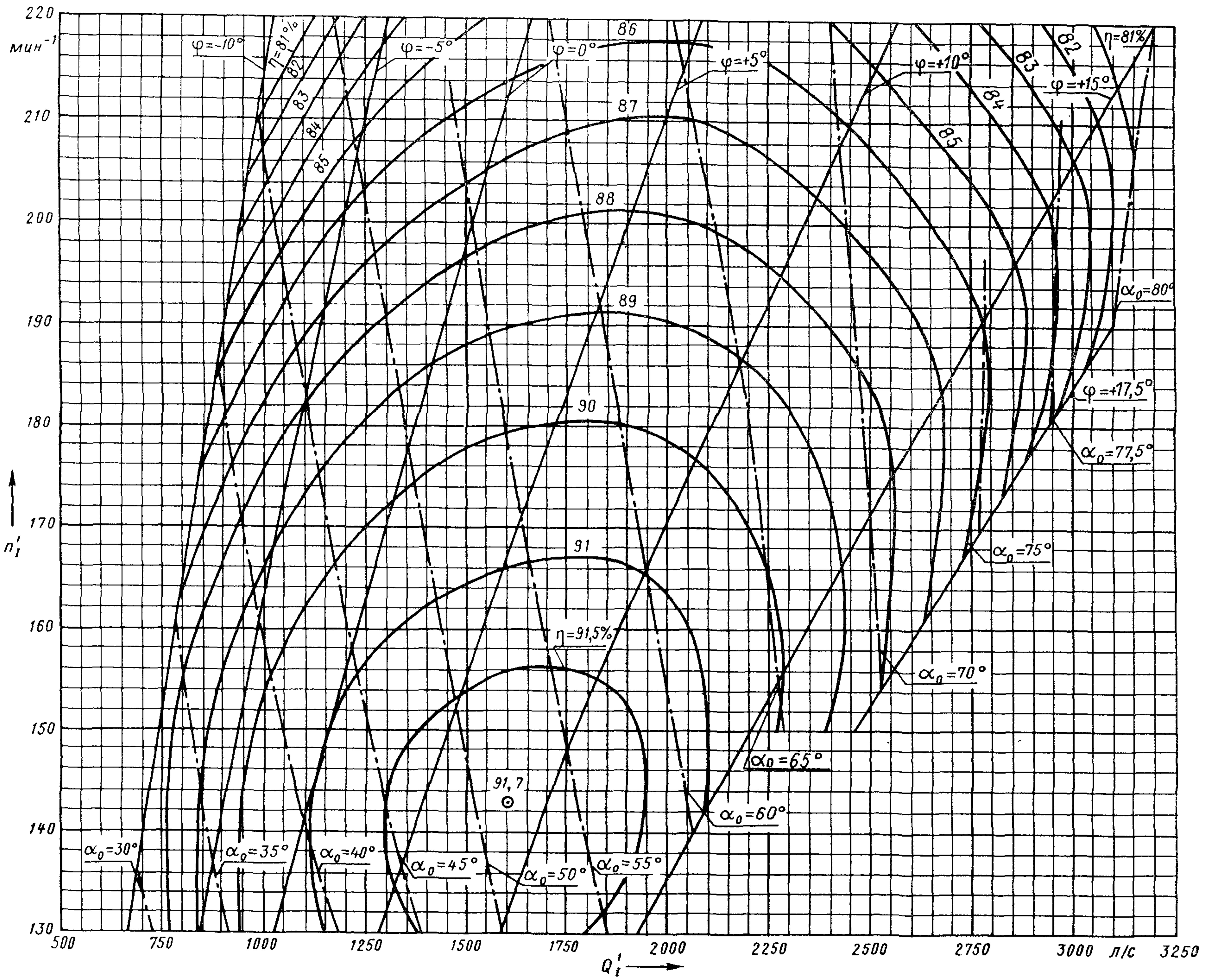
Испытания проведены при напоре гидротурбины от 2,5 до 3 м и температуре 18°C
