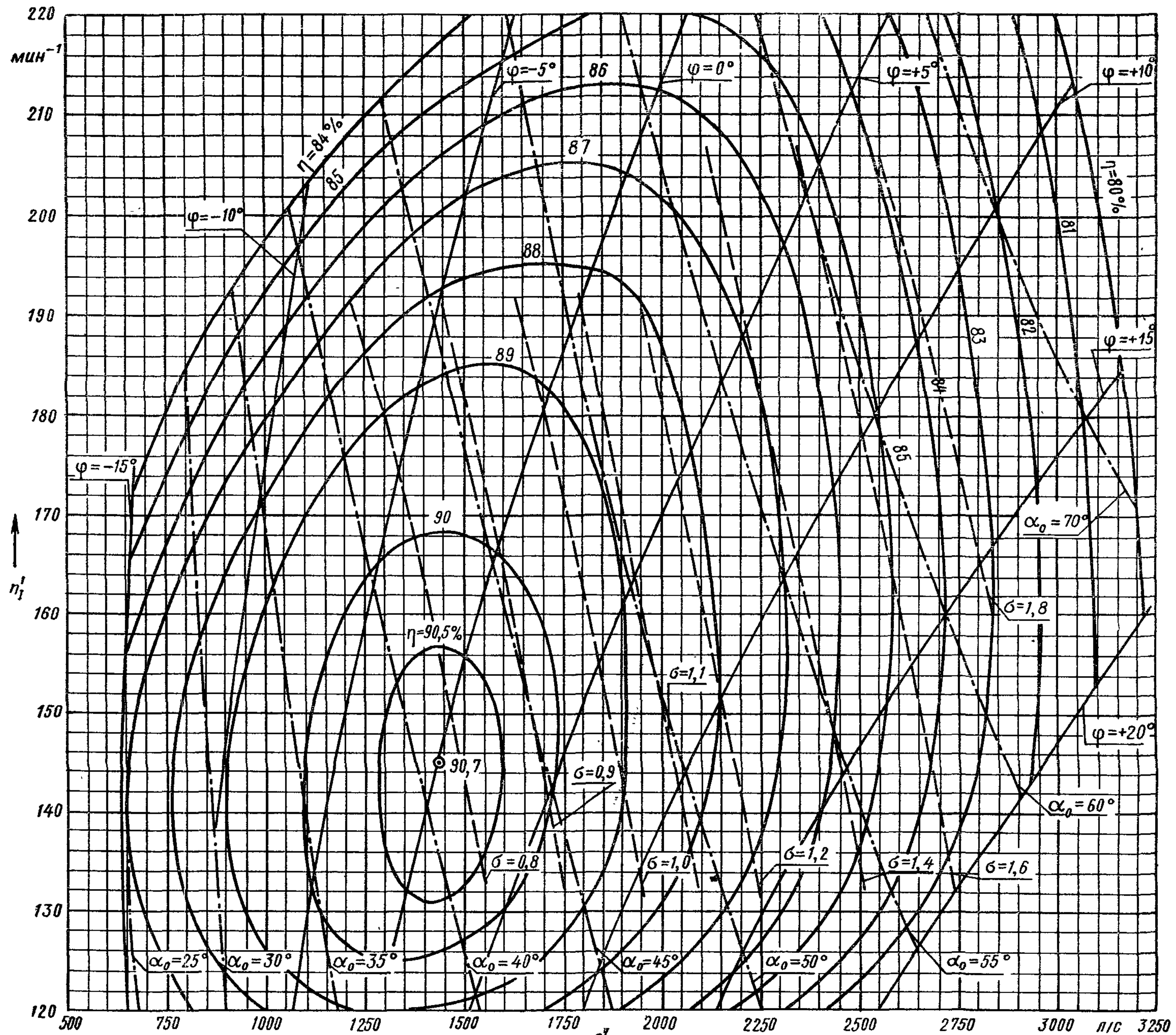
Испытания проведены при напоре гидротурбины 4 м и температуре 18°C
