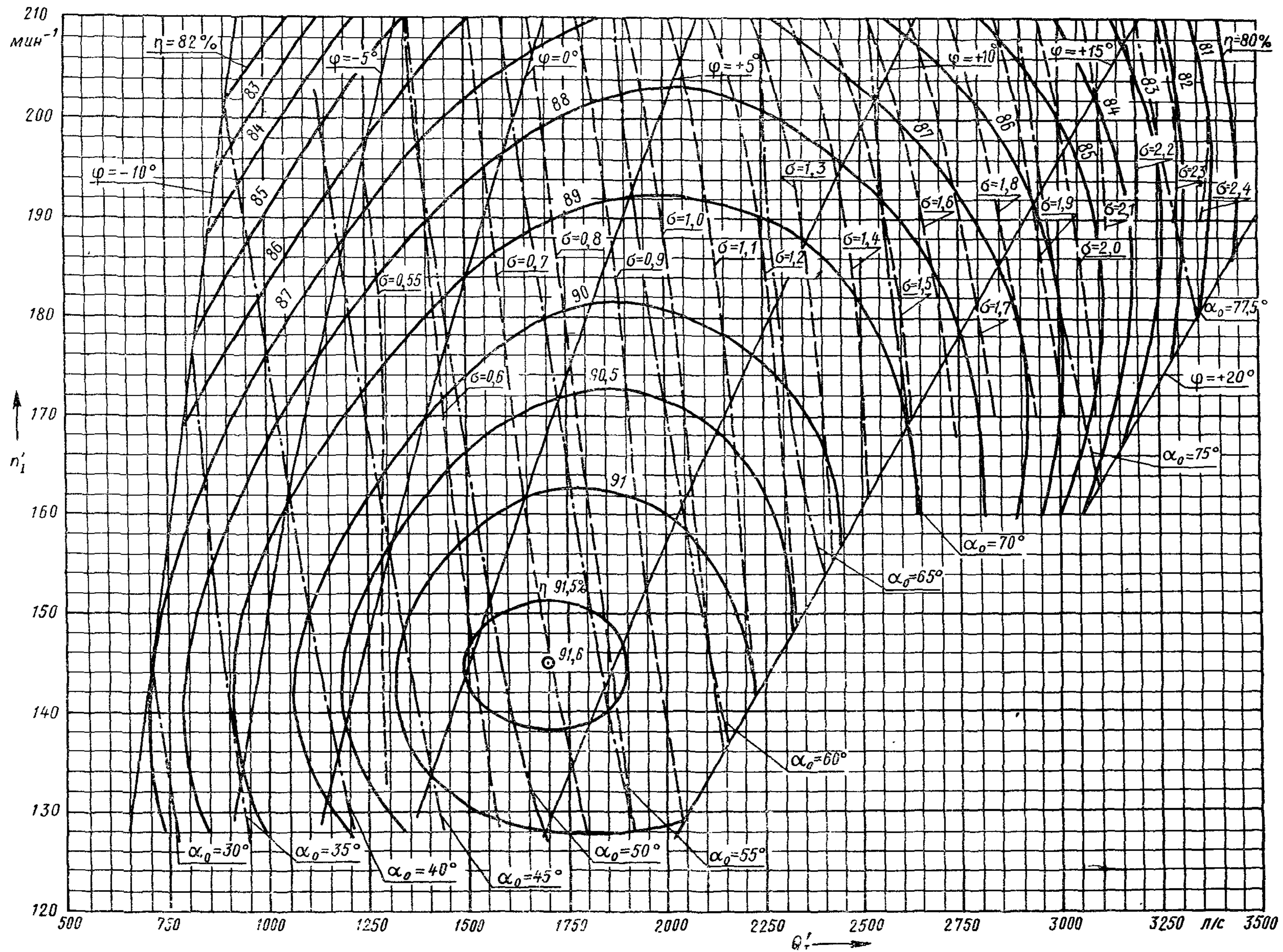
Испытания проведены при напоре гидротурбины от 2,5 до 3 ч и температуре 6°C
