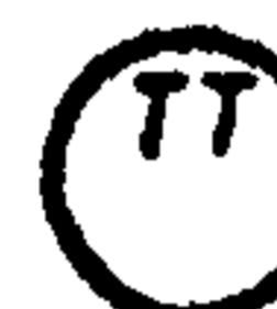
Например: термометр манометрический (или любой другой датчик температуры) бесшарнирный с пневмо-или электропереходом
