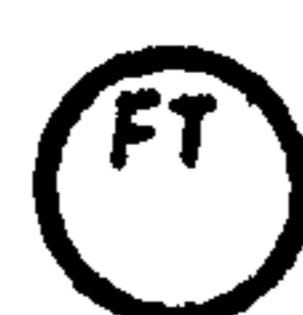
Прибор для измерения расхода бесшкальный, с дистанционной передачей показаний, установленный по месту.
