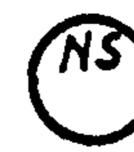
Пусковая аппаратура для управления электродвигателем (включение, выключение насоса; открытие, закрытие задвижки и т.д.).
