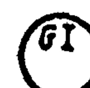
Прибор для измерения размеров показывающий, установленный по месту.
