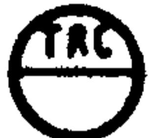
Например: любой самопишущий регулятор температуры (термометр манометрический, милливольтметр, логометр, потенциометр, мост автоматический и т.п.)
