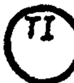
Например: термометр ртутный, термометр манометрический и т.п.
