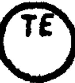
Например: термоочетр термоэлектрический (термопара), термометр сопротивления, термобаллон манометрического термометра, датчик пирометра и т.п.
