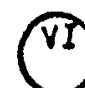
Прибор для измерения вязкости раствора показывающий, установленный по месту.
