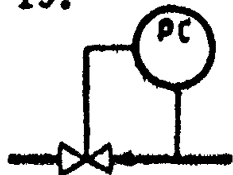
Регулятор давления, работающий без использования постороннего источника энергии (регулятор давления прямого действия) "до себя"
