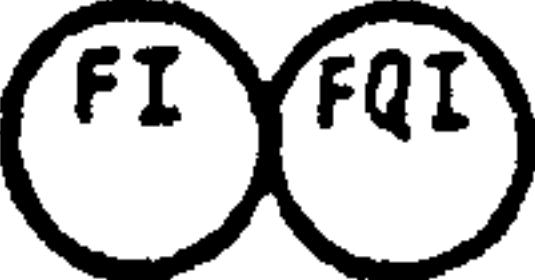
Например: показывающий цифманометр с интегратором
