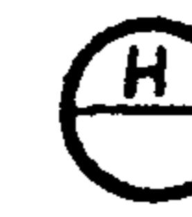
Аппаратура, предназначенная для ручного дистанционного управления (включение, выключение двигателя; открытие, закрепление запорного органа, изменение задания регулятору), установленная на щите.
