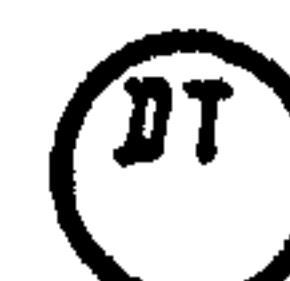
Прибор для измерения плотности раствора бесшкальный, с дистанционной передачей показаний, установленный по месту.
