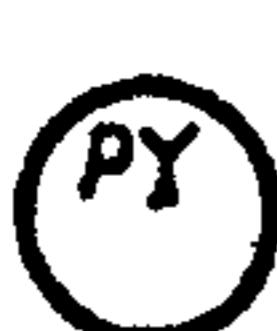
Преобразователь сигнала, установленный по месту. Входной сигнал пневматический, выходной - электрический
