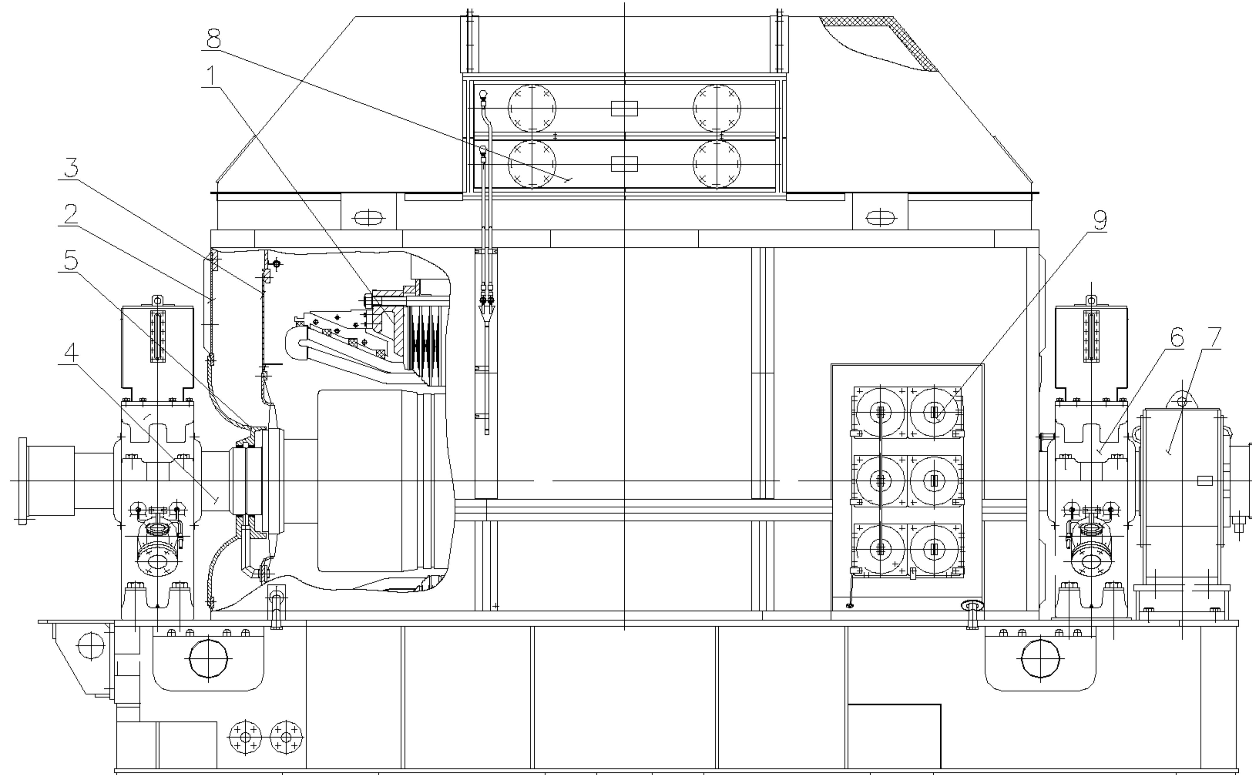
1 – статор; 2 – щит наружный; 3 – щит внутренний; 4 – ротор; 5 – уплотнение;
