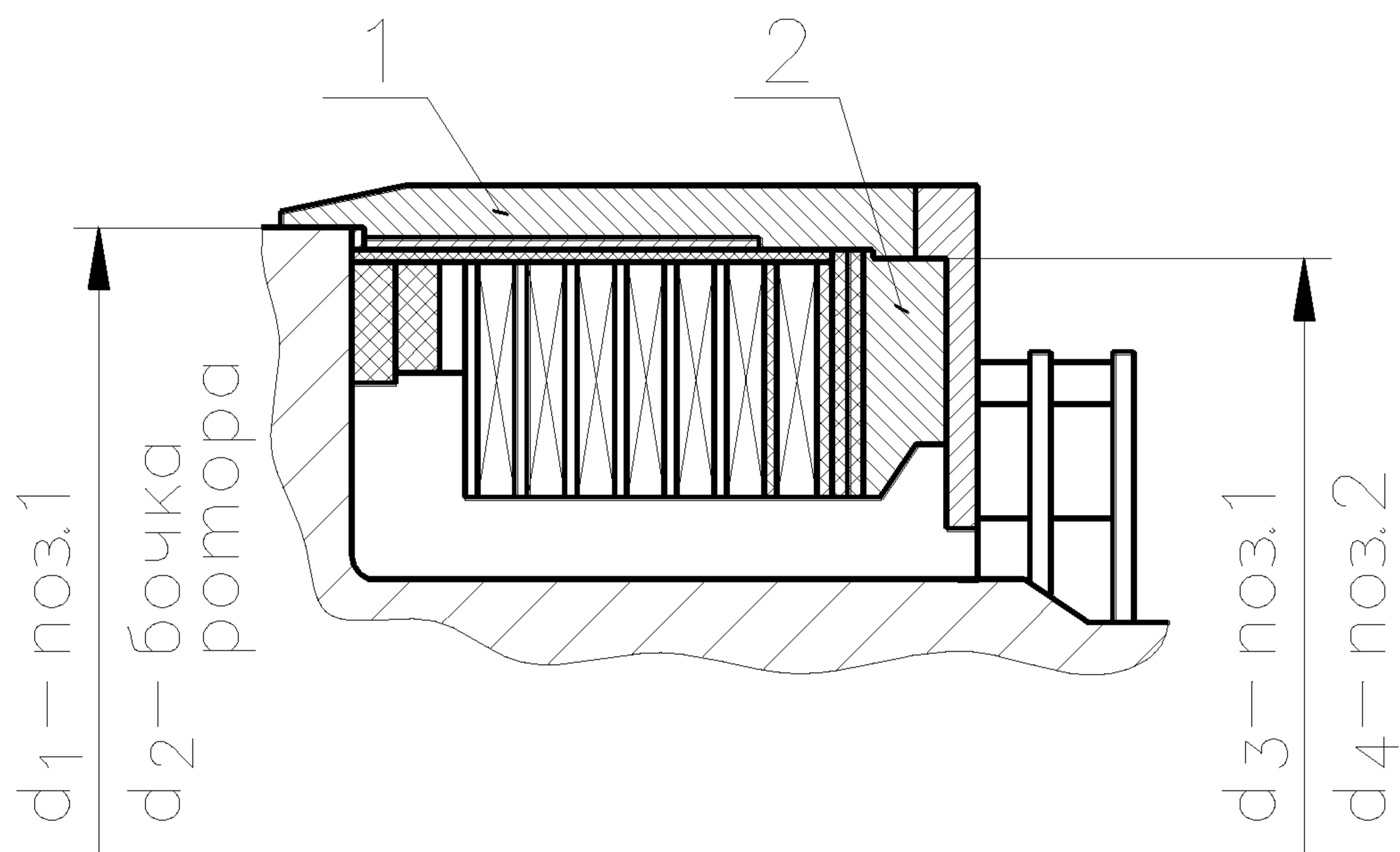
Рисунок 7.2а – Бандажный узел ротора турбогенератора ТС–20
