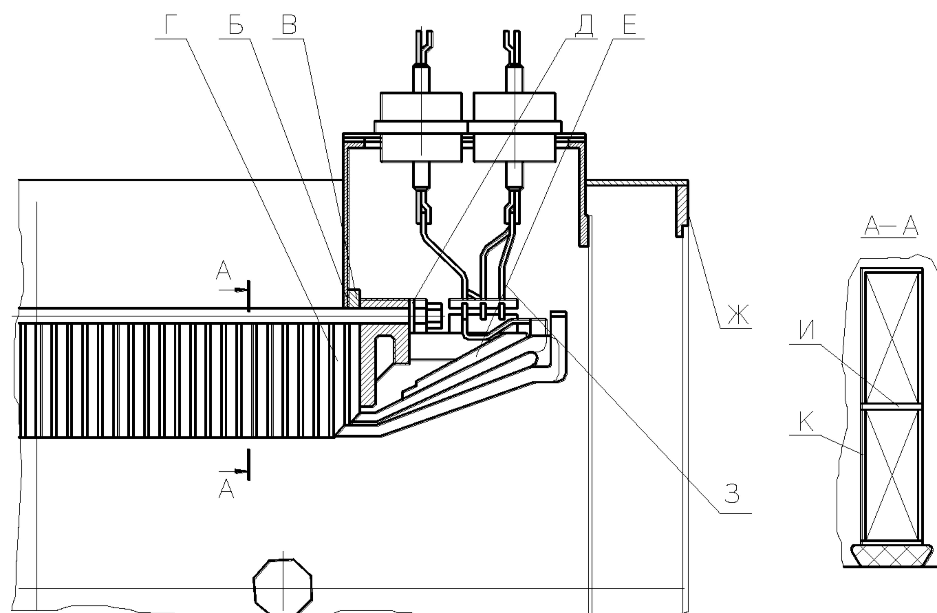
Статор турбогенератора Т-32-2В3
