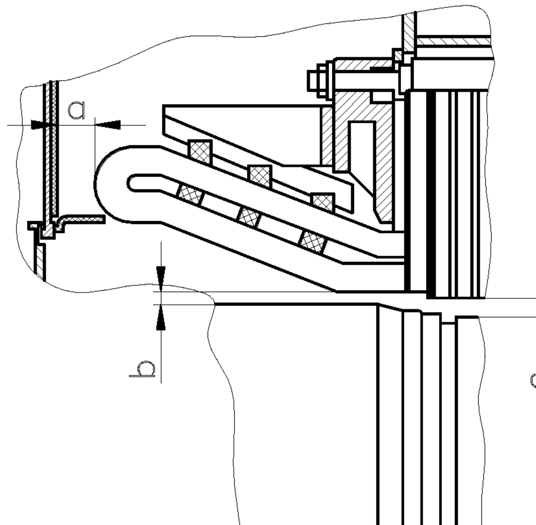
Рисунок 8.5 – Установка ротора турбогенератора Т-32 (ст. турбины)
