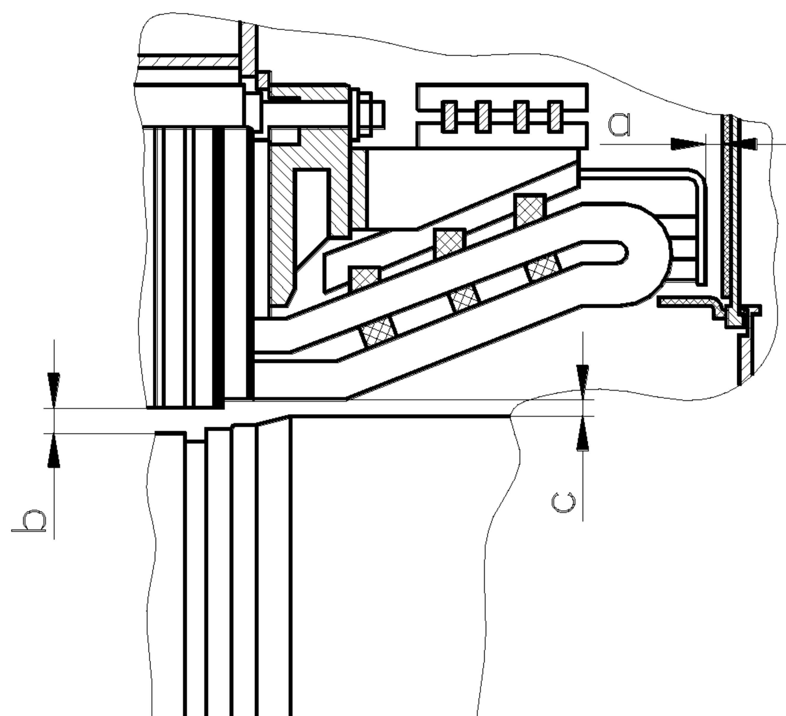
Рисунок 8.6 – Установка ротора турбогенератора Т–32 (ст. возбудителя)
