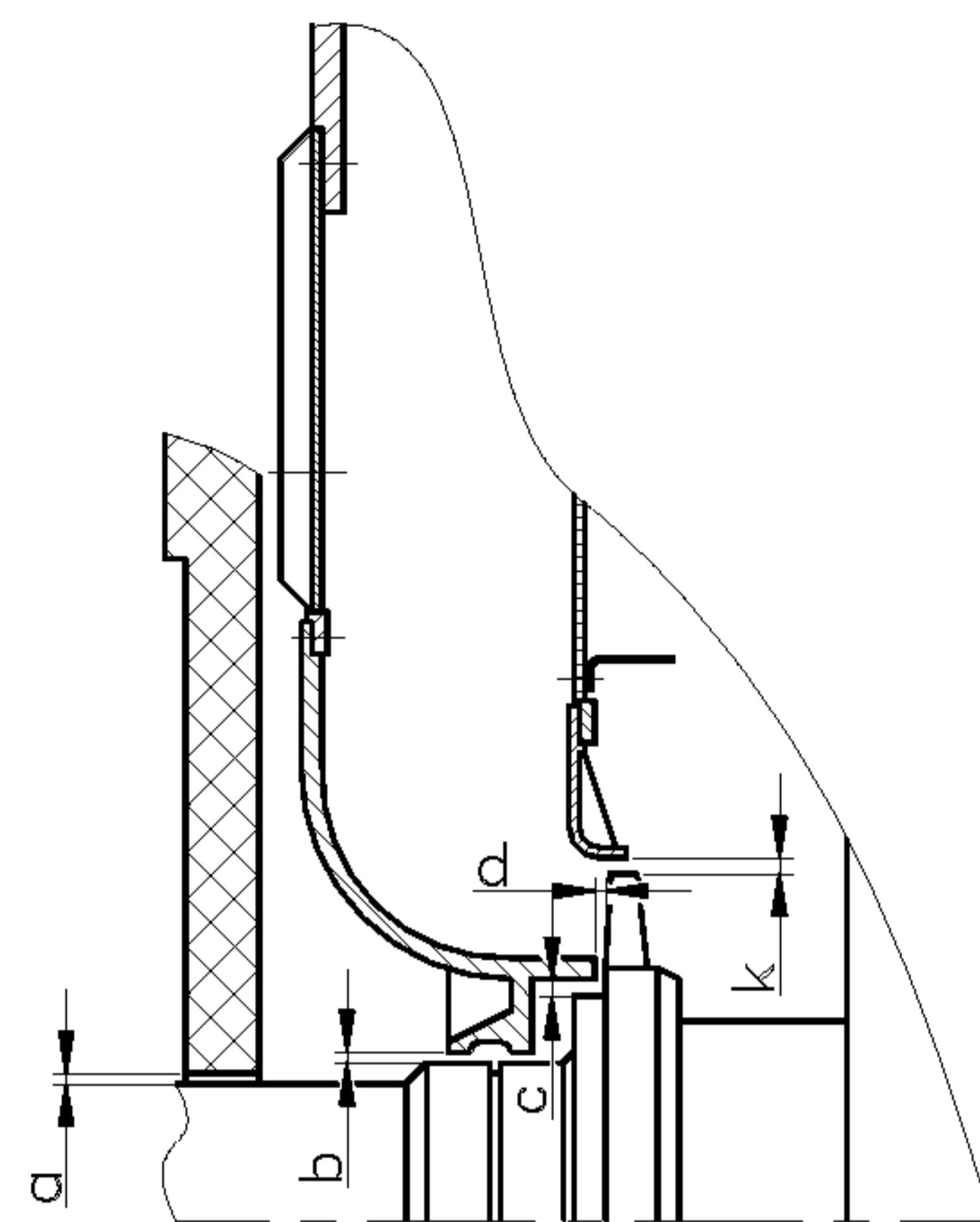
Рисунок 8.1 – Установка вентилятора (сторона турбины)
