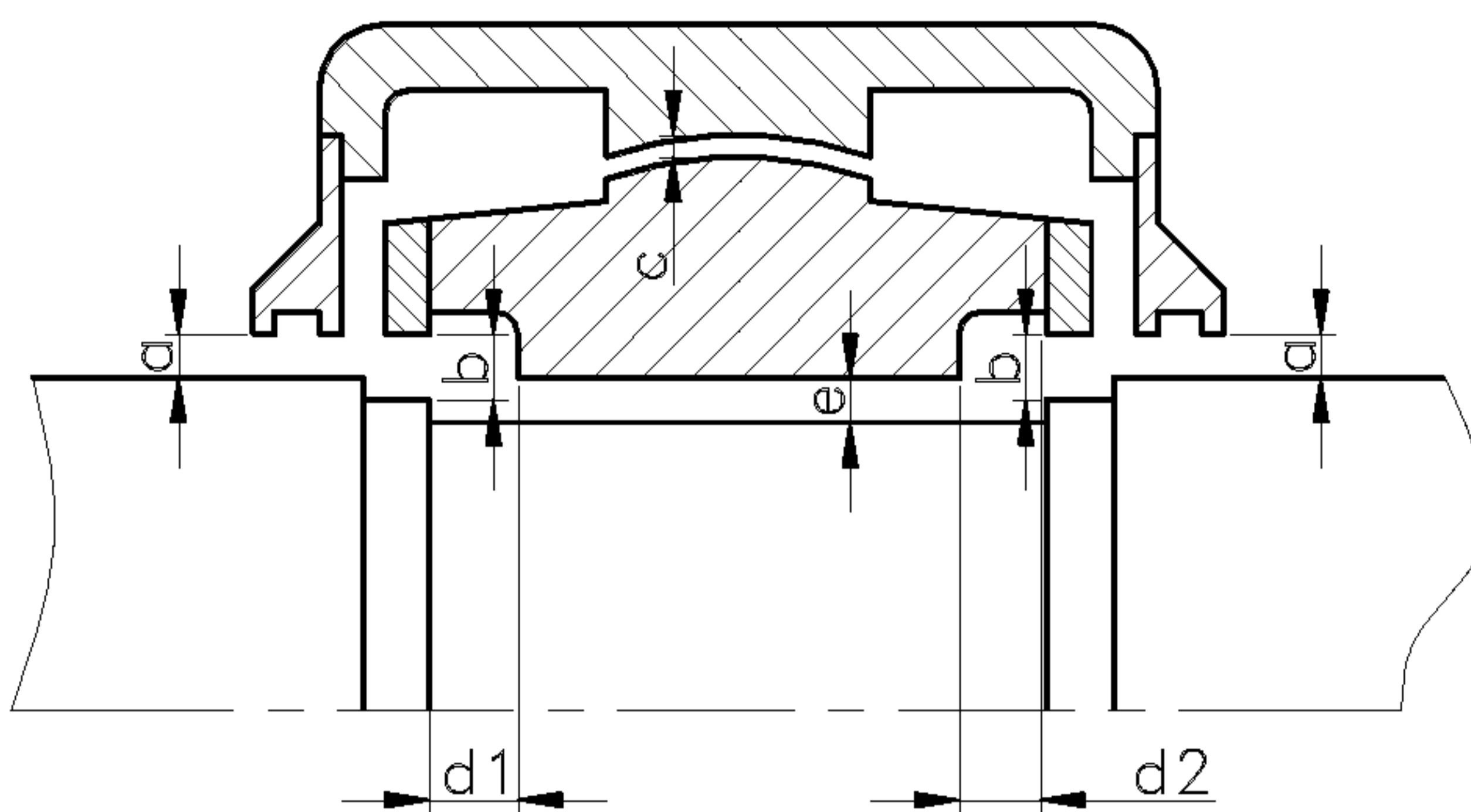
Рисунок 8.8 – Подшипник ротора генератора Т-32 и Т-25-2
