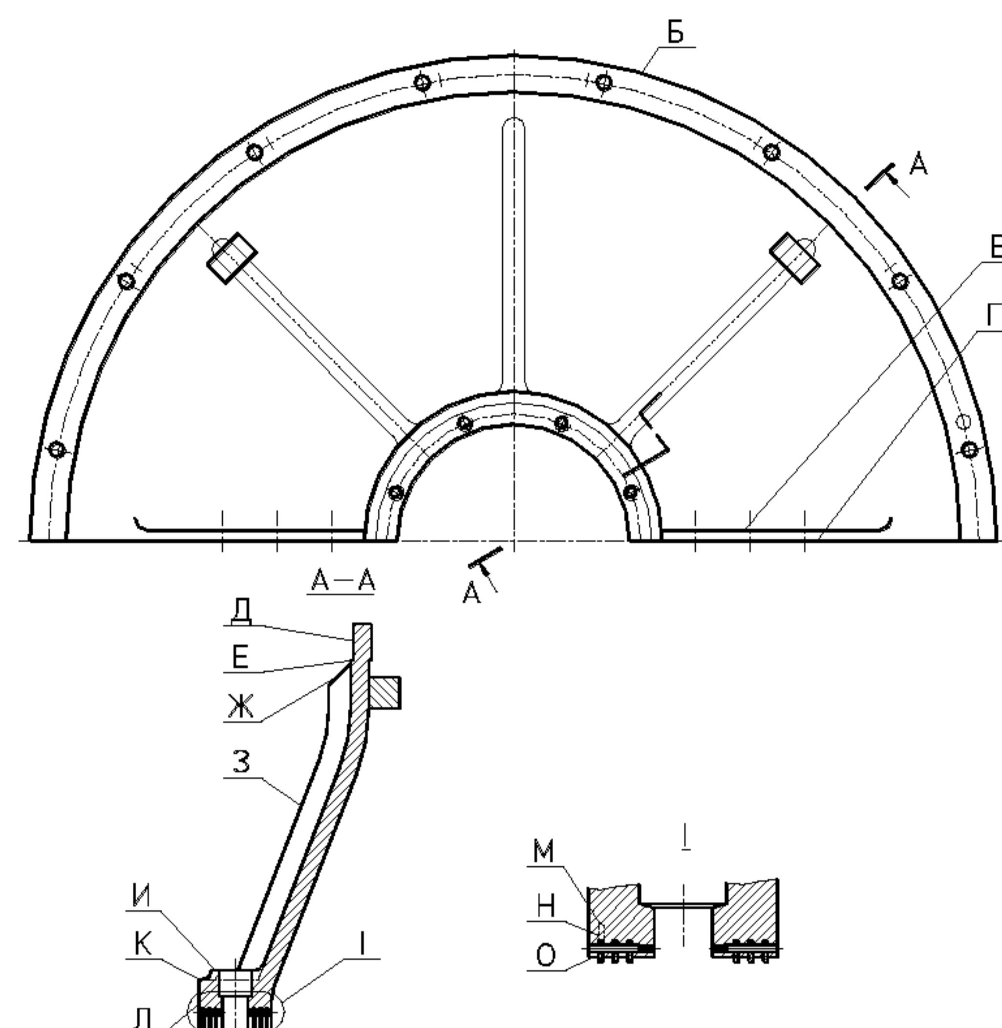
Уплотнение турбогенератора ТС–20
