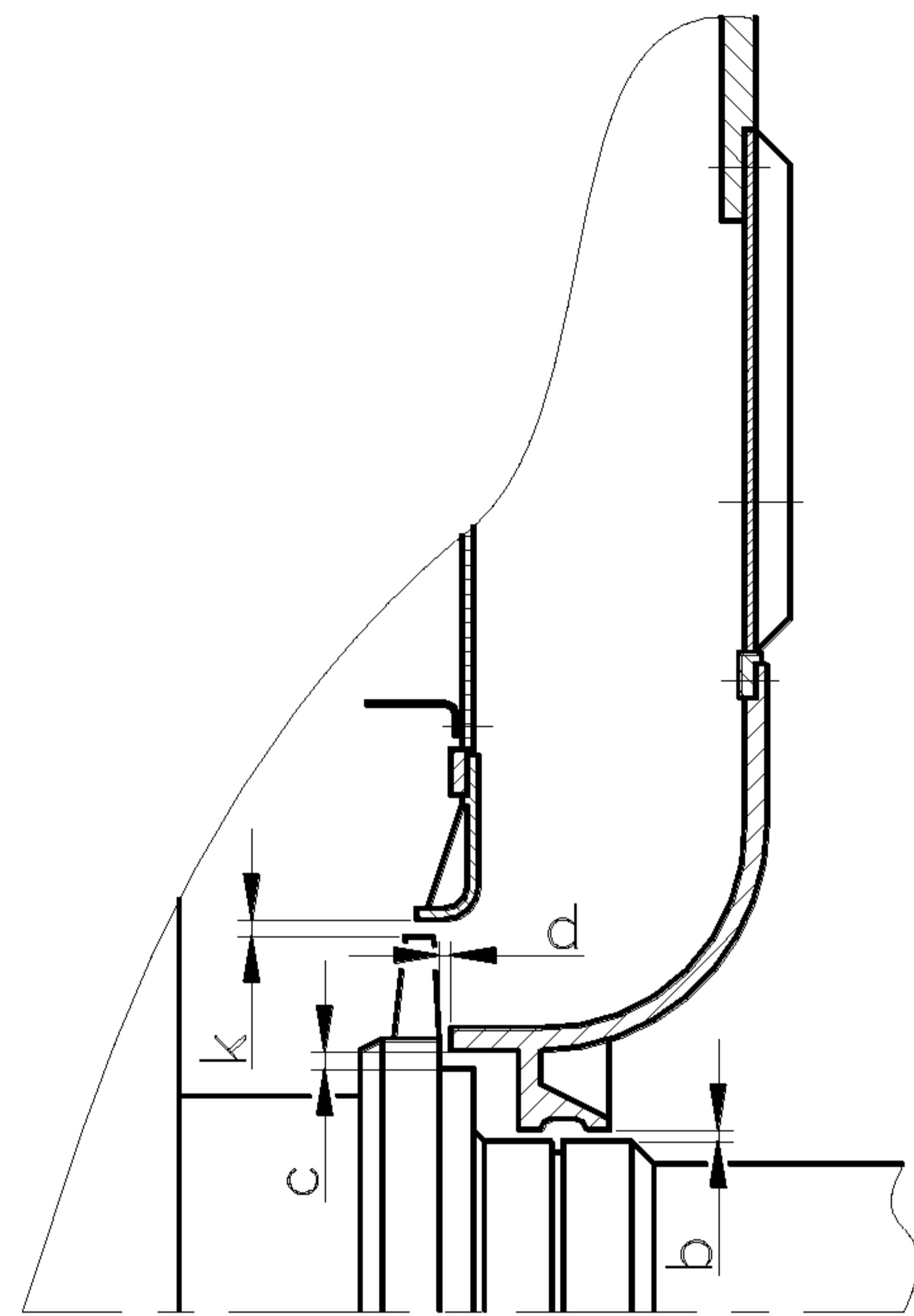
Рисунок 8.2 – Установка вентилятора (сторона возбудителя)
