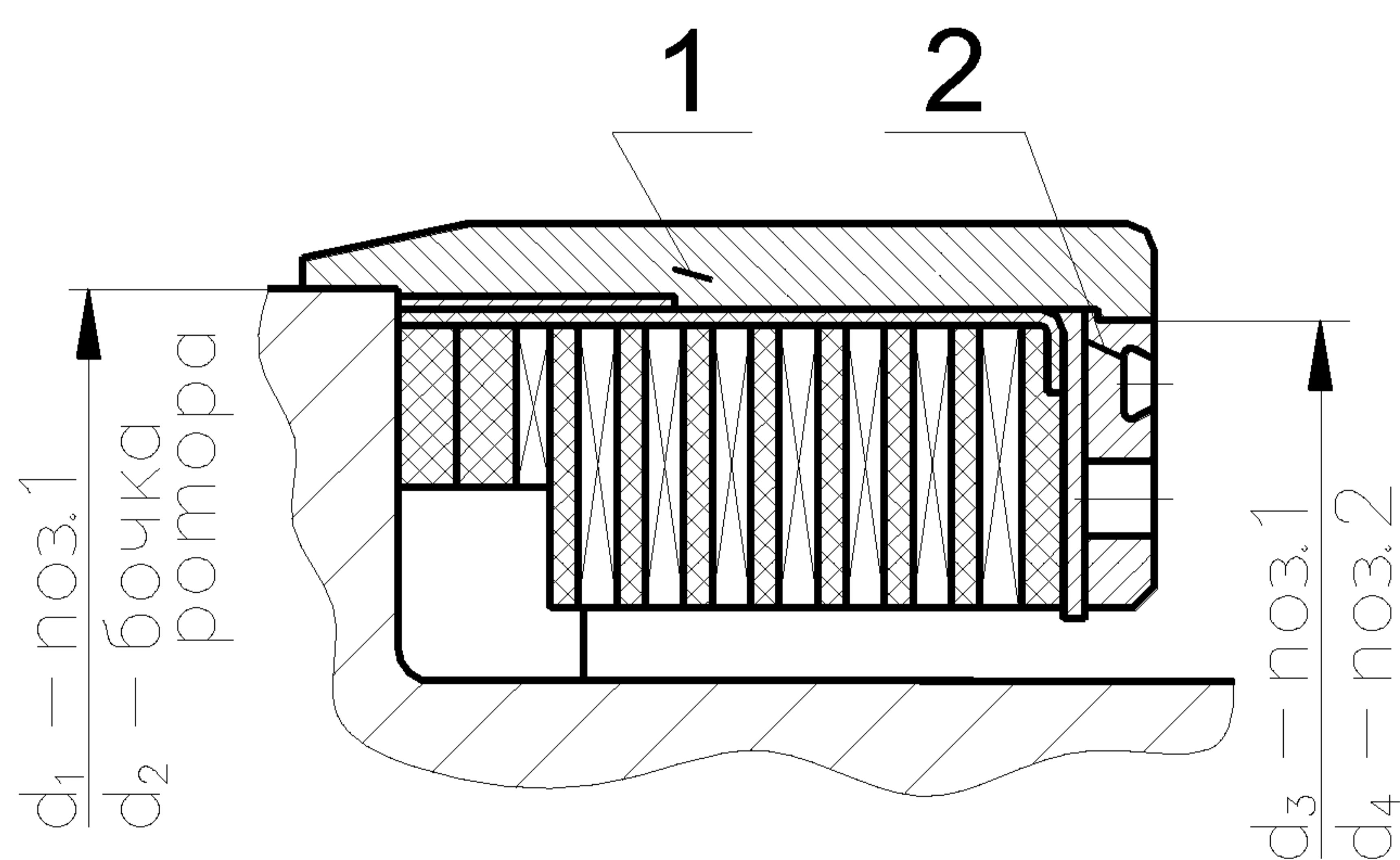
Рисунок 7.2б – Бандажный узел ротора турбогенератора Т–25–2
