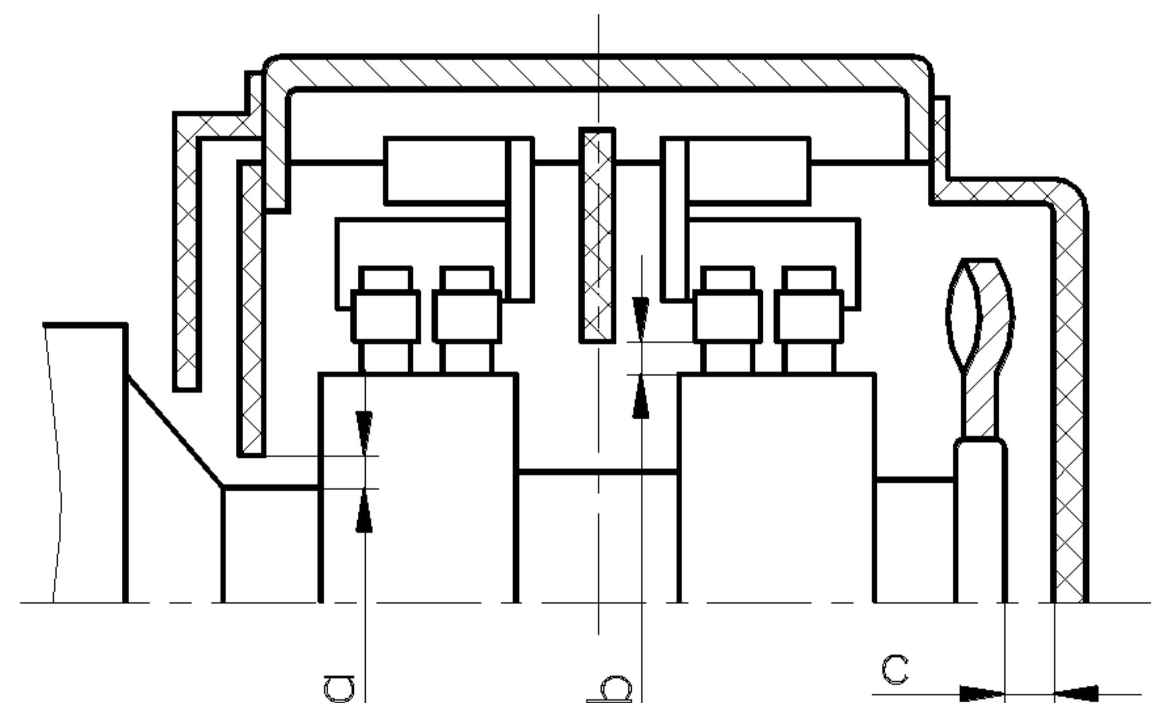
Рисунок 8.7 – Установка траверсы турбогенератора Т–32
