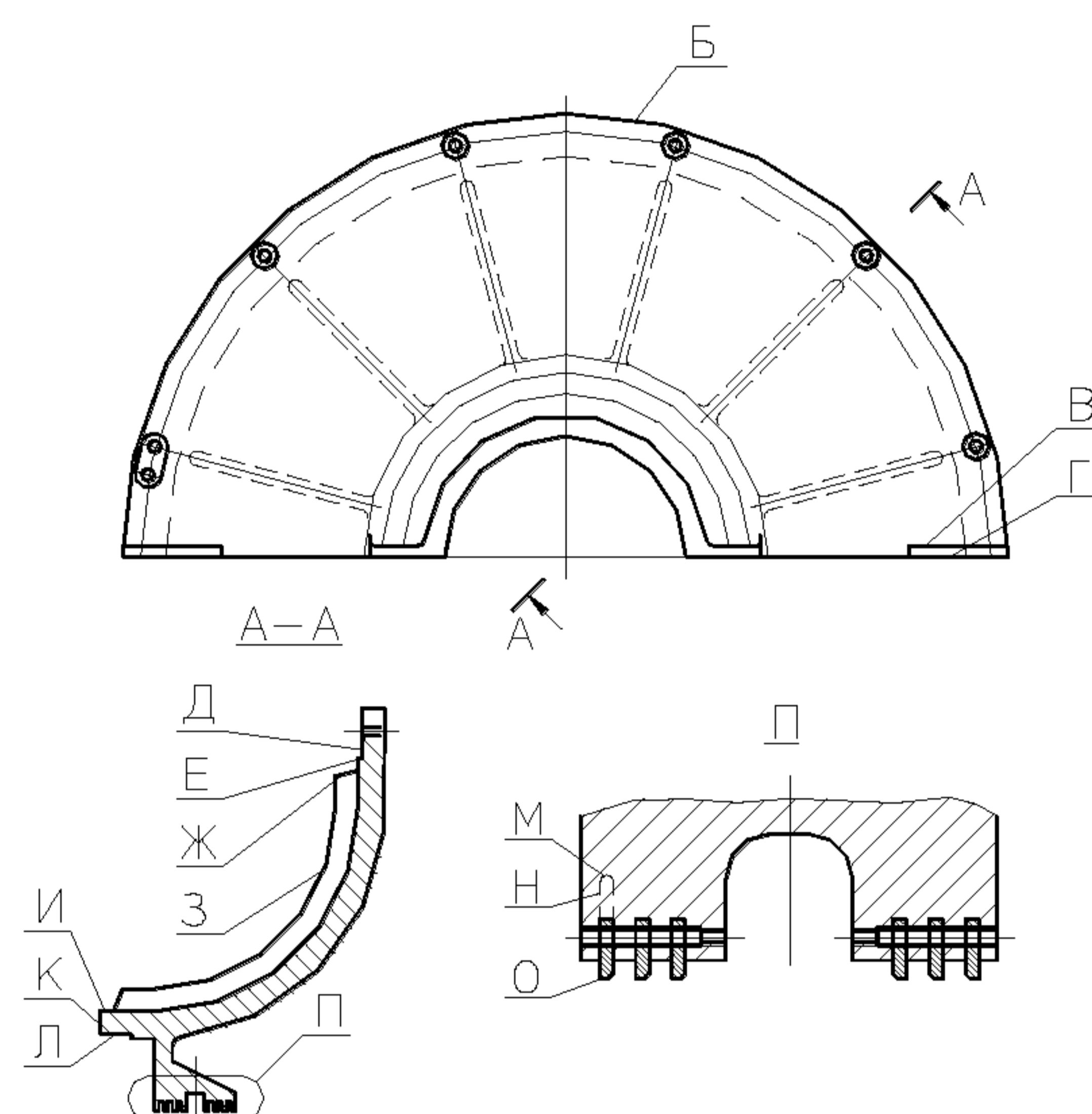
Уплотнение турбогенератора Т–25–2
