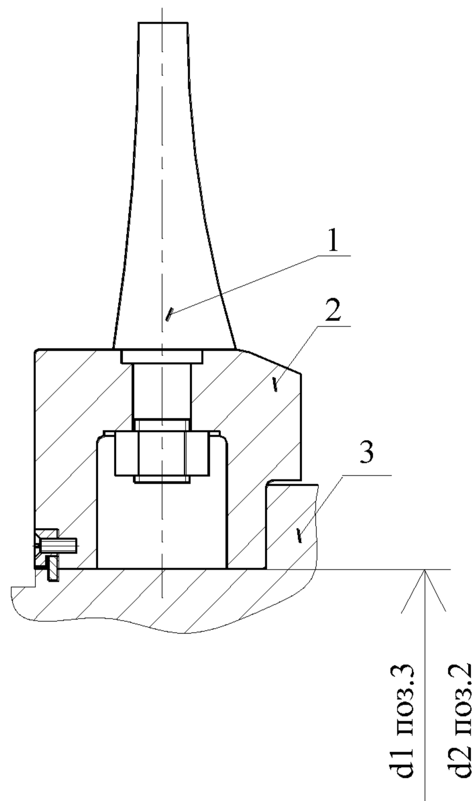
1 – лопатка вентилятора , 2 – втулка вентилятора, 3 – вал ротора.
