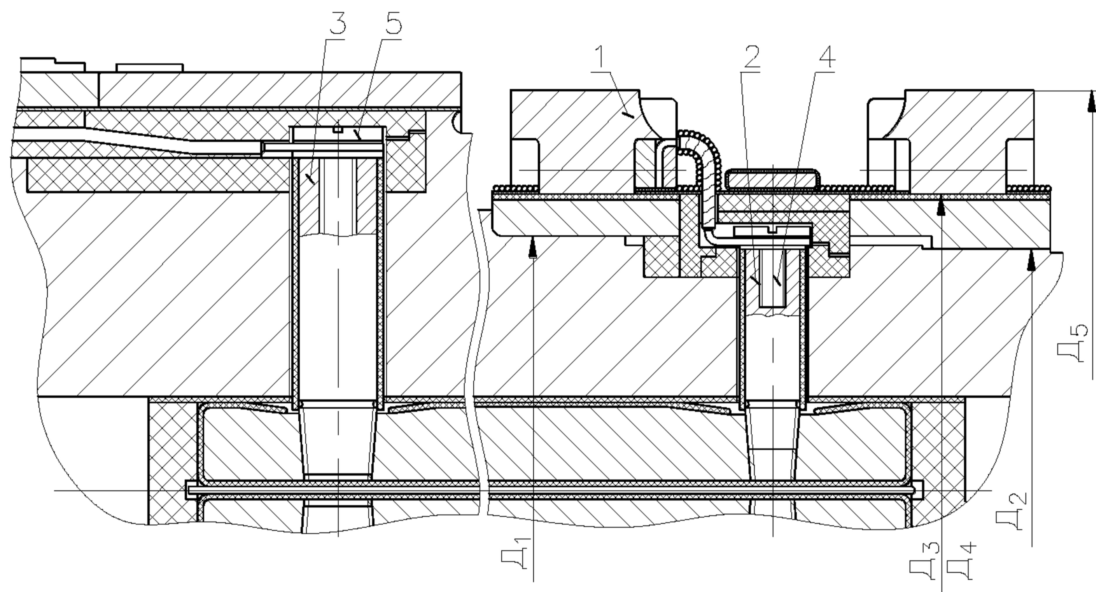
1 – контактные кольца; 2,3 – токоведущий болт; 4,5 – контактный винт.
