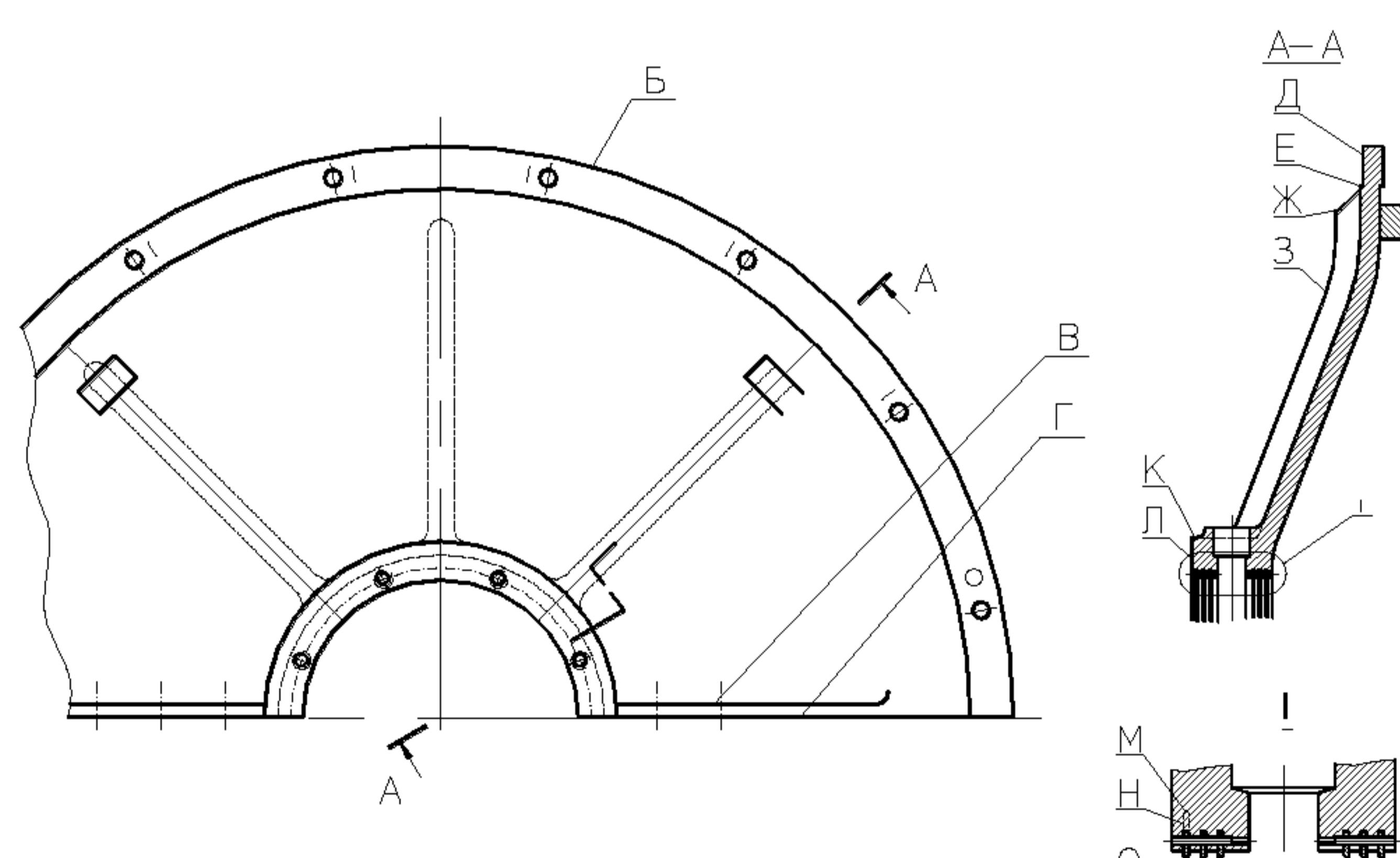
Уплотнение турбогенератора Т–32
