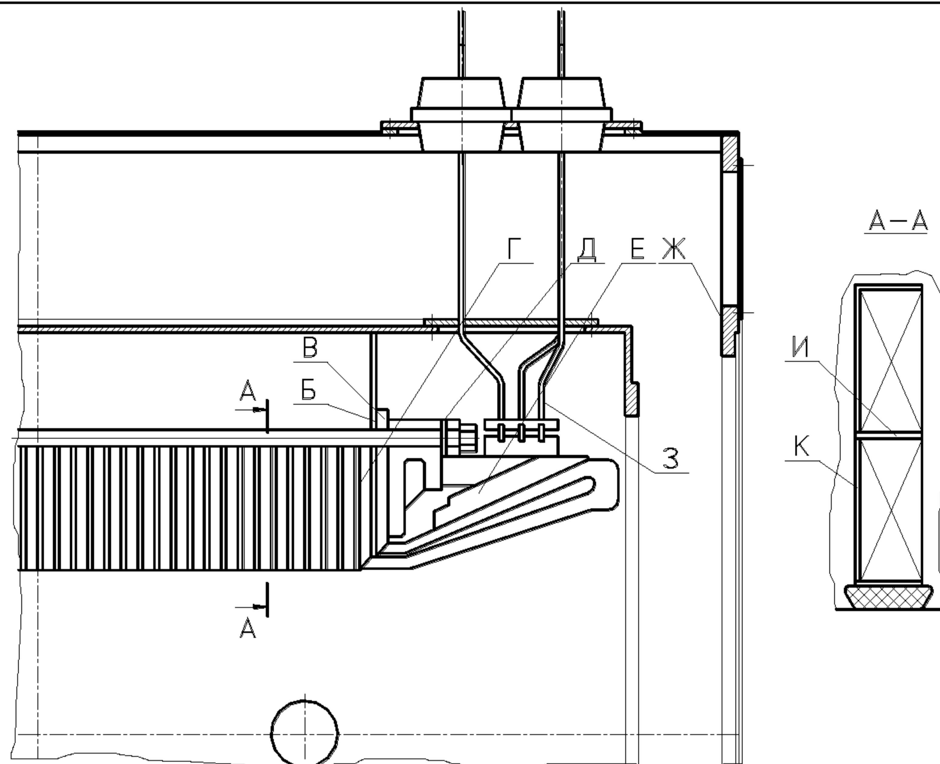
Статор турбогенератора ТС-20
