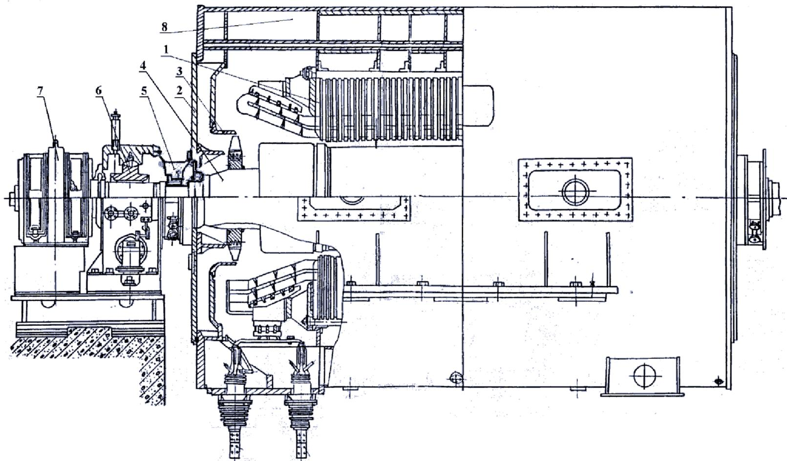
1 – статор; 2 – щит наружный; 3 – обтекатель; 4 – ротор; 5 – уплотнение вала ротора; 6 – подшипник опорный; 7 – щеточный аппарат; 8 – газоохладитель
