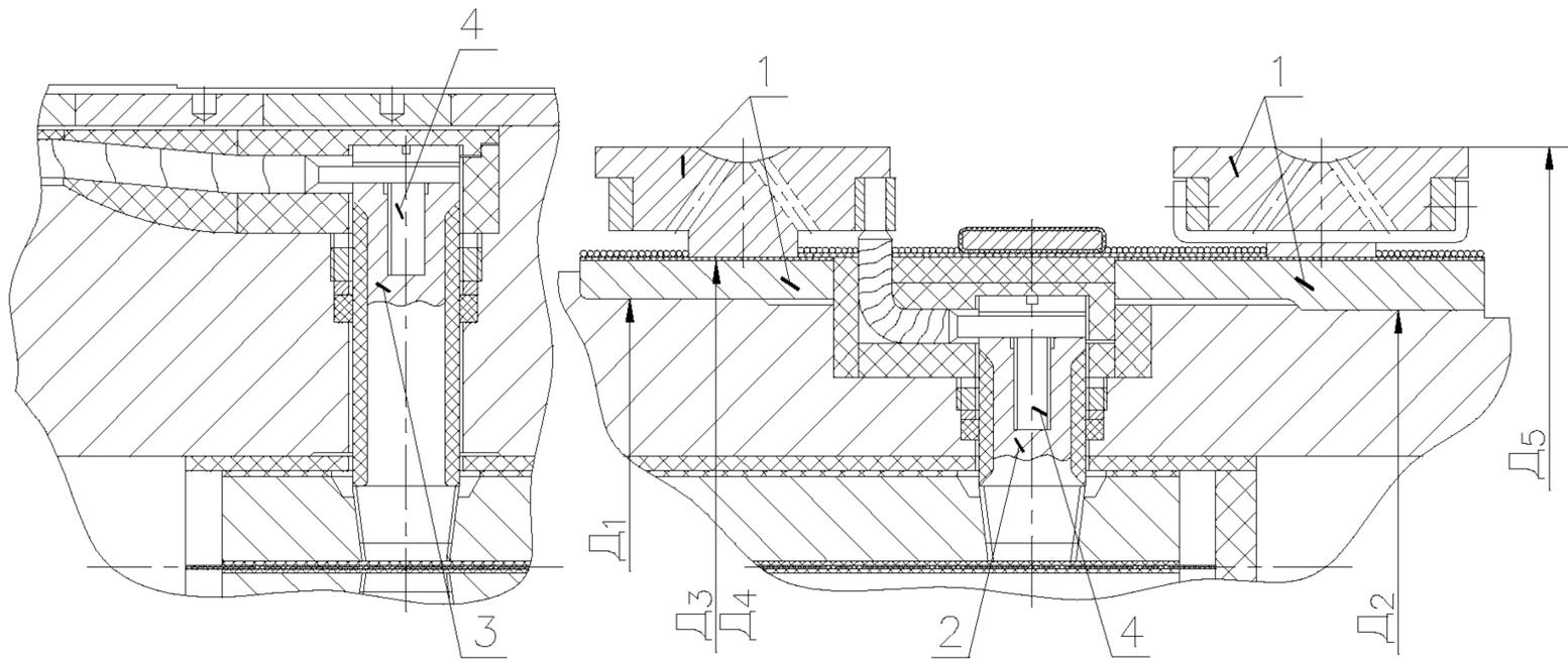
1 – контактное кольцо; 2, 3 – токоведущий болт; 4 – контактный винт.
