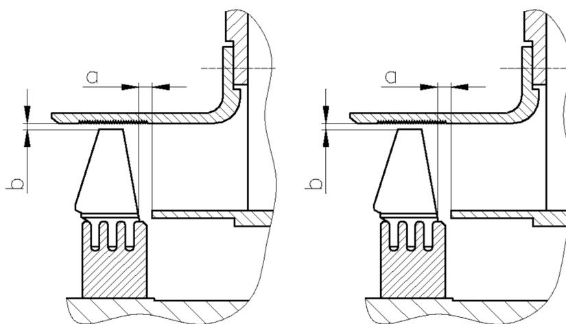
Рисунок 8.2. – Зазор между вентилятором и обтекателем
