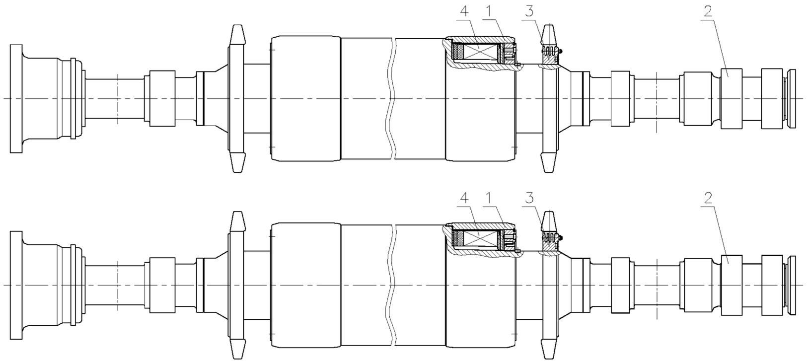
1 –бандажный узел; 2 – контактные кольца с токоподводом; 3 – вентилятор, 4 - обмотка ротора.
