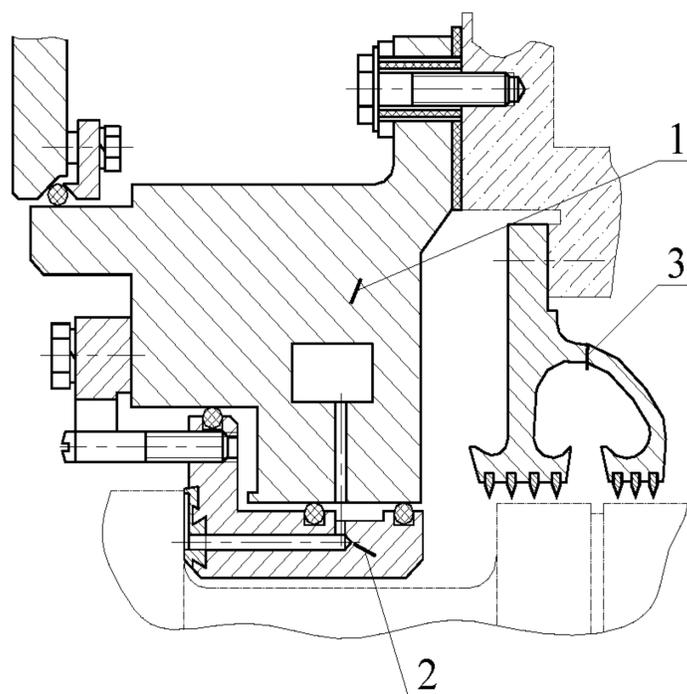
1 – корпус уплотнения; 2 – вкладыш уплотнения; 3 – маслоуловитель;
