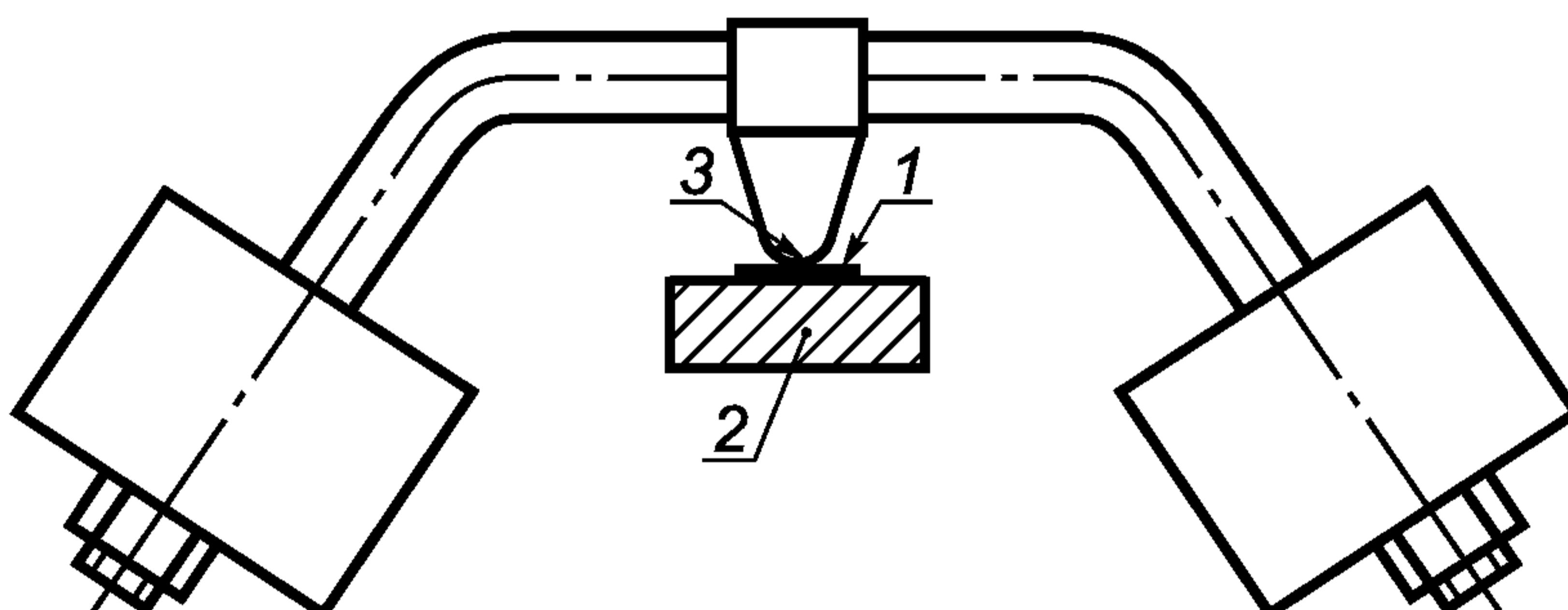
1 — образец; 2 — опора; 3 — сферический радиус  $R = 2,5$  мм
