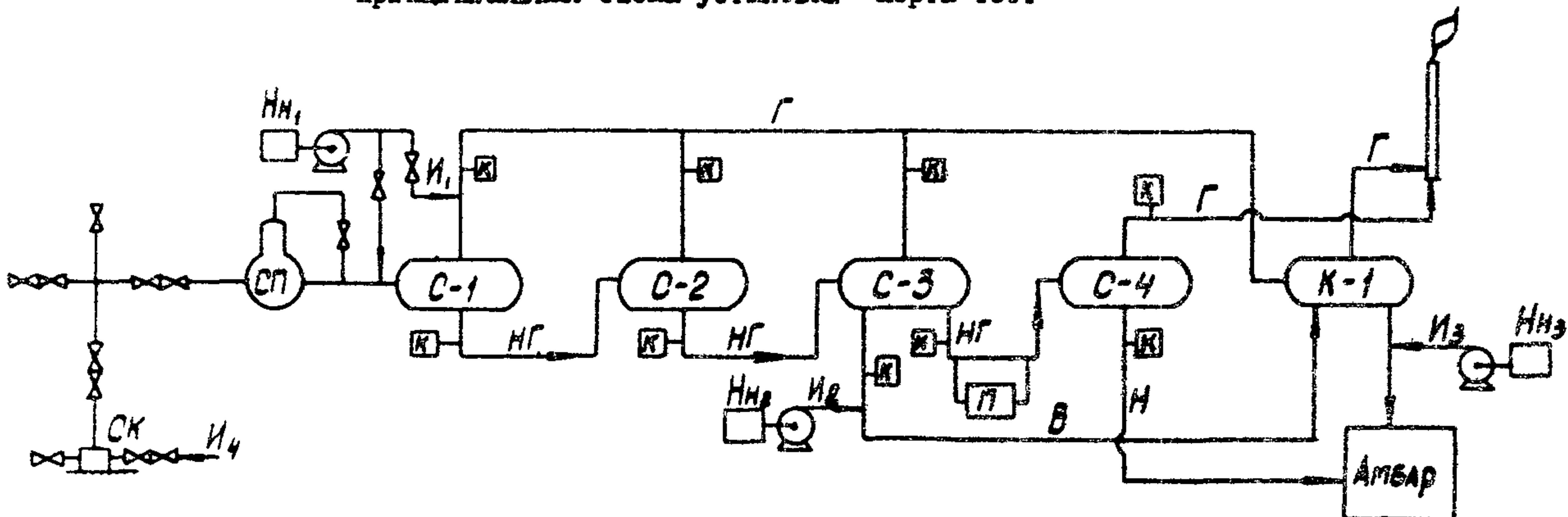
СП - сепаратор песка; С-1-4 - сепараторы нефти; К-1 - газоотделитель;
